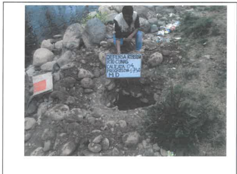
FOTO. 12.-PERFIL ESTRATIGRAFICO DE CALICATA. C-4 PROG, 1+750 . INFLUENCIA DE LOS MUROS DE GAVIONES O MUROS DE CONCRETO EN LAS DEFENSAS RIBEREÑAS DEL RIO CUNAS CHUPACA, 2020
