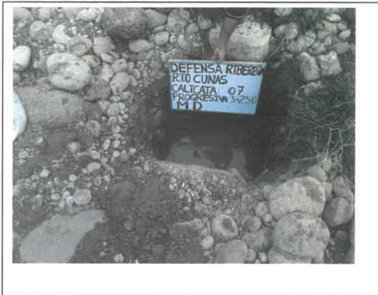
FOTO- 22.- PERFIL ESTRATIGRAFICO DE CALICATA. C-7, PROG, 3 + 250 . INFLUENCIA DE LOS MUROS DE GAVIONES O MUROS DE CONCRETO EN LAS DEFENSAS RIBEREÑAS DEL RIO CUNAS CHUPACA, 2020
