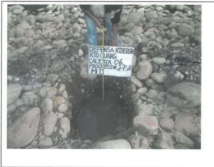
" FOTO. 19.-PROFUNDIDAD DE CALICATA, C-6 , PROG, 2+750 , . INFLUENCIA DE LOS MUROS DE GAVIONES O MUROS DE CONCRETO EN LAS DEFENSAS RIBEREÑAS DEL RIO CUNAS CHUPACA, 2020
