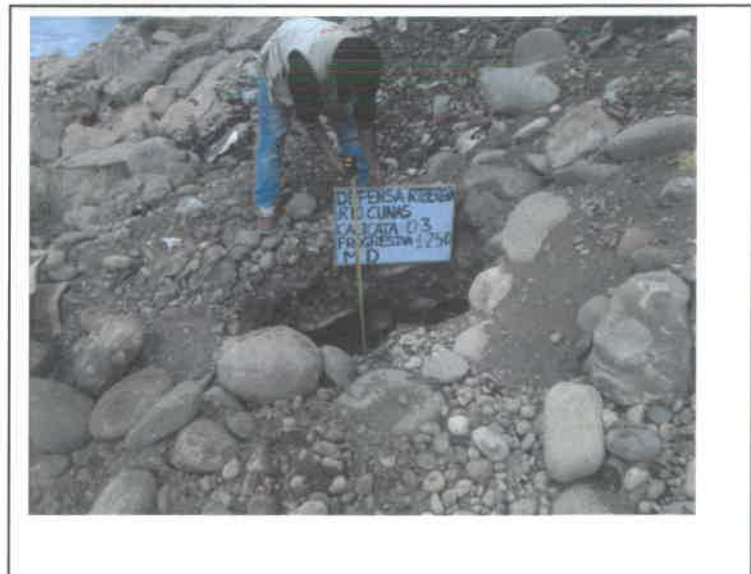
FOTO. 09.-PERFIL ESTRATIGRAFICO DE CALICATA .C- 3 PROG, 1 + 250. INFLUENCIA DE LOS MUROS DE GAVIONES O MUROS DE CONCRETO EN LAS DEFENSAS RIBEREÑAS DEL RIO CUNAS CHUPACA, 2020
