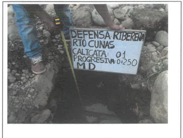
FOTO.04.- PROFUNDIDAD DE EXCAVACION. DE C-1 PROG, 0 +250. INFLUENCIA DE LOS MUROS DE GAVIONES O MUROS DE CONCRETO EN LAS DEFENSAS RIBEREÑAS DEL RIO CUNAS CHUPACA, 2020
