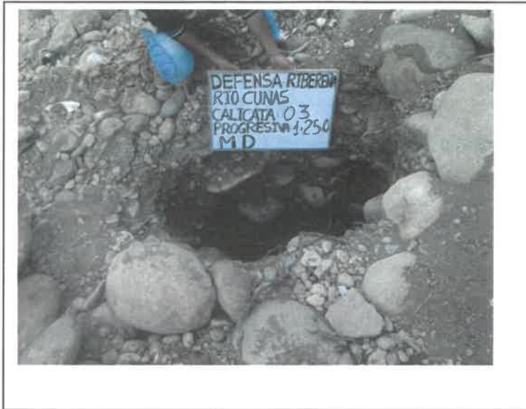
FOTO. 09.-PERFIL ESTRATIGRAFICO DE CALICATA .C- 3 PROG, 1 + 250. INFLUENCIA DE LOS MUROS DE GAVIONES O MUROS DE CONCRETO EN LAS DEFENSAS RIBEREÑAS DEL RIO CUNAS CHUPACA, 2020
