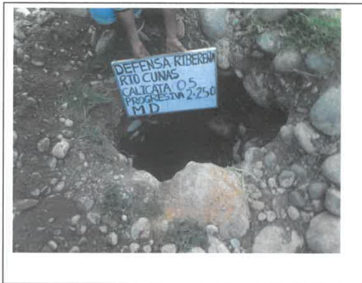
FOTO. 15.-PERFIL ESTRATIGRAFICO DE LA CALICATA. C- 5, PROG, 2+250, . INFLUENCIA DE LOS MUROS DE GAVIONES O MUROS DE CONCRETO EN LAS DEFENSAS RIBEREÑAS DEL RIO CUNAS CHUPACA, 2020
