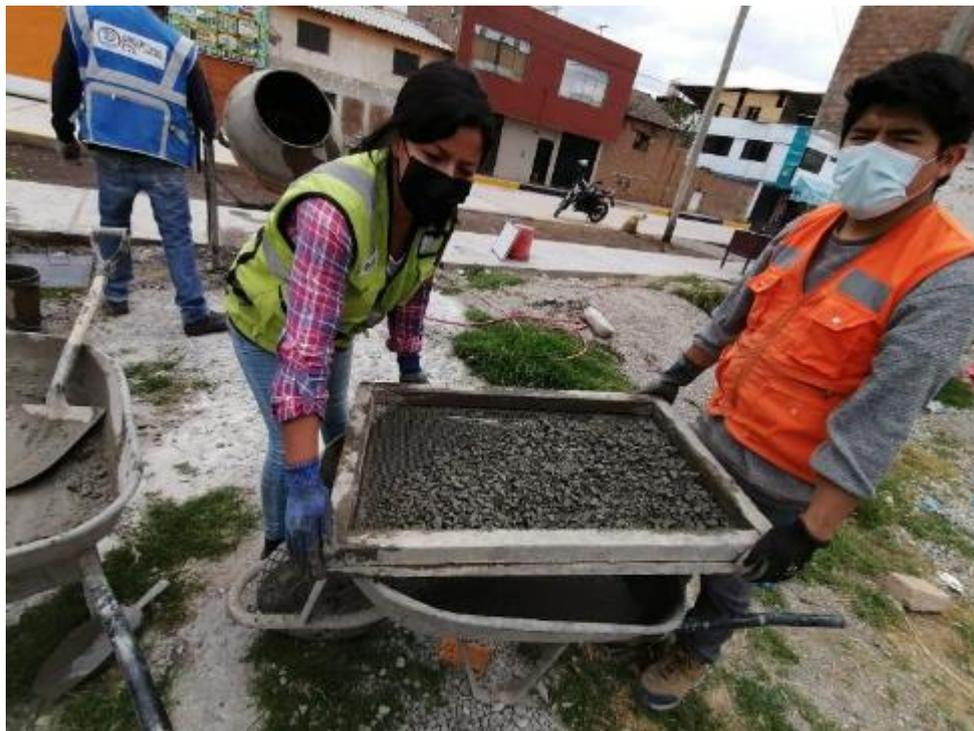
**Fotografía 06:** Se puede visualizar en la imagen el preparado de muestra para el ensayo de tiempo de fragua del concreto.
