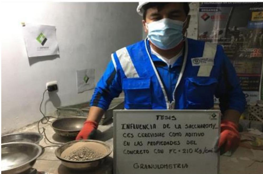
**Fotografía 02:** Se puede apreciar el proceso de caracterización de los agregados, se inició con el análisis granulométrico del agregado fino y grueso, cumpliendo con la norma NTP 400.012.
