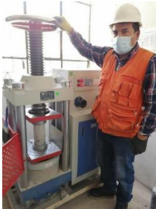
*Nota.* La figura muestra el proceso de asegurado del testigo en la prensa hidráulica.
