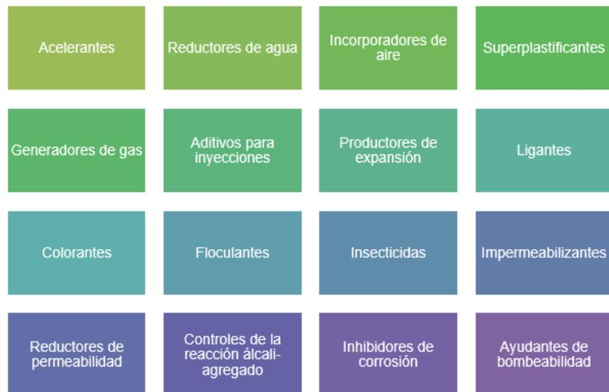
*Nota.* La figura muestra la clasificación de los aditivos del concreto según ACI 212.1R. Fuente: Instituto Americano del Concreto, 2000.
