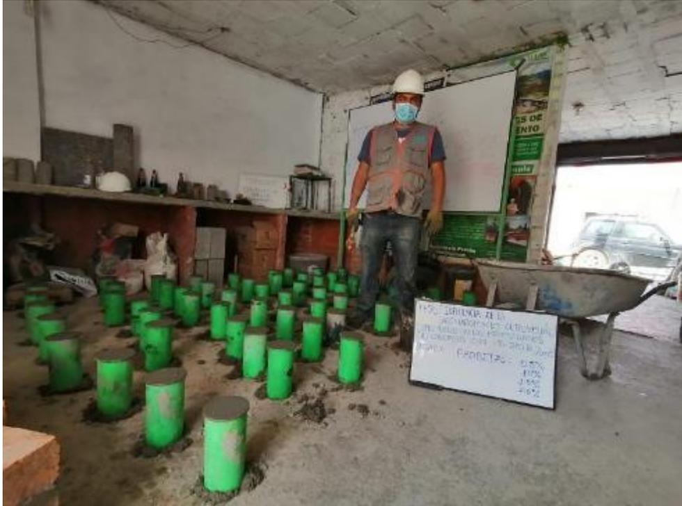
**Fotografía 05:** Proceso de elaboración de los testigos de concreto para ser ensayos en resistencia a la compresión del concreto.
