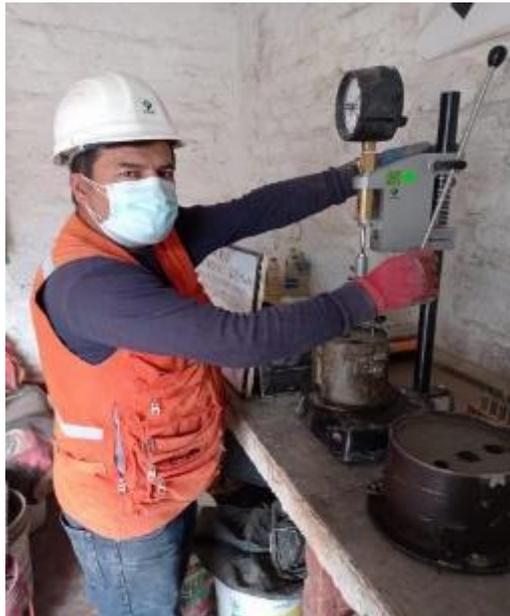
*Nota.* La figura muestra el proceso de ensayo de tiempo de fragua del concreto con dosis 1.5% de *Saccharomyces cerevisiae*.
