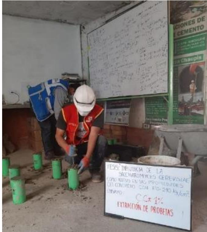
*Nota.* La figura muestra el proceso de testigos de concreto en moldes de 4"x8". Fuente: Elaboración propia, 2021.
