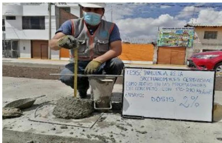
*Nota.* La figura muestra la medición del asentamiento del concreto empleando una dosis del 2% del aditivo (Saccharomyces cerevisiae).
