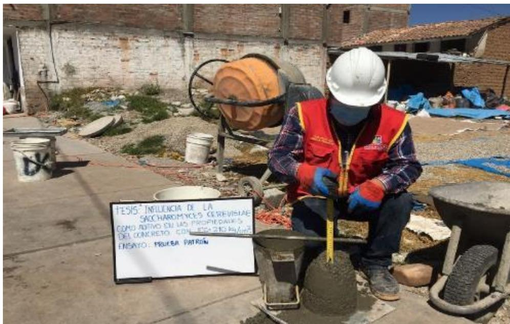
**Fotografía 10:** En la imagen se aprecia el control de asentamiento del concreto el mismo que se realizó en tres oportunidades por cada tipo de diseño de mezcla.
