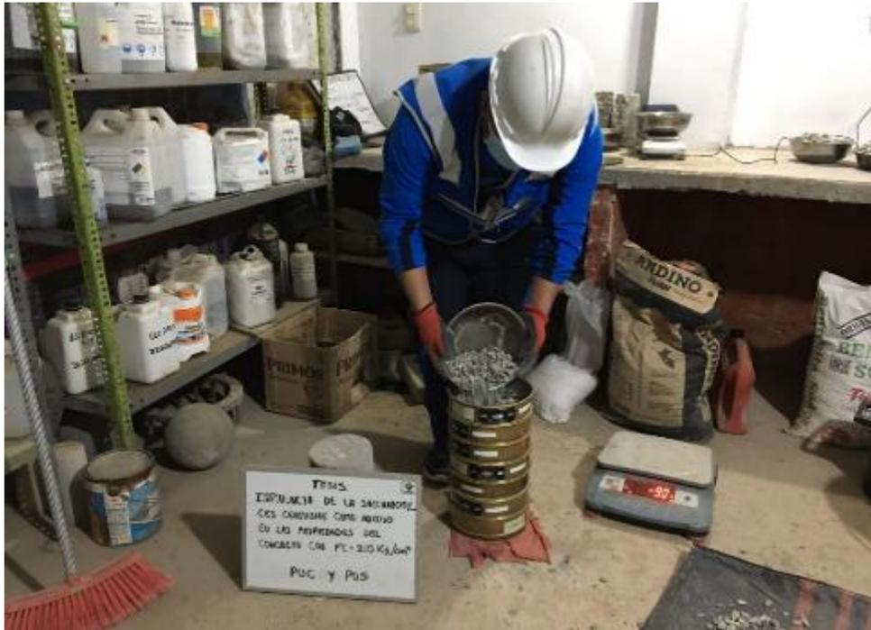
**Fotografía 03:** El método que se empleó para determinar la granulometría de los agregados fue el tamizado manual.
