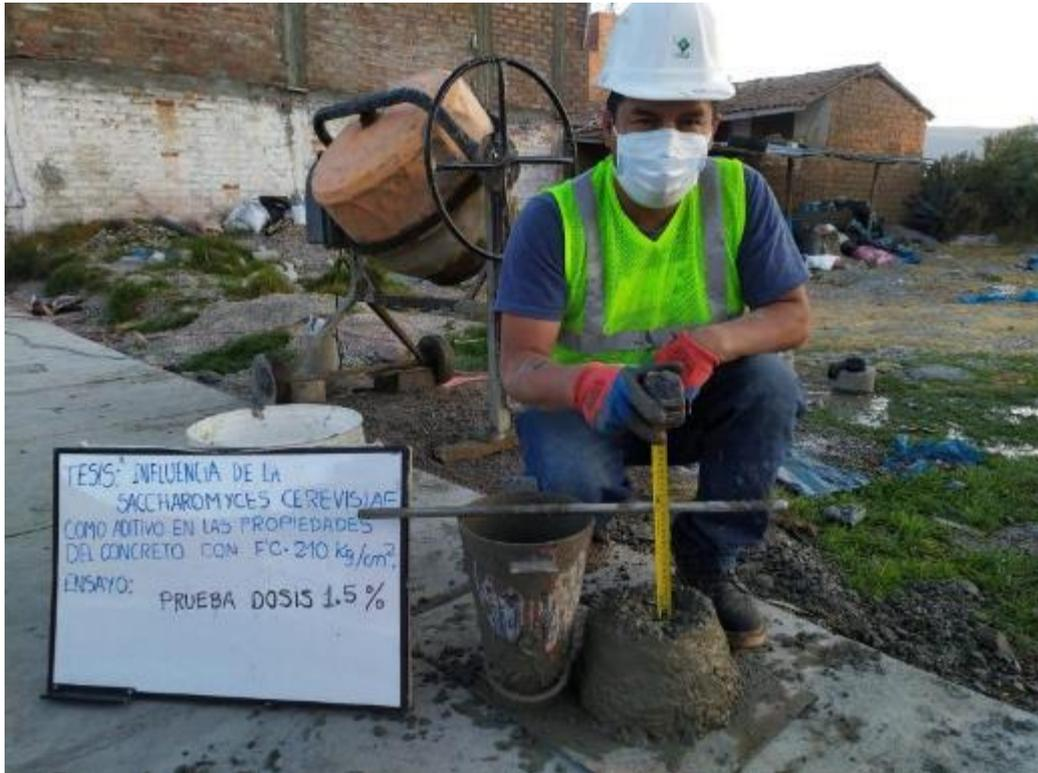
**Fotografía 07:** Ejecución del ensayo de asentamiento del concreto, su realización no debe superar los 150 segundos.
