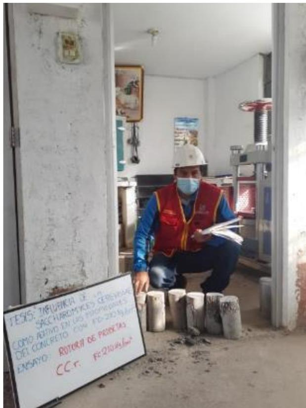
**Fotografía 12:** Se visualiza que el proceso de desarrollo del ensayo de resistencia a la compresión del concreto.
