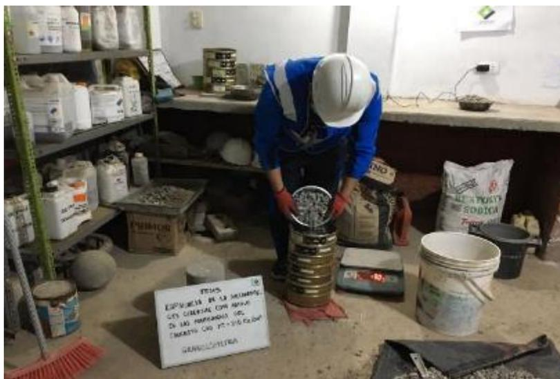
*Nota.* La imagen muestra el proceso de tamizado del agregado grueso.
