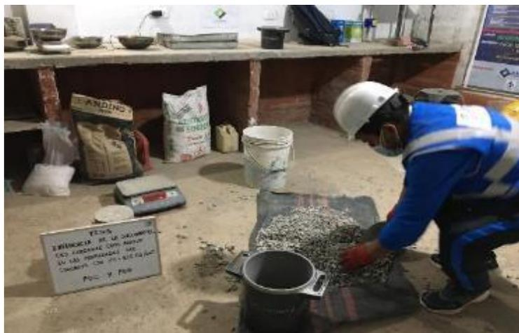
*Nota.* La imagen muestra el proceso de cuarteo del agregado grueso, con el fin de obtener muestra para el ensayo de granulométrico.
