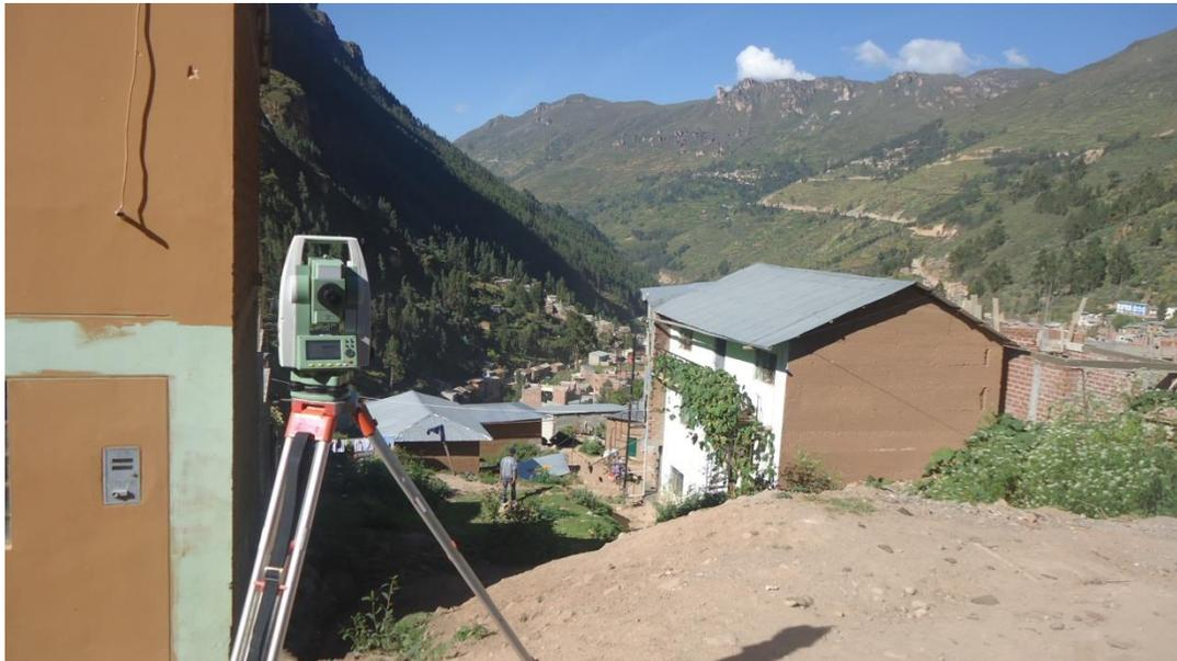
**Fotografía N°2 Estacionamiento del equipo (Estación Total)**
