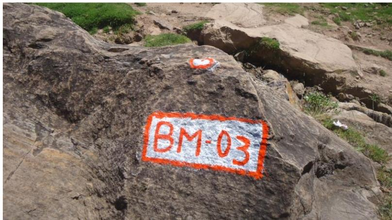
**Fotografía N°3 señalizaciones de los BM de control**
