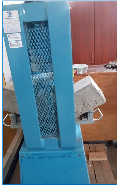
Figura 10: Ensayo de resistencia a la flexión del concreto en vigas simplemente apoyadas con cargas a los tercios
