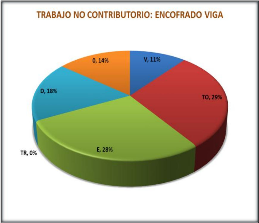
Figura N° 24 Distribución % TNC encofrado viga. Ver A-2.
