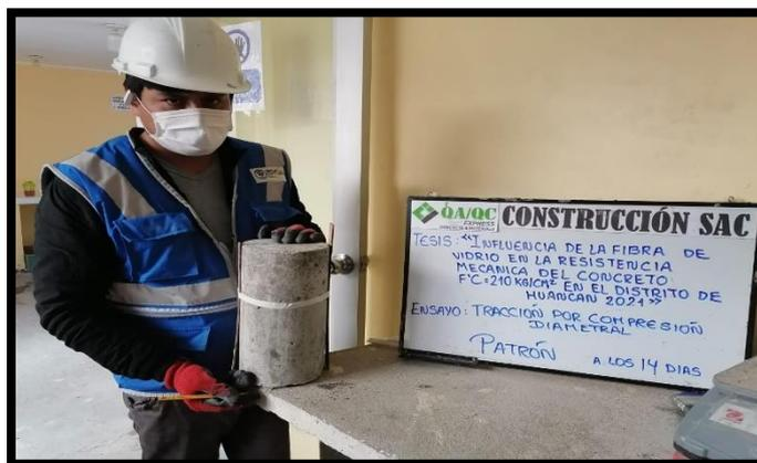
(PGTB), tasa de adición de fibra de vidrio (0% o concreto). Estándar, 0,025%, 0,075% y 0,125%) y la fecha de fabricación y la fecha de la muestra de prueba analizada en el mismo orden.
