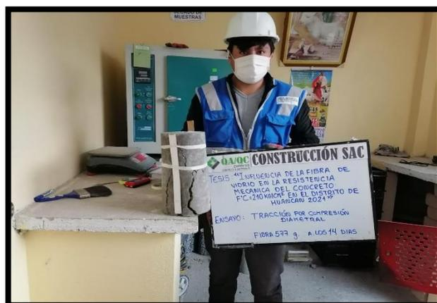
**Fotografía 22 y 23:** se puede apreciar la rotura de probeta por tracción diametral adicionando un 0.025% de fibra de vidrio.
