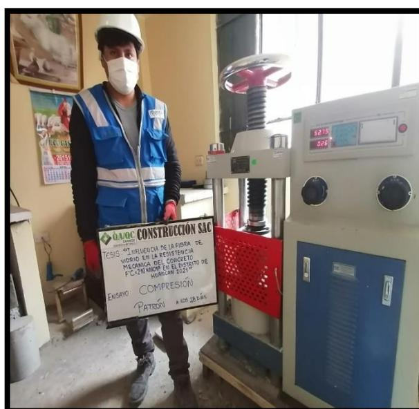
**Fotografía 11, 12 y 13:** se da inicio a la rotura de las probetas por compresión a 7 días, 14 días y 28 días, según la norma NTP 339.034.
