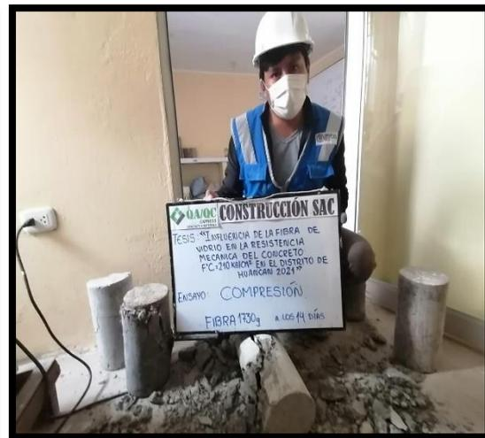
**fotografía 16 y 17:** se puede apreciar la rotura de probetas a compresión a los 14 días con adición de fibra de vidrio en 0.075%.
