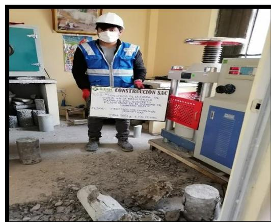
**fotografía 18 y 19:** Se puede apreciar la rotura de probetas a compresión a los 28 días con adición de fibra de vidrio en 0.125%.
