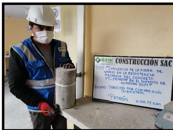
**Fotografía 20 y 21:** Se inicia a la realización del ensayo de rotura a la tracción diametral del ensayo patrón
