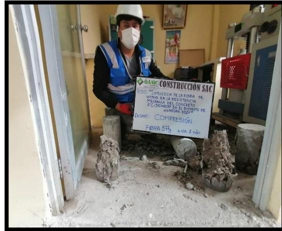
**fotografía 14 y 15:** Se inicia con la rotura de probetas a compresión a los 7 días con adición de fibra de vidrio en 0.025%.
