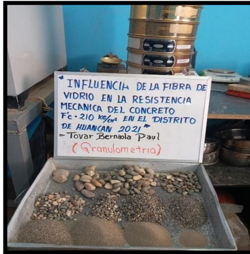
**Fotografía 1:** ensayo de granulometría del agregado fino y grueso de acuerdo a la NTP 400.012
