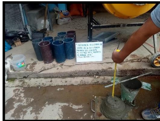
**Fotografía 9 y 10:** se puede ver la comparación del ensayo de Slump realizado del uno no 1.5 pulg de asentamiento y el otro mucho mayor a 1.5 pulg.
