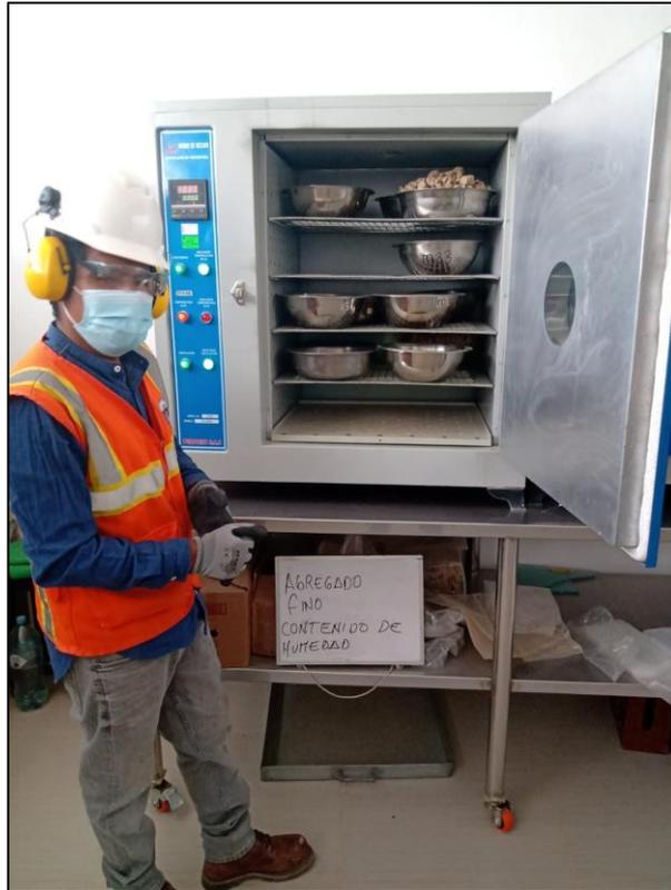
Figura 13. Contenido de humedad - agregado fino
