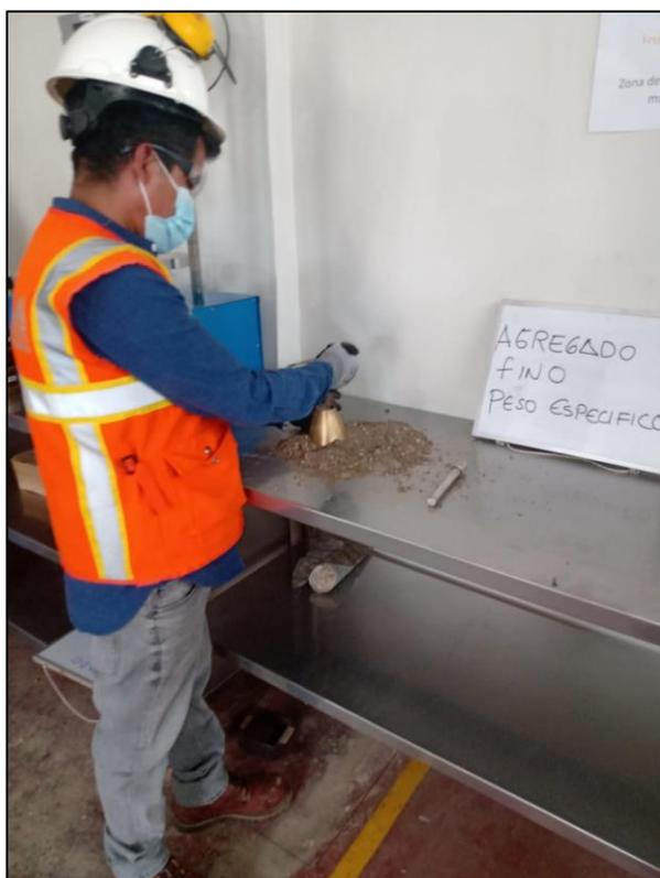
Figura 12. Peso específico - agregado fino
