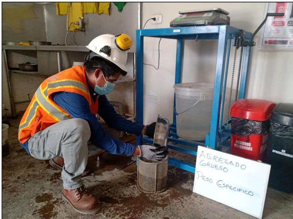
Figura 16. Peso específico - agregado grueso
