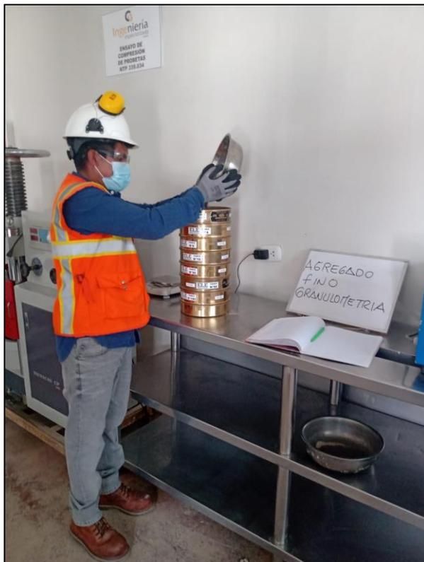
Figura 11. Análisis granulométrico - agregado fino
