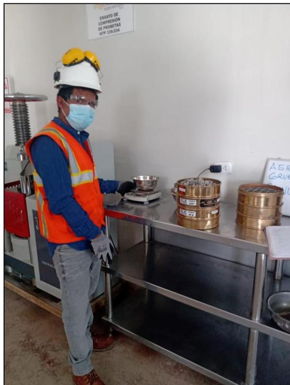
Figura 14. Análisis granulométrico - agregado grueso
