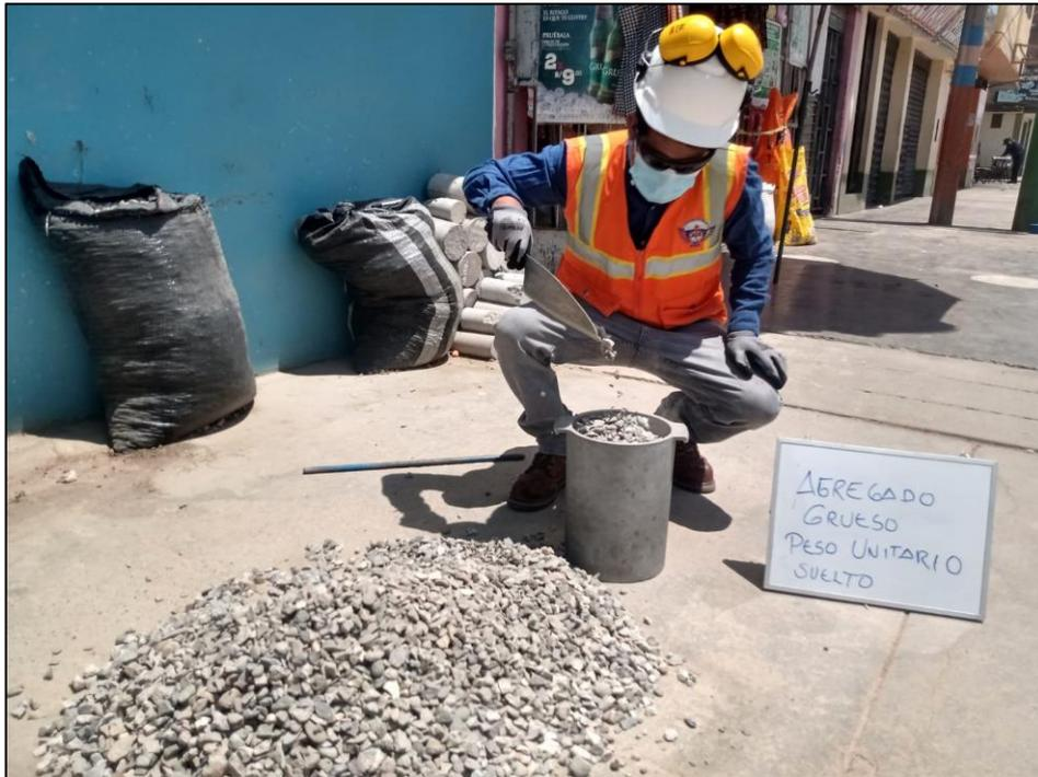
Figura 15. Peso unitario suelto - agregado grueso
