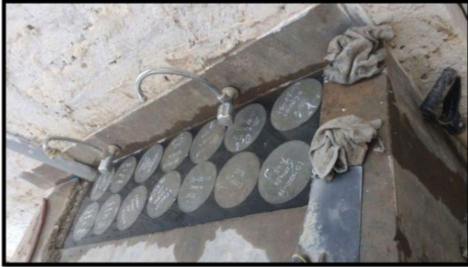
Imagen 3. Curado de los testigos de concreto con resistencias F'c=210 por ambos métodos.
