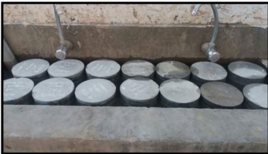
Imagen 4. Curado de los testigos de concreto con resistencias F'c=280 y 350 por ambos métodos.
