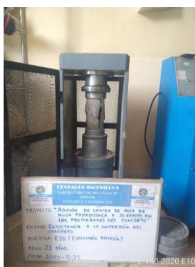
Figura 15. Resistencia a la compresión de especímenes cilíndricos.
