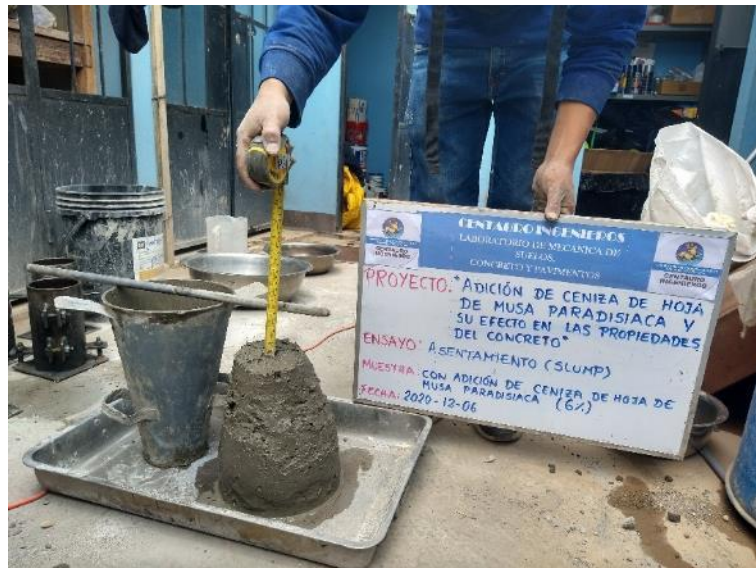
Figura 12. Asentamiento de concreto (slump).
