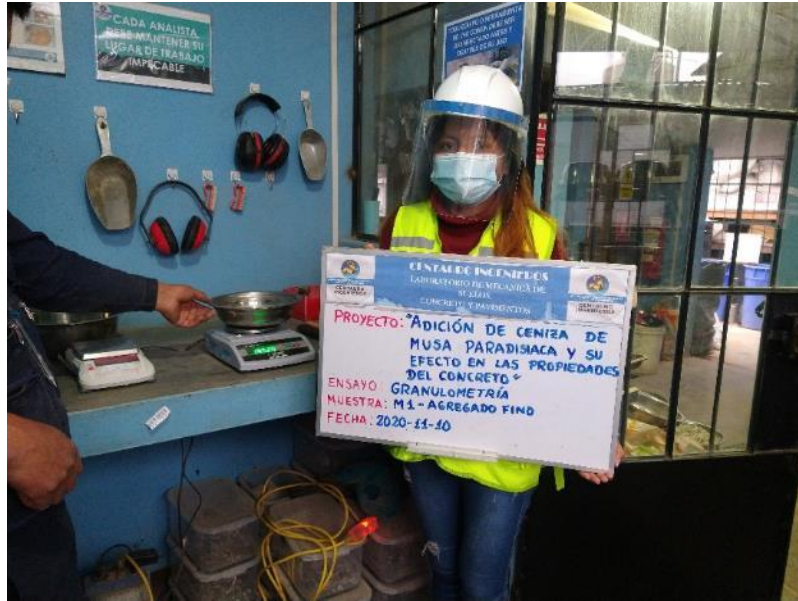
Figura 4. Granulometría de agregado fino.
