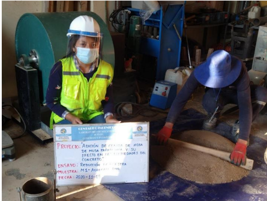
Figura 26. Reducción de la muestra.
