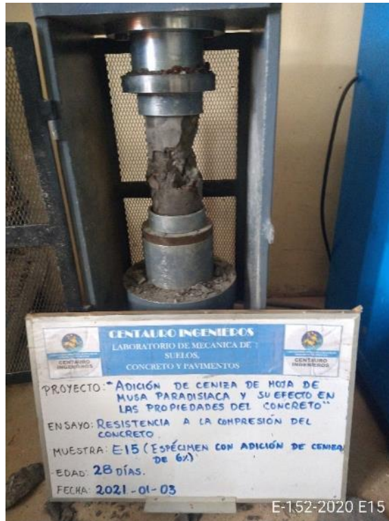
Figura 30. Resistencia a la compresión del espécimen de concreto- Con adición de ceniza de hoja de musa paradisiaca 6% – NTP 339.034.
