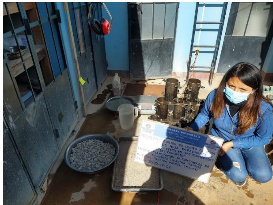
Figura 27. Elaboración de especímenes - MTC E 702.
