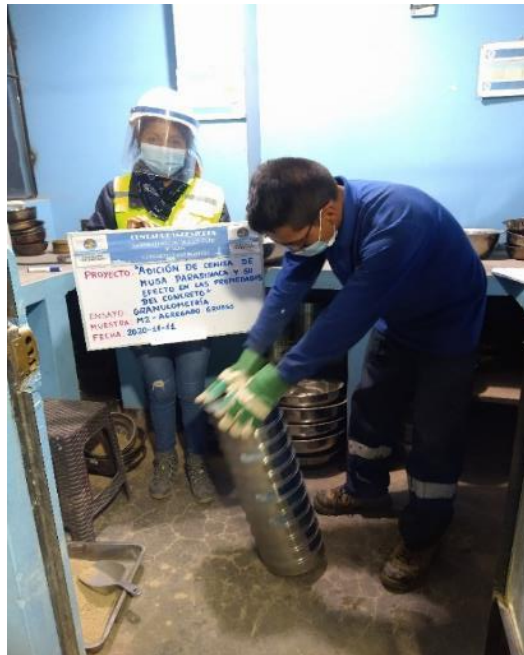
Figura 5. Granulometría de agregado grueso.
