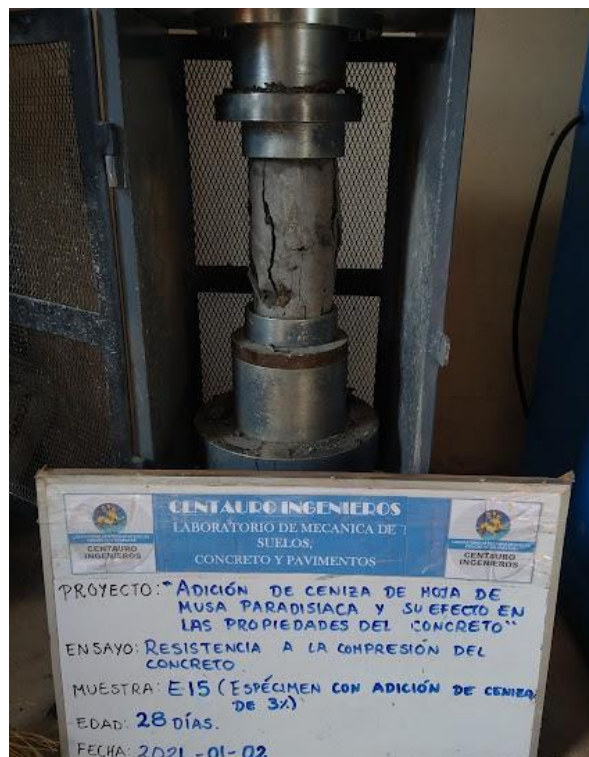
Figura 29. Resistencia a la compresión del espécimen de concreto- Con adición de ceniza de hoja de musa paradisiaca 3% – NTP 339.034.
