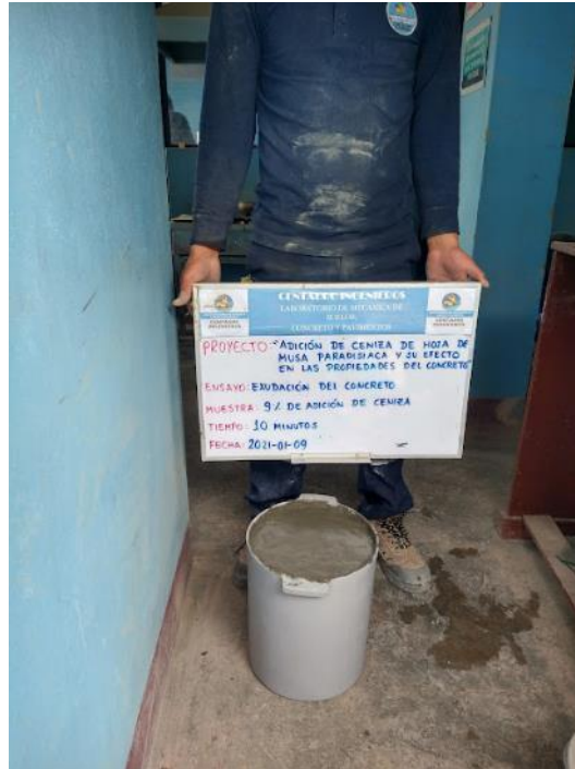
Figura 14. Exudación del concreto.
