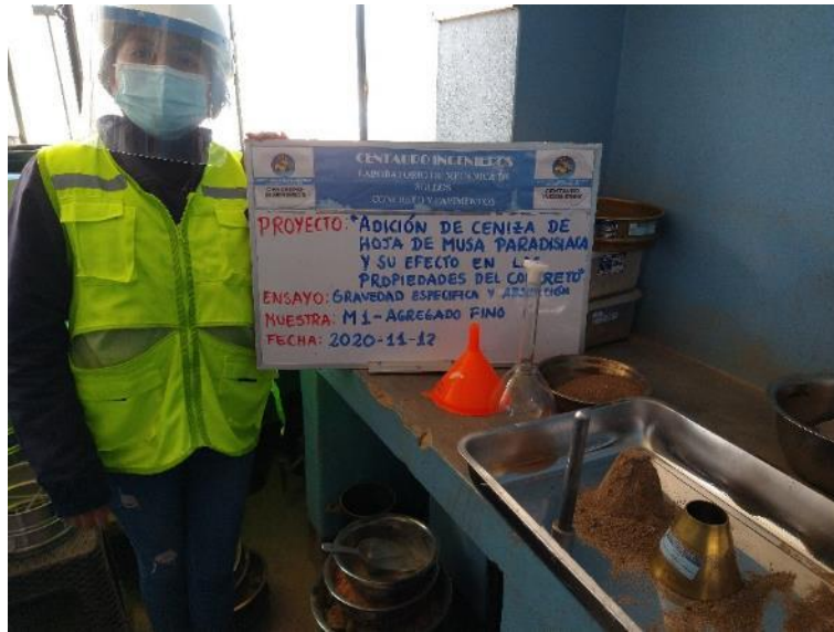
Figura 10. Gravedad específica y absorción de agregado fino.
