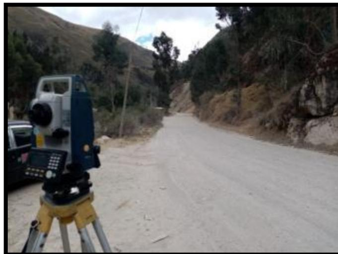
*Figura 34.* Levantamiento Planimétrico en el tramo del km 11+250
