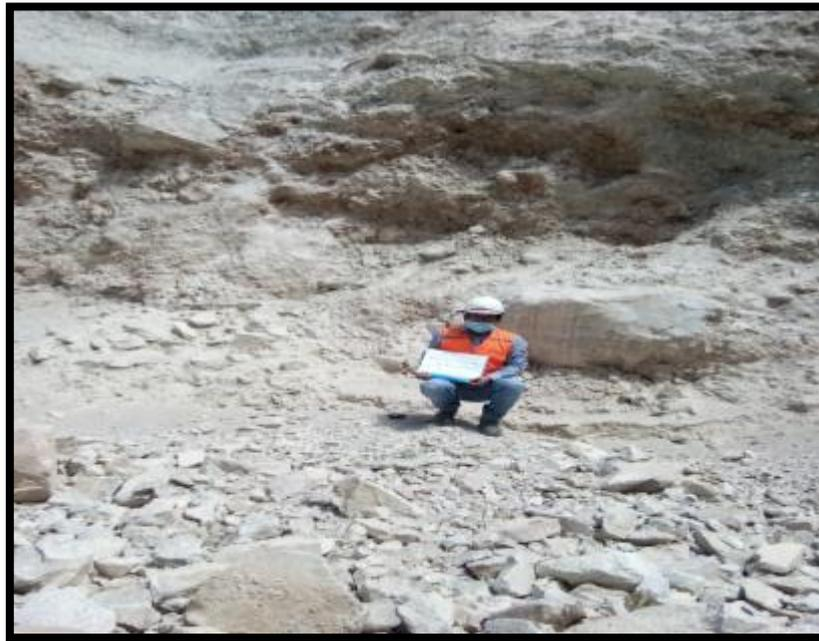
*Figura 44. Perfil Estratigráfico in situ calicata 01*
