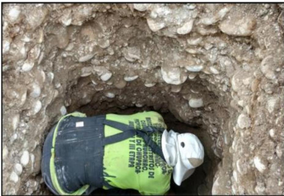
*Figura 41.* Calicata en el Km 11+840 a una Profundidad de 2.00 m
