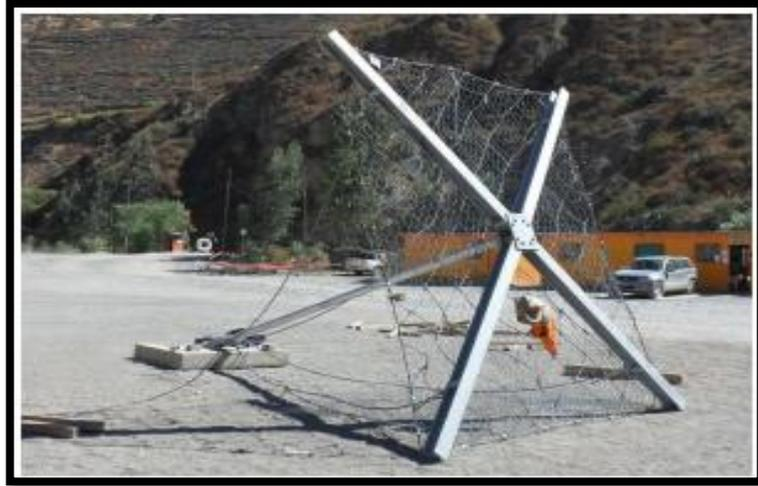
*Figura N° 16* –“Elementos del Sistema Erdox. Tomada de Informe técnico sobres el funcionamiento del sistema”, por Betonform®, 2016, p. 3.
