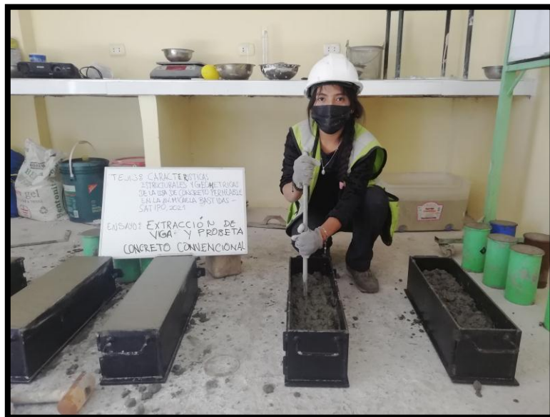
Figura 32 Vaciado del concreto convencional
