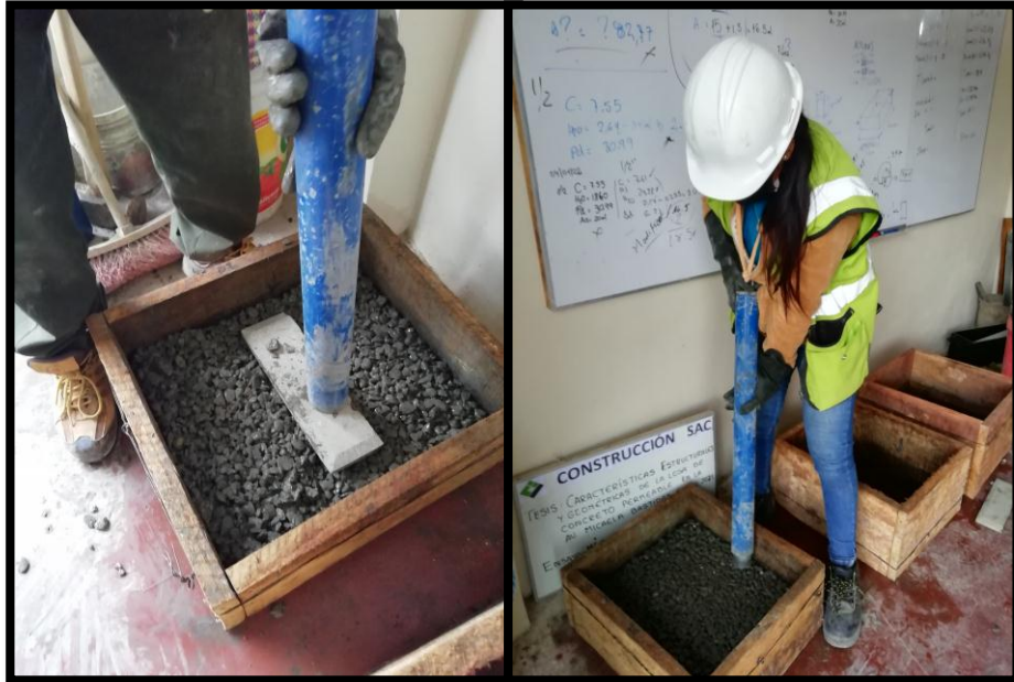
Figura 45 Elaboración de las losas de concreto permeable
