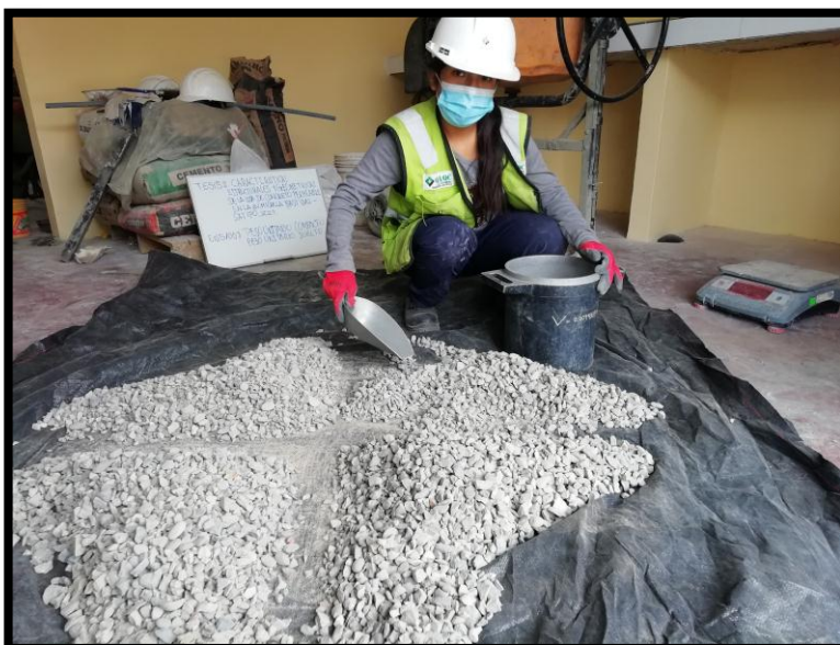
Figura 22 Peso unitario suelto y peso unitario compactado
