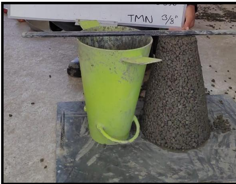
Figura 28 Asentamiento del concreto permeable TMN 3/8"
