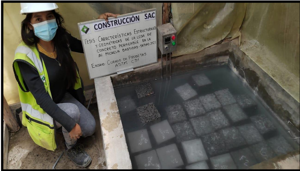
Figura 33 Curado de las vigas de concreto convencional y concreto permeable
