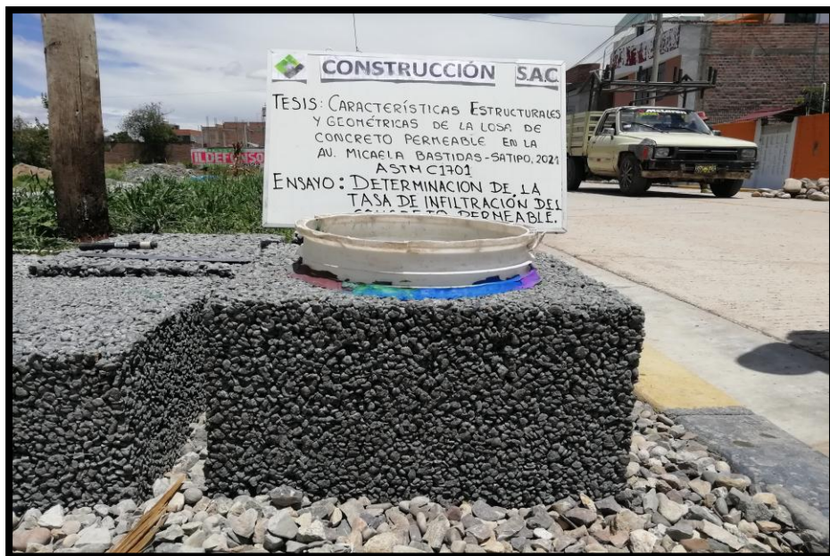
Figura 46 Losa de 25cm - Tasa de infiltración
