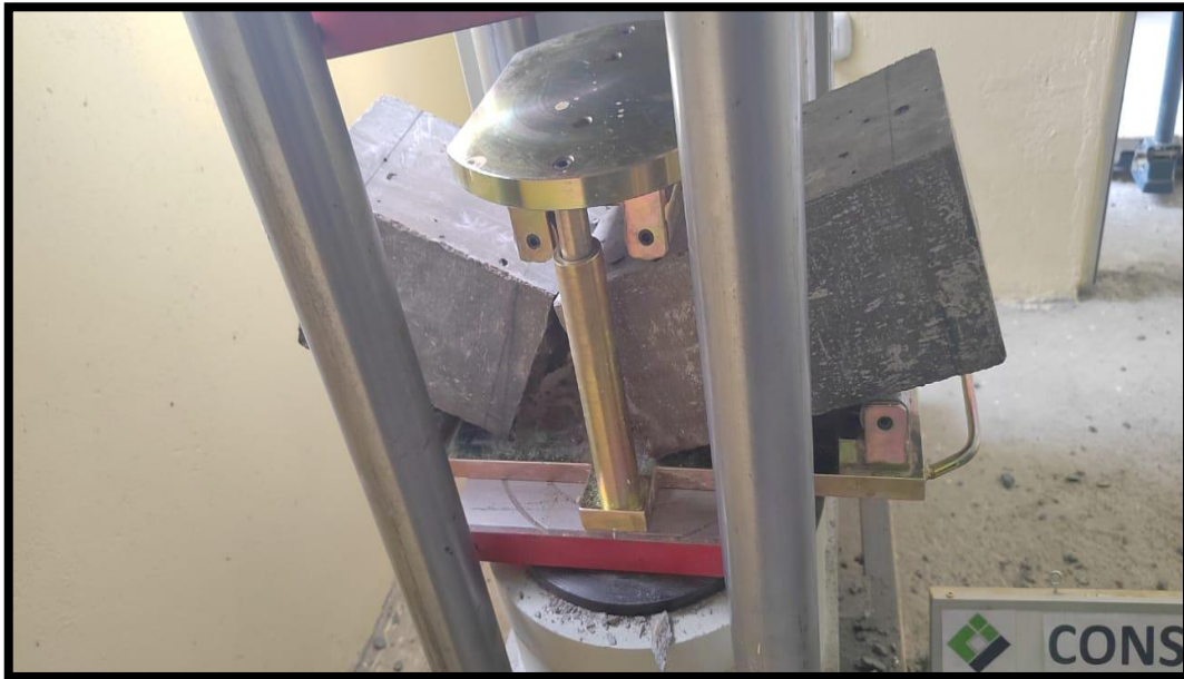
Figura 37 Rotura a flexión de la viga concreto convencional
