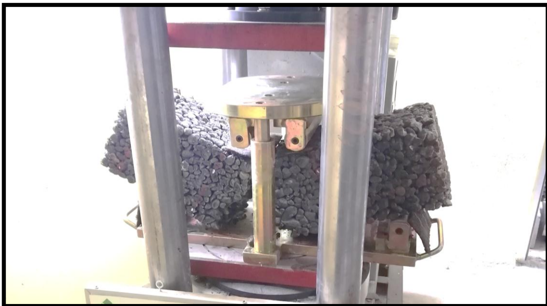
Figura 38 Rotura a flexión de la viga concreto permeable 1/2"
