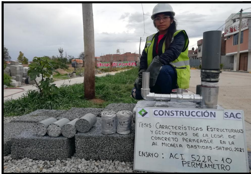
Figura 43 Elaboración del permeámetro ACI 522R-10
