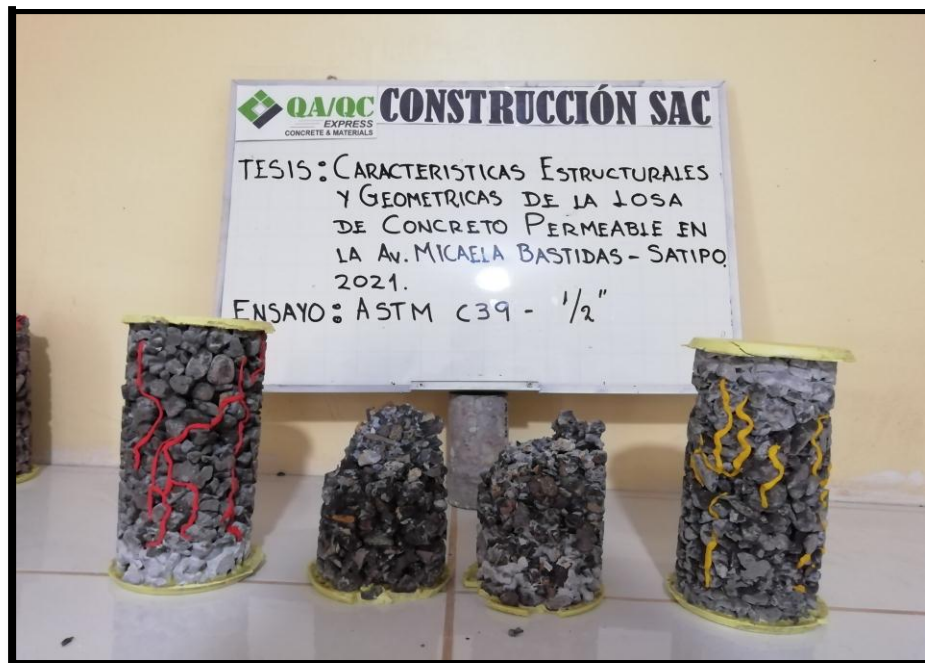
Figura 42 Falla de rotura a la compresión concreto permeable 1/2"
