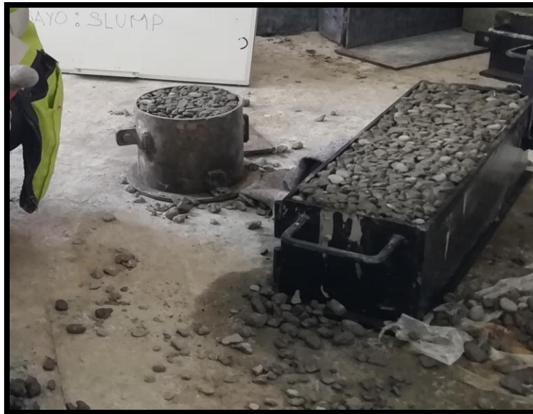
Figura 31 Vaciado del concreto permeable
