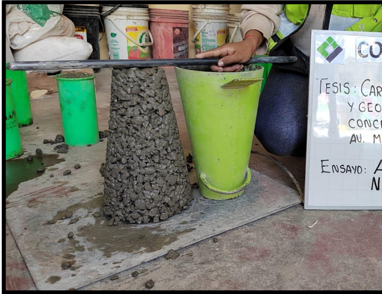
Figura 27 Asentamiento del concreto permeable 1/2"
