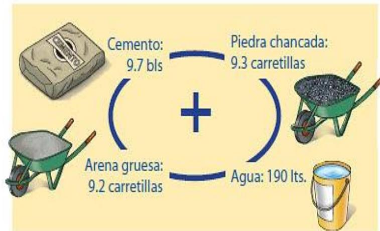
Figura 9: Mezcla por cada metro cúbico de concreto
