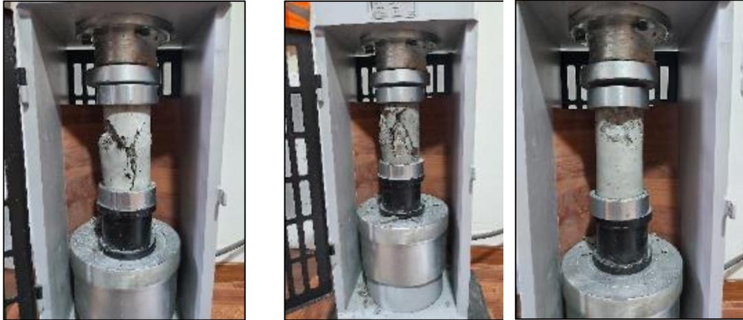
Fotografía 96, Fotografía 97, Fotografía 98, Fotografía 99 y Fotografía 100. Ensayo de resistencia a compresión de probetas de concreto con sustitución de cemento al 4 % a los 14 días de edad según la NTP 339.034.
