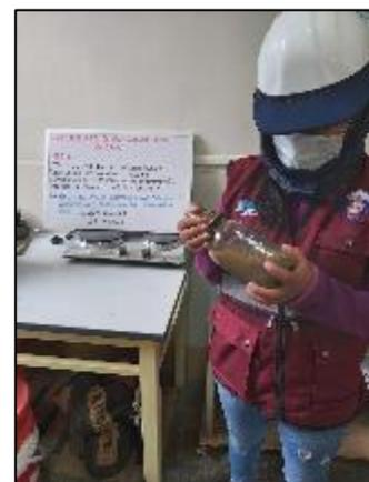
Fotografía 16, Fotografía 17, Fotografía 18 y Fotografía 19. Realización del ensayo para determinar la gravedad específica y absorción del agregado fino según la NTP 400.022.
