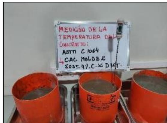
Fotografía 35 y Fotografía 36. Medición de la temperatura del concreto con sustitución de cemento al 4 % por diatomita según la NTP 339.083.
