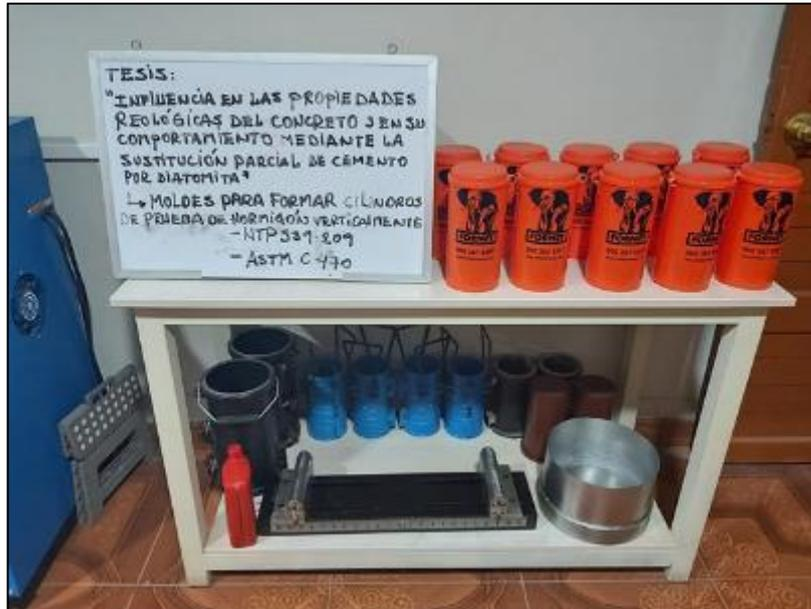
Fotografía 20. Vista de moldes para la elaboración de los cilindros de concreto de acuerdo a la NTP 339.209.
