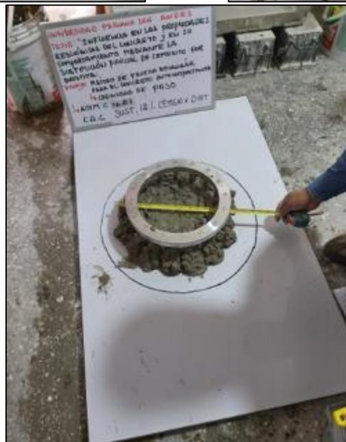
Fotografía 68, Fotografía 69 y Fotografía 70. Medición de la capacidad de paso del concreto con sustitución de cemento al 12 % por diatomita mediante el anillo J y la ASTM C1621.
