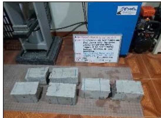
Fotografía 131 y Fotografía 132. Ensayo de resistencia a flexión de probetas de concreto con sustitución de cemento al 8 % a los 28 días de edad según la NTP 339.078.
