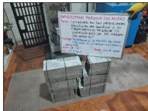
Fotografía 122 y Fotografía 123. Ensayo de resistencia a flexión de probetas de concreto patrón a los 28 días de edad según la NTP 339.078.
