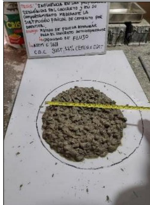
Fotografía 64, Fotografía 65, Fotografía 66 y Fotografía 67. Medición de la fluidez del concreto con sustitución de cemento al 12 % por diatomita según la norma ASTM C1611.
