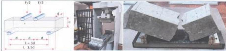
1) Los ensayos fueron realizados en conformidad con la Norma ASTM C150/C150M-15 por personal técnico capacitado.
