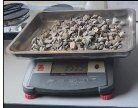
Fotografía 12, Fotografía 13, Fotografía 14 y Fotografía 15. Realización del ensayo para determinar la gravedad específica y absorción del agregado grueso según la NTP 400.021.
