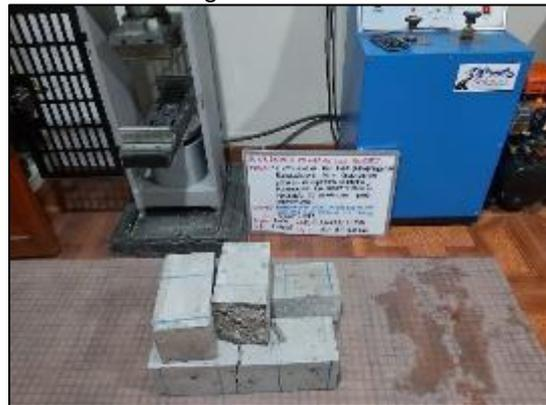
Fotografía 135 y Fotografía 136. Ensayo de resistencia a flexión de probetas de concreto con sustitución de cemento al 12 % a los 28 días de edad según la NTP 339.078.
