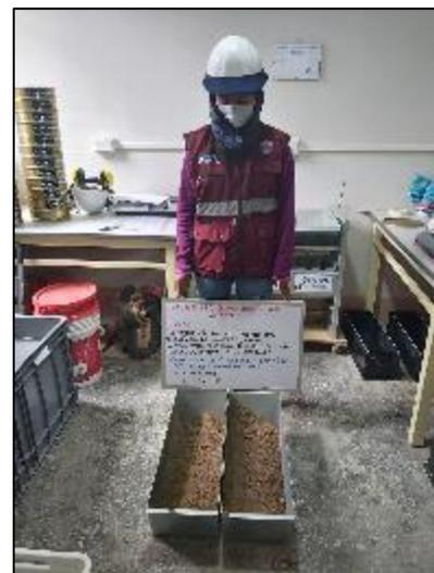
Fotografía 5 y Fotografía 6. Ensayo de reducción de muestras de agregado fino de acuerdo a la NTP 400.043 y el método A mediante cuarteador mecánico.
