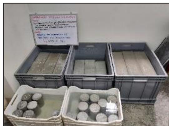
Fotografía 71 y Fotografía 72. Vista de vigas y probetas del concreto con sustitución de cemento al 12 % por diatomita.
