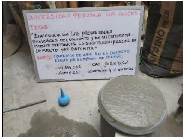
Fotografía 37. Medición del contenido de aire por el método a presión del concreto con sustitución de cemento al 4 % por diatomita según la NTP 339.085.
