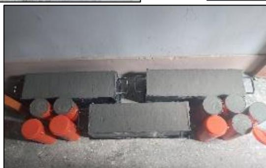
Fotografía 29, Fotografía 30 y Fotografía 31. Elaboración de cilindros de concreto y vigas del concreto patrón según la NTP 339.183.
