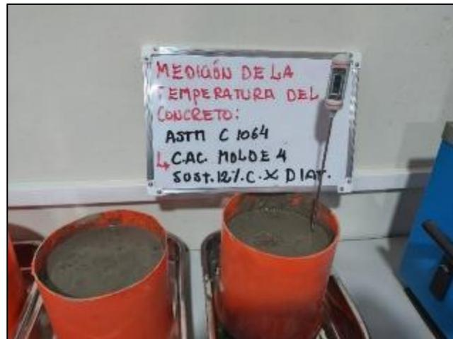
Fotografía 62. Medición de la temperatura del concreto con sustitución de cemento al 12 % por diatomita según la NTP 339.083.
