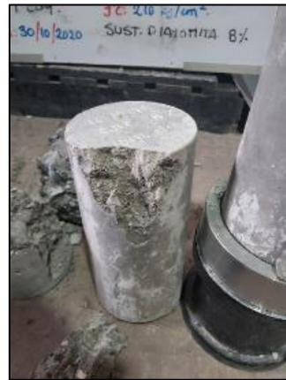
Fotografía 105, Fotografía 106, Fotografía 107 y Fotografía 108. Ensayo de resistencia a compresión de probetas de concreto con sustitución de cemento al 8 % a los 14 días de edad según la NTP 339.034.
