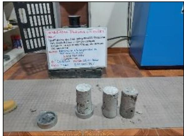
Fotografía 111 y Fotografía 112. Ensayo de resistencia a compresión de probetas de concreto con sustitución de cemento al 12 % a los 7 días de edad según la NTP 339.034.
