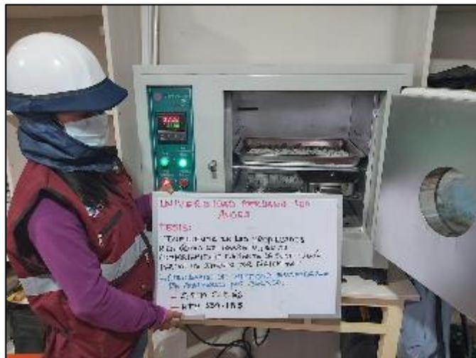
Fotografía 9. Ensayo para la determinación del contenido de humedad evaporable del agregado secado mediante la NTP 339.185.
