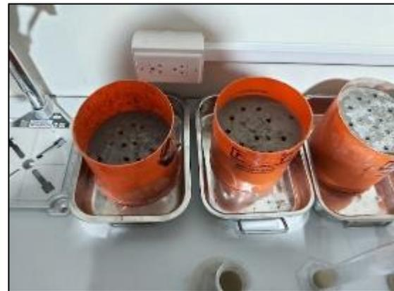
Fotografía 77, Fotografía 78, Fotografía 79, Fotografía 80, Fotografía 81 y Fotografía 82. Medición del tiempo de fragua del concreto patrón y de los concretos con sustitución al 4 %, 8 % y 12 % de cemento por diatomita según la NTP 339.082.
