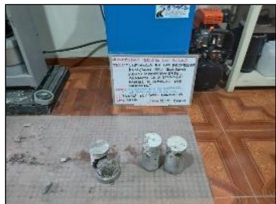
Fotografía 115 y Fotografía 116. Ensayo de resistencia a compresión de probetas de concreto con sustitución de cemento al 12 % a los 28 días de edad según la NTP 339.034.
