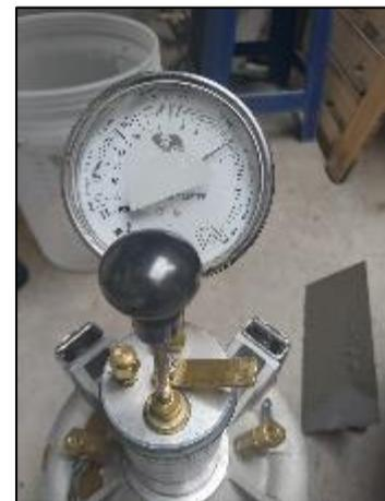
Fotografía 27 y Fotografía 28. Medición del contenido de aire en el concreto patrón mediante el método de presión y la NTP 339.085.
