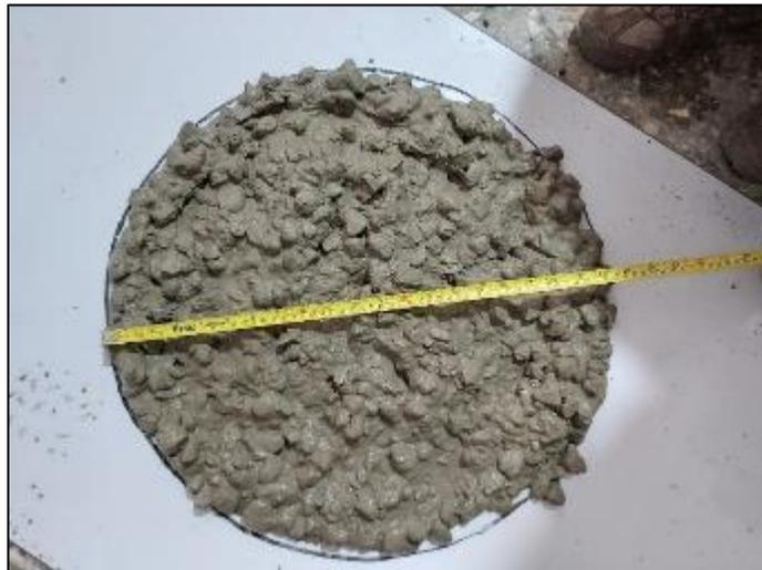
Fotografía 38, Fotografía 39 y Fotografía 40. Medición de la fluidez del concreto con sustitución de cemento al 4 % por diatomita según la norma ASTM C1611.
