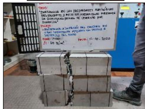
Fotografía 117, Fotografía 118, Fotografía 119, Fotografía 120 y Fotografía 121. Ensayo de resistencia a flexión de probetas de concreto patrón a los 14 días de edad según la NTP 339.078.
