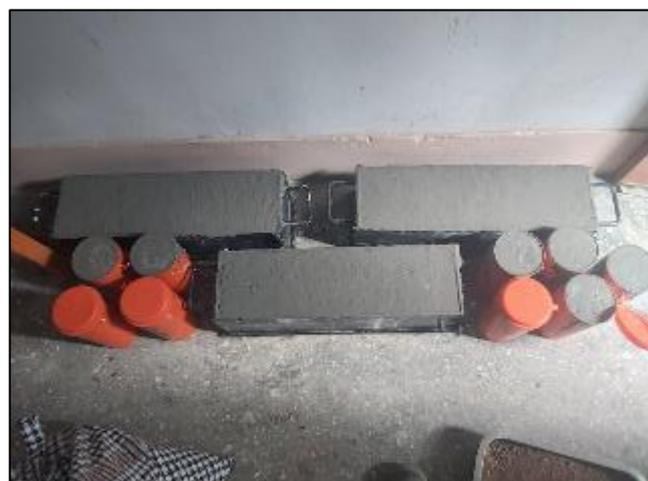
Fotografía 45. Vista de probetas y vigas del concreto con sustitución de cemento al 4 % por diatomita.
