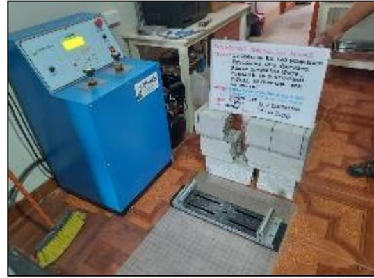
Fotografía 133 y Fotografía 134. Ensayo de resistencia a flexión de probetas de concreto con sustitución de cemento al 12 % a los 14 días de edad según la NTP 339.078.
