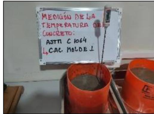
Fotografía 25 y Fotografía 26. Medición de la temperatura del concreto patrón de acuerdo a la NTP 339.083.
