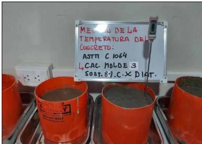
Fotografía 49. Medición de la temperatura del concreto con sustitución de cemento al 8 % por diatomita según la NTP 339.083.
