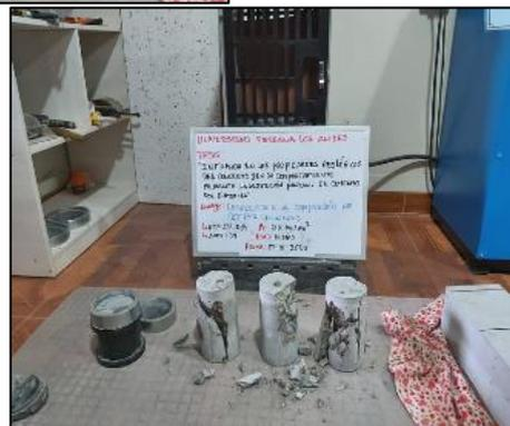
Fotografía 88, Fotografía 89 y Fotografía 90. Ensayo de resistencia a compresión de probetas de concreto patrón a los 14 días de edad según la NTP 339.034.
