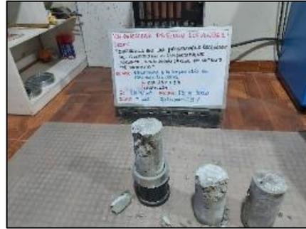
Fotografía 103 y Fotografía 104. Ensayo de resistencia a compresión de probetas de concreto con sustitución de cemento al 8 % a los 7 días de edad según la NTP 339.034.
