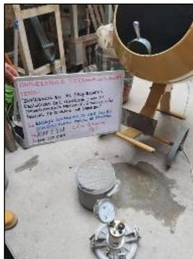
Fotografía 63. Medición del contenido de aire por el método a presión del concreto con sustitución de cemento al 12 % por diatomita según la NTP 339.085.
