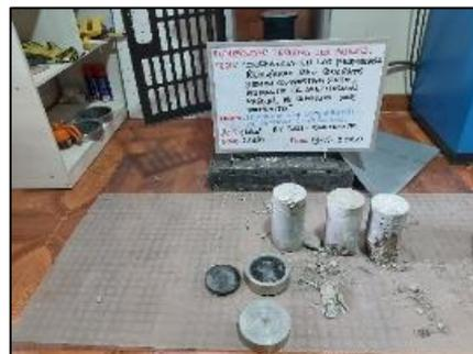
Fotografía 109 y Fotografía 110. Ensayo de resistencia a compresión de probetas de concreto con sustitución de cemento al 8 % a los 28 días de edad según la NTP 339.034.
