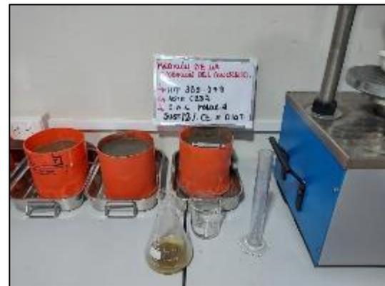
Fotografía 73, Fotografía 74, Fotografía 75 y Fotografía 76. Medición de la exudación del concreto patrón y de los concretos con sustitución al 4 %, 8 % y 12 % de cemento por diatomita según la NTP 339.077.
