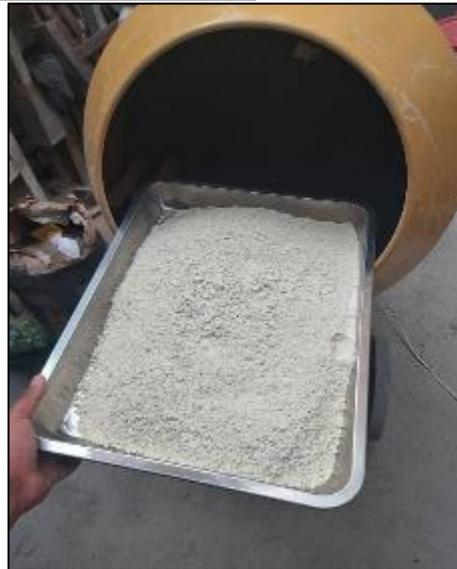
Fotografía 46, Fotografía 47 y Fotografía 48. Vista de materiales tales como agregado, aditivo, agua y diatomita para la elaboración del concreto autocompactante con sustitución del cemento en 8 % por diatomita.
