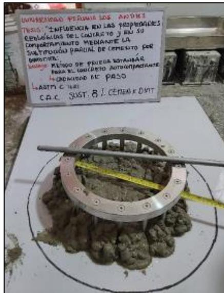
Fotografía 55, Fotografía 56 y Fotografía 57. Medición de la capacidad de paso del concreto con sustitución de cemento al 8 % por diatomita mediante el anillo J y la ASTM C1621.
