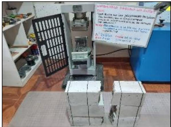
Fotografía 124 y Fotografía 125. Ensayo de resistencia a flexión de probetas de concreto con sustitución de cemento al 4 % a los 14 días de edad según la NTP 339.078.
