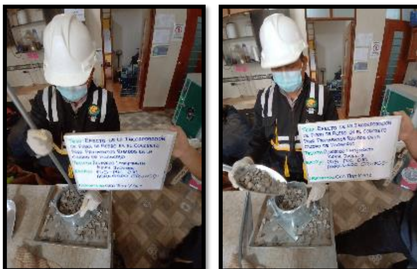
Fotografía 7 y Fotografía 8: Realización del ensayo para determinar PUS-PUC del agregado grueso según la NTP 400.012.
