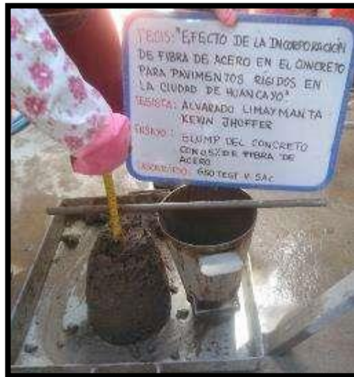
Fotografía 36: Medición del asentamiento del concreto con 0.5 % de fibra de acero en un rango de 3" a 4" según la norma NTP 339.114.
