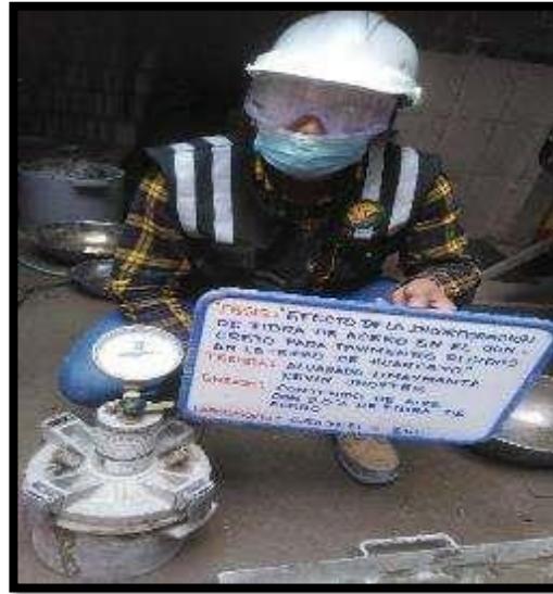
Fotografía 65 y Fotografía 66: Medición del contenido de aire por el método a presión del concreto con 2.0 % de fibra de acero según la NTP 339.085.
