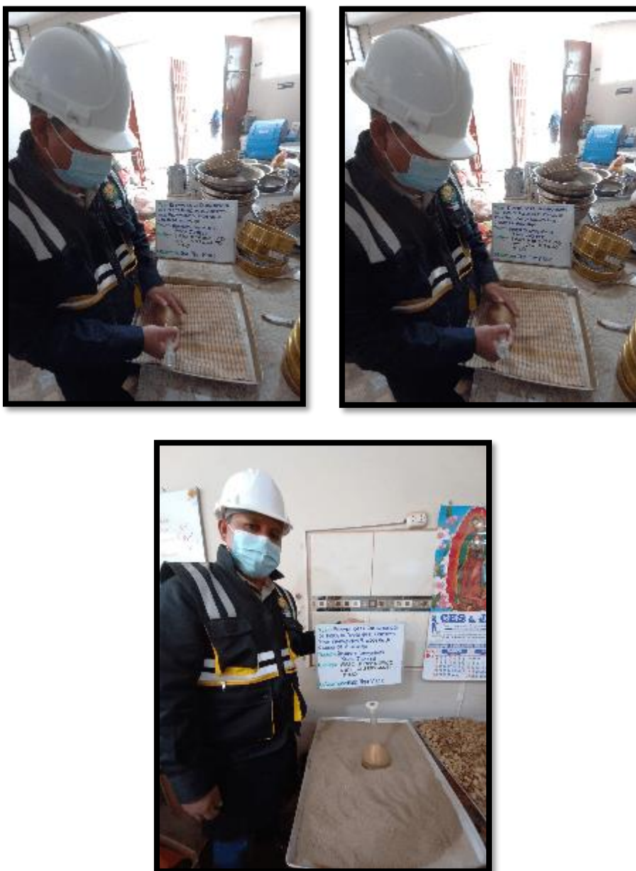
Fotografía 11, Fotografía 12, Fotografía 13: Realización del ensayo para determinar el Método de ensayo normalizado para peso específico y absorción del agregado fino Norma Técnica NTP 400 021 PERUANA.
