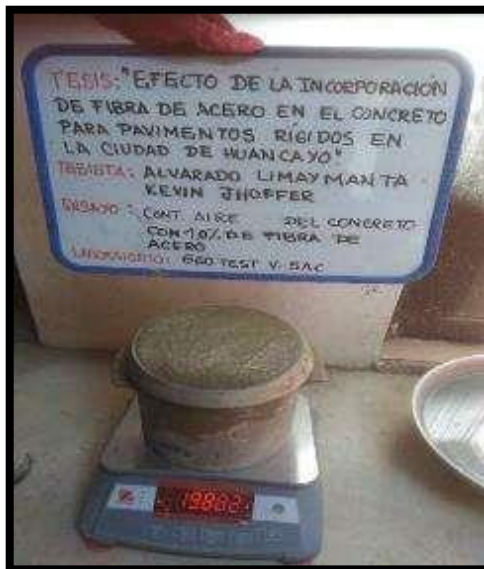
Fotografía 44 y Fotografía 45: Medición del contenido de aire por el método a presión del concreto con 1.0 % de fibra de acero según la NTP 339.085.
