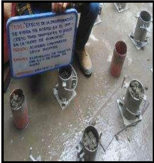
Fotografía 68 y Fotografía 69: Vista de vigas y probetas del concreto con 2.0 % de fibra de acero según la NTP 339.183.
