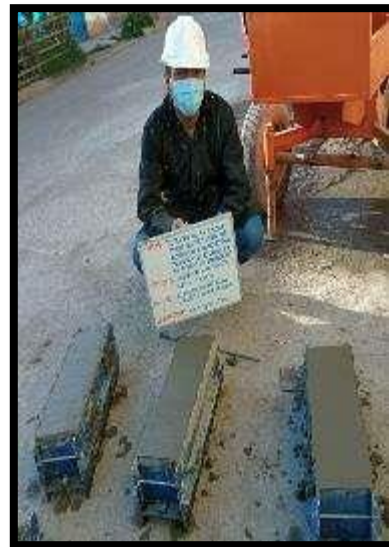
Fotografía 25 y Fotografía 26: Elaboración de cilindros de concreto y vigas del concreto patrón según la NTP 339.183.
