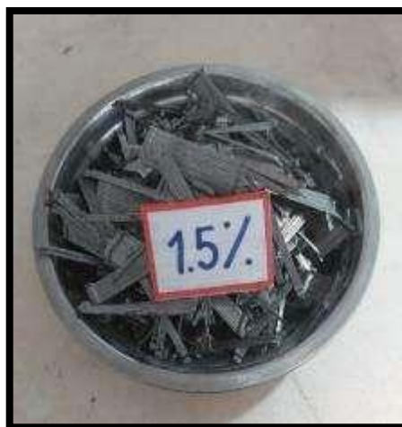
Fotografía 49, Fotografía 50, Fotografía 51, Fotografía 52 y Fotografía 53. Vista de materiales tales como agregado, cemento, agua y fibras de acero para la elaboración del concreto con 1.5 % de fibra de acero.
