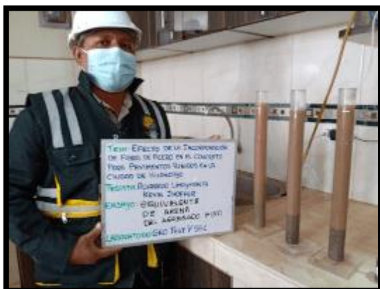
Fotografía 14, Fotografía 15: Este ensayo tiene por objeto determinar la proporción relativa del contenido de polvo fino nocivo, o material arcilloso, en los suelos o agregados finos, ensayo normalizado Norma Técnica NTP 400.015.20 PERUANA.
