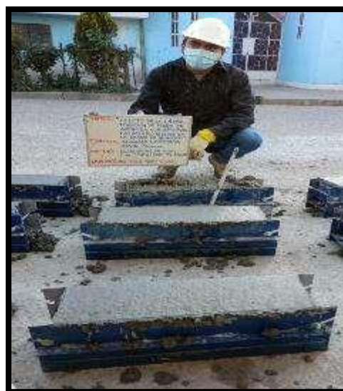
Fotografía 58 y Fotografía 59: Vista de vigas y probetas del concreto con 1.5 % de fibra de acero según la NTP 339.183.
