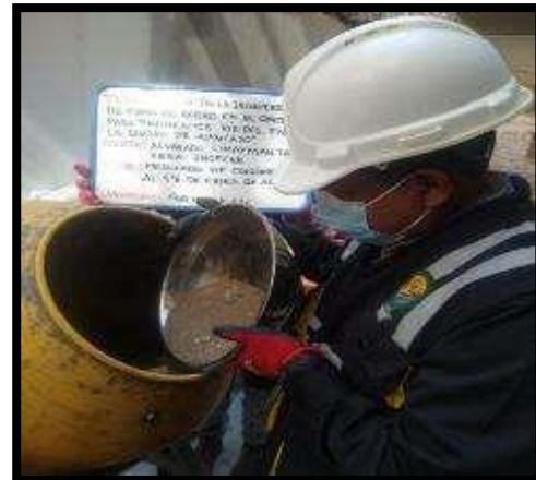
Fotografía 39, Fotografía 40, Fotografía 41 y Fotografía 42: Vista de materiales tales como agregado, cemento, agua y fibras de acero para la elaboración del concreto con 1.0 % de fibra de acero.
