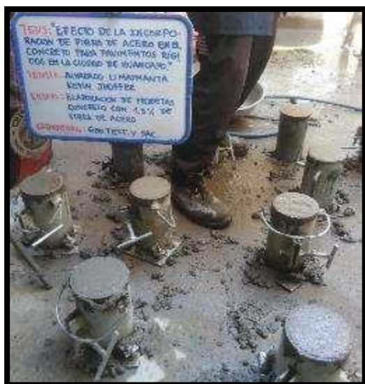
Fotografía 58 y Fotografía 59: Vista de vigas y probetas del concreto con 1.5 % de fibra de acero según la NTP 339.183.
