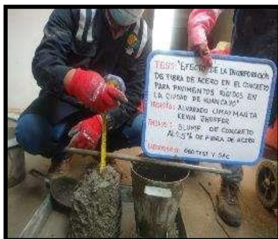
Fotografía 57: Medición del asentamiento del concreto con 1.5 % de fibra de acero en un rango de 3" a 4" según la norma NTP 339.114.
