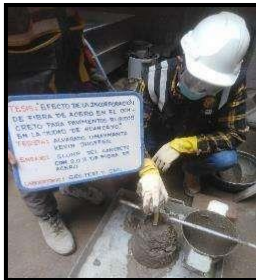
Fotografía 67: Medición del asentamiento del concreto con 2.0 % de fibra de acero en un rango de 3" a 4" según la norma NTP 339.114.
