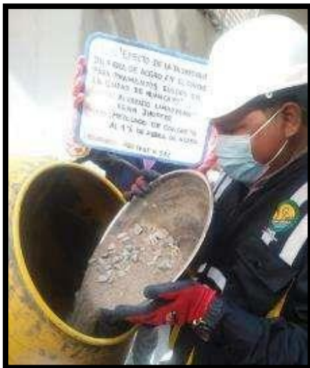
Fotografía 39, Fotografía 40, Fotografía 41 y Fotografía 42: Vista de materiales tales como agregado, cemento, agua y fibras de acero para la elaboración del concreto con 1.0 % de fibra de acero.
