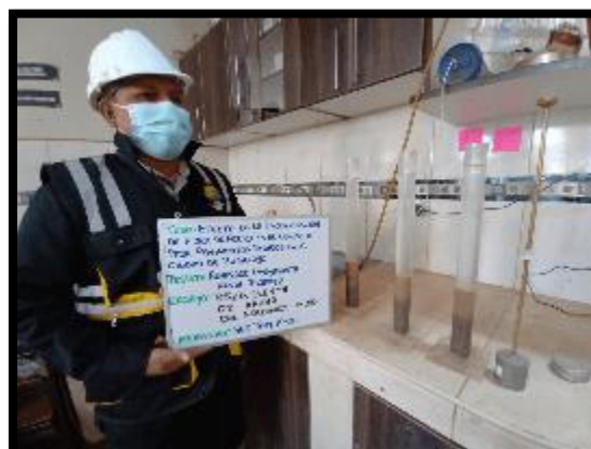
Fotografía 14, Fotografía 15: Este ensayo tiene por objeto determinar la proporción relativa del contenido de polvo fino nocivo, o material arcilloso, en los suelos o agregados finos, ensayo normalizado Norma Técnica NTP 400.015.20 PERUANA.
