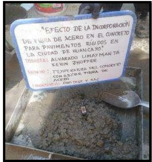
Fotografía 32 y Fotografía 33: Medición de la temperatura del concreto con 0.5 % de fibra de acero. según la NTP 339.083.
