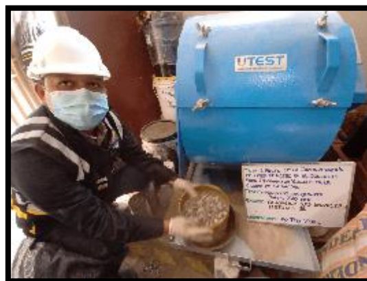
Fotografía 16, Fotografía 17: Este ensayo tiene por objeto la determinación de resistencia de agregados, ensayo que es elegido por el método B según la Norma Técnica NTP 400.019 PERUANA.
