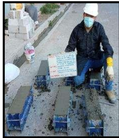
Fotografía 77: Vista de vigas y probetas del concreto con 3.0 % de fibra de acero según la NTP 339.183.
