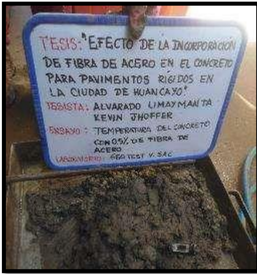
Fotografía 32 y Fotografía 33: Medición de la temperatura del concreto con 0.5 % de fibra de acero. según la NTP 339.083.
