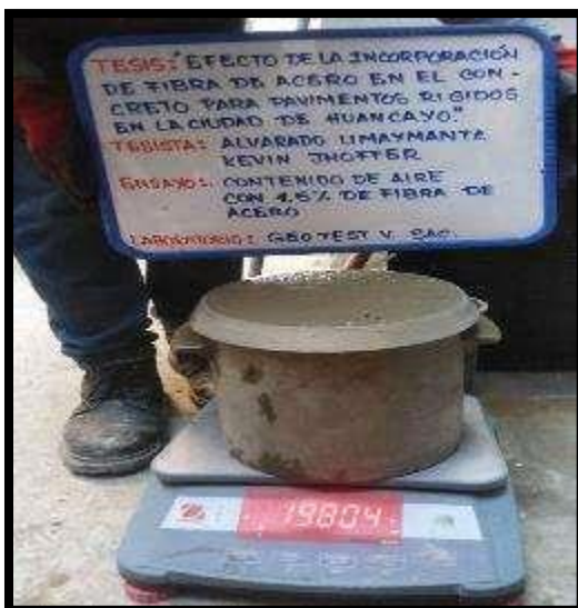
Fotografía 55 y Fotografía 56: Medición del contenido de aire por el método a presión del concreto con 1.5 % de fibra de acero según la NTP 339.085.
