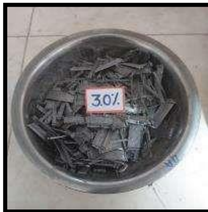
Fotografía 70, Fotografía 71, Fotografía 72 y Fotografía 73: Vista de materiales tales como agregado, cemento, agua y fibras de acero para la elaboración del concreto con 3.0 % de fibra de acero.
