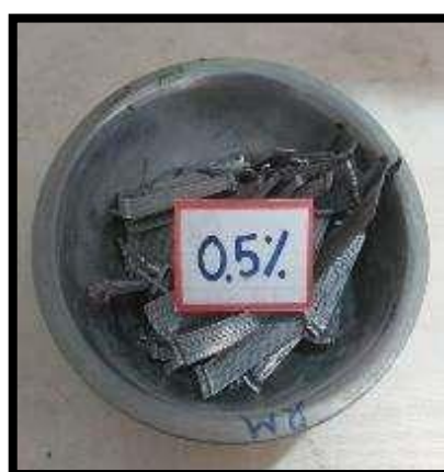
Fotografía 27, Fotografía 28, Fotografía 29, Fotografía 30 y Fotografía 31: Vista de materiales tales como agregado, cemento, agua y fibras de acero para la elaboración del concreto con 0.5 % de fibra de acero.
