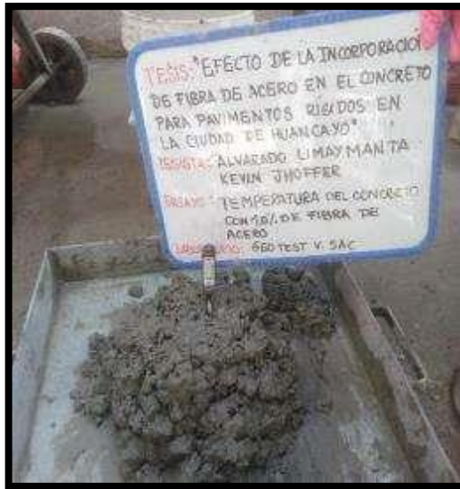
Fotografía 43: Medición de la temperatura del concreto con 1.0 % de fibra de acero. según la NTP 339.083.
