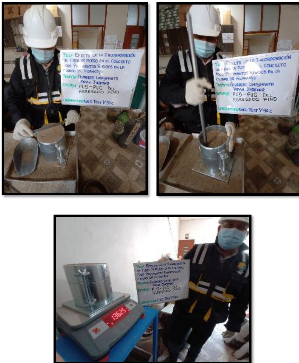
Fotografía 4, Fotografía 5 y Fotografía 6: Realización del ensayo para determinar PUS-PUC del agregado fino según la NTP 400.012.
