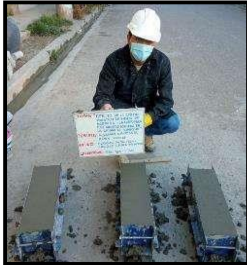
Fotografía 68 y Fotografía 69: Vista de vigas y probetas del concreto con 2.0 % de fibra de acero según la NTP 339.183.
