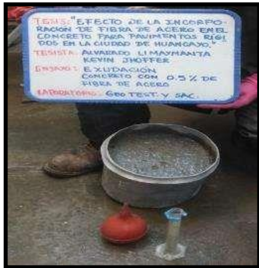
Fotografía 78, Fotografía 79, Fotografía 80 y Fotografía 81: Medición de la exudación del concreto patrón y de los concretos con 0.5%, 1.0%, 1.5%, 2.0% y 3.0% de fibra de acero según la NTP 339.077.
