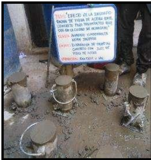
Fotografía 77: Vista de vigas y probetas del concreto con 3.0 % de fibra de acero según la NTP 339.183.
