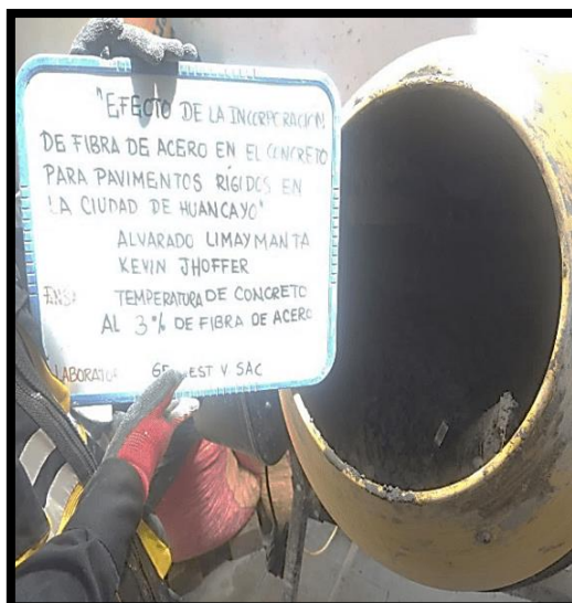
Fotografía 74: Medición de la temperatura del concreto con 3.0 % de fibra de acero según la NTP 339.083.
