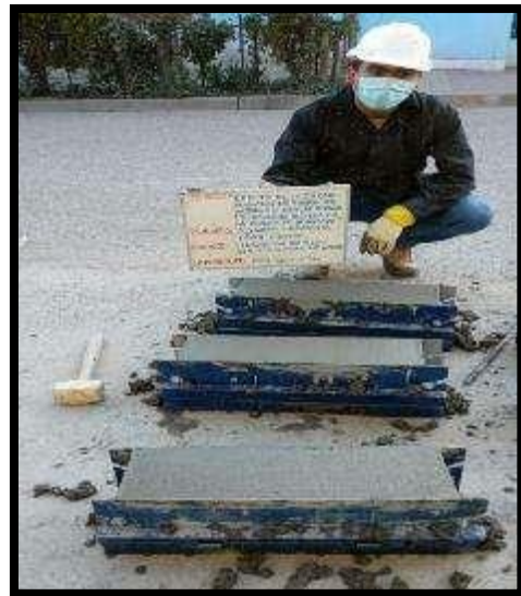
Fotografía 47 y Fotografía 48: Vista de vigas y probetas del concreto con 1.0 % de fibra de acero según la NTP 339.183.
