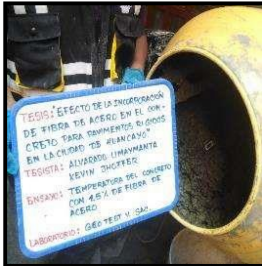
Fotografía 54: Medición de la temperatura del concreto con 1.5 % de fibra de acero. según la NTP 339.083.
