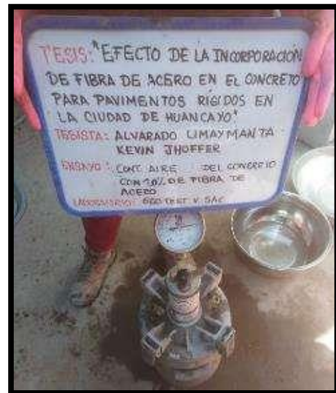
Fotografía 44 y Fotografía 45: Medición del contenido de aire por el método a presión del concreto con 1.0 % de fibra de acero según la NTP 339.085.
