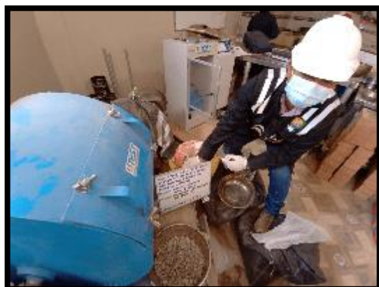
Fotografía 16, Fotografía 17: Este ensayo tiene por objeto la determinación de resistencia de agregados, ensayo que es elegido por el método B según la Norma Técnica NTP 400.019 PERUANA.
