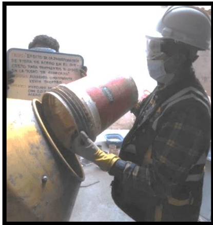
Fotografía 60, Fotografía 61, Fotografía 62 y Fotografía 63: Vista de materiales tales como agregado, cemento, agua y fibras de acero para la elaboración del concreto con 2.0 % de fibra de acero.
