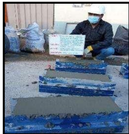
Fotografía 37 y Fotografía 38: Vista de probetas y vigas del concreto con 0.5 % de fibra de acero según la NTP 339.183.
