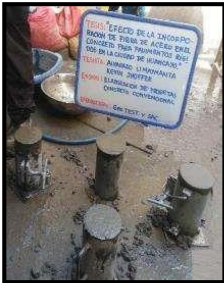
Fotografía 25 y Fotografía 26: Elaboración de cilindros de concreto y vigas del concreto patrón según la NTP 339.183.
