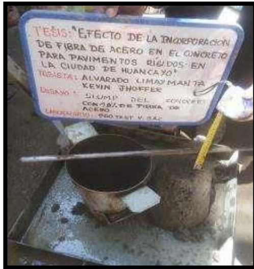
Fotografía 46: Medición del asentamiento del concreto con 1.0 % de fibra de acero en un rango de 3" a 4" según la norma NTP 339.114.
