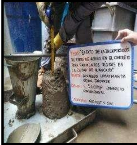
Fotografía 24: Medición del asentamiento del concreto patrón fresco en un rango de 3" a 4" según la norma NTP 339.114.
