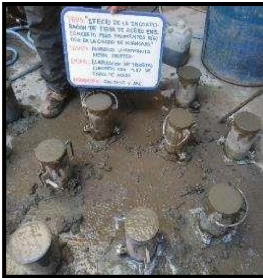
Fotografía 47 y Fotografía 48: Vista de vigas y probetas del concreto con 1.0 % de fibra de acero según la NTP 339.183.
