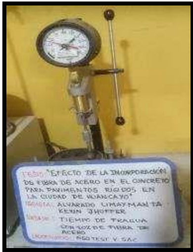
Fotografía 82 y Fotografía 83: Medición del tiempo de fragua del concreto patrón y con 0.5%, 1.0%, 1.5%, 2.0% y 3.0% de fibra de acero según la NTP 339.082.
