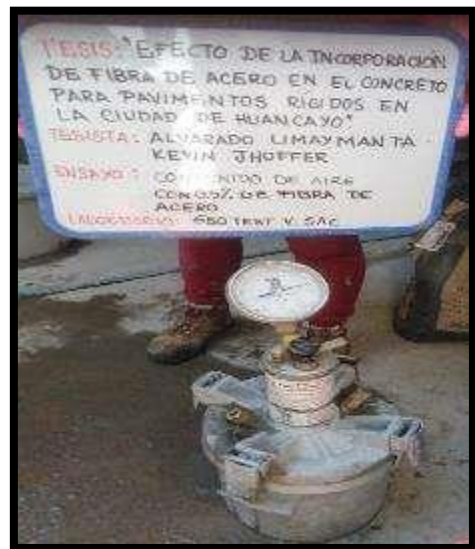
Fotografía 34 y Fotografía 35. Medición del contenido de aire por el método a presión del concreto con 0.5 % de fibra de acero según la NTP 339.085.
