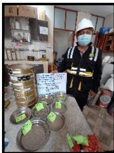
Fotografía 1, Fotografía 2, Fotografía 3: Ensayo de granulometría del agregado fino y grueso de acuerdo a la NTP 400.012.
