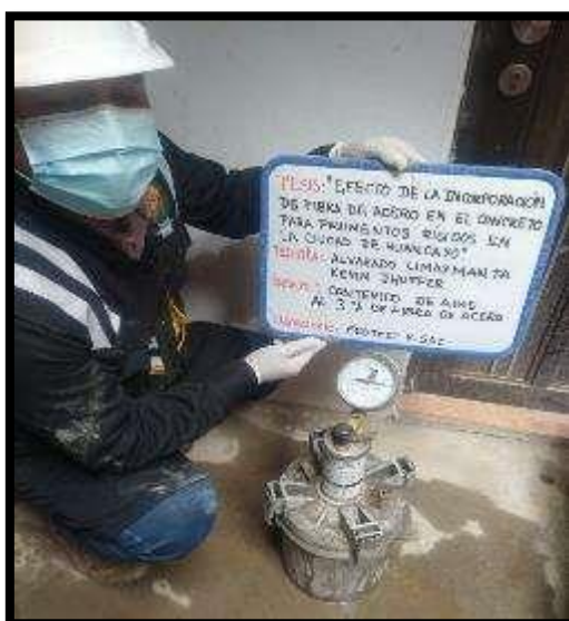
Fotografía 75: Medición del contenido de aire por el método a presión del concreto con 3.0 % de fibra de acero según la NTP 339.085.
