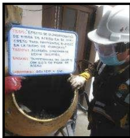
Fotografía 64. Medición de la temperatura del concreto con 2.0 % de fibra de acero. según la NTP 339.083.
