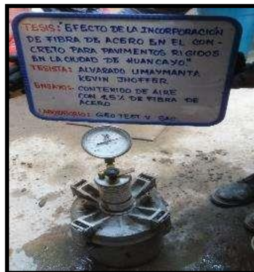
Fotografía 55 y Fotografía 56: Medición del contenido de aire por el método a presión del concreto con 1.5 % de fibra de acero según la NTP 339.085.
