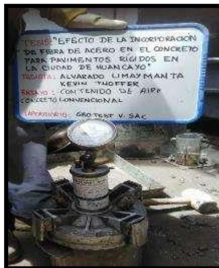
Fotografía 23: Medición del contenido de aire en el concreto patrón mediante el método de presión y la NTP 339.085.
