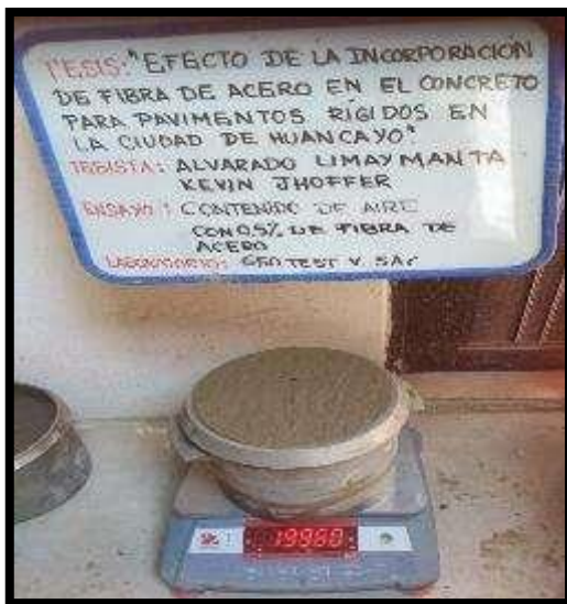
Fotografía 34 y Fotografía 35. Medición del contenido de aire por el método a presión del concreto con 0.5 % de fibra de acero según la NTP 339.085.
