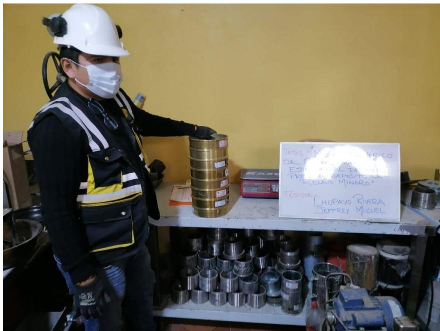
**Figura 4.5** Tamizado de la Muestra de Relave.
