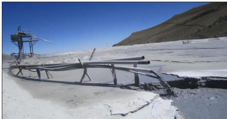
Figura 2.12 Clasificación De Relaves Mediante Hidrociclón
