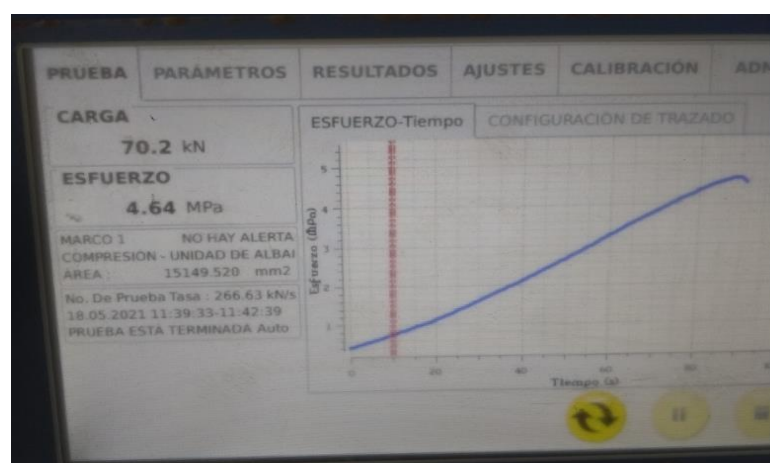
Figura 3.5 Curva de Resistencia de a la Compresión de Medias Unidades
