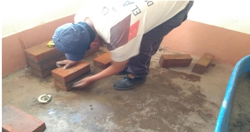
Figura 3.10 Armado de las Pilas de Ladrillos
