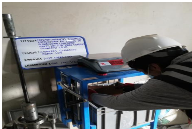
Figura 3.9 Peso del Ladrillo Totalmente Sumergido en Agua Fría
