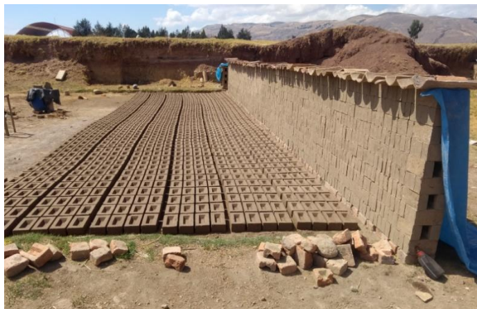
Figura 2.1 Secado de Ladrillos Artesanales de Arcilla - Jauja
