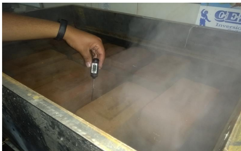
Figura 3.7 Ladrillos Inmersos en Agua en Punto de Ebullición
