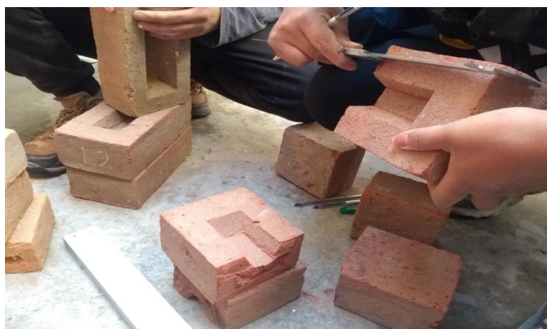
Figura 3.4 Preparación de Medias Unidades
