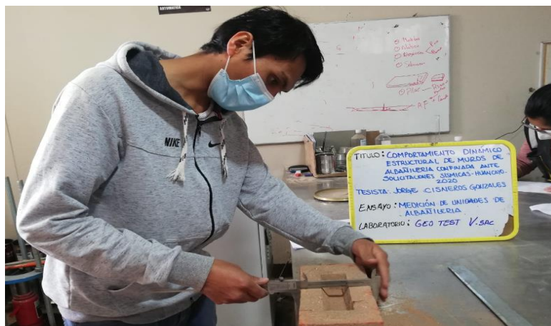
Figura 3.3 Medición de Dimensiones de Ladrillos
