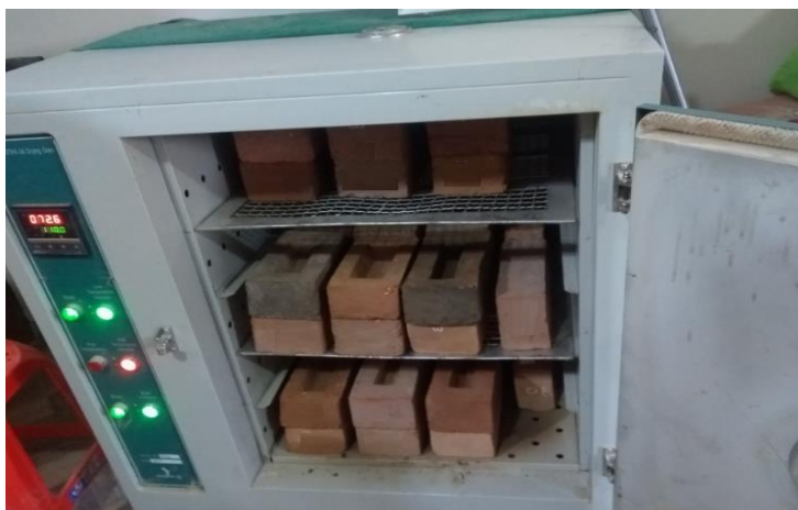
Figura 3.6 Horno a 110C° por 24 Horas FUENTE: Elaboración Propia
