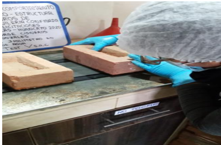
Figura 3.8 Ladrillo en una Película de Agua de 3 mm.
