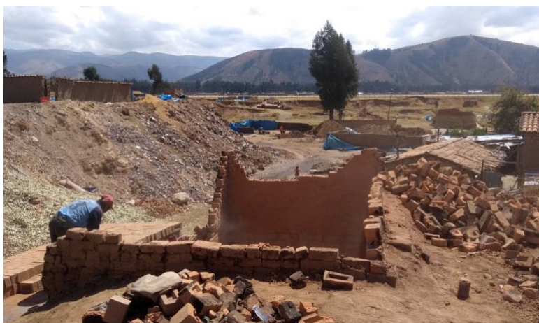
Figura 3.2 Extracción de Ladrillos del Horno - Jauja
