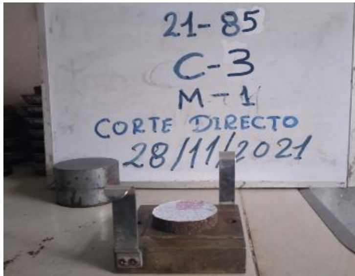
Fotografía 14: Remoldeado de muestra 1 de C3 para ensayo de corte directo
