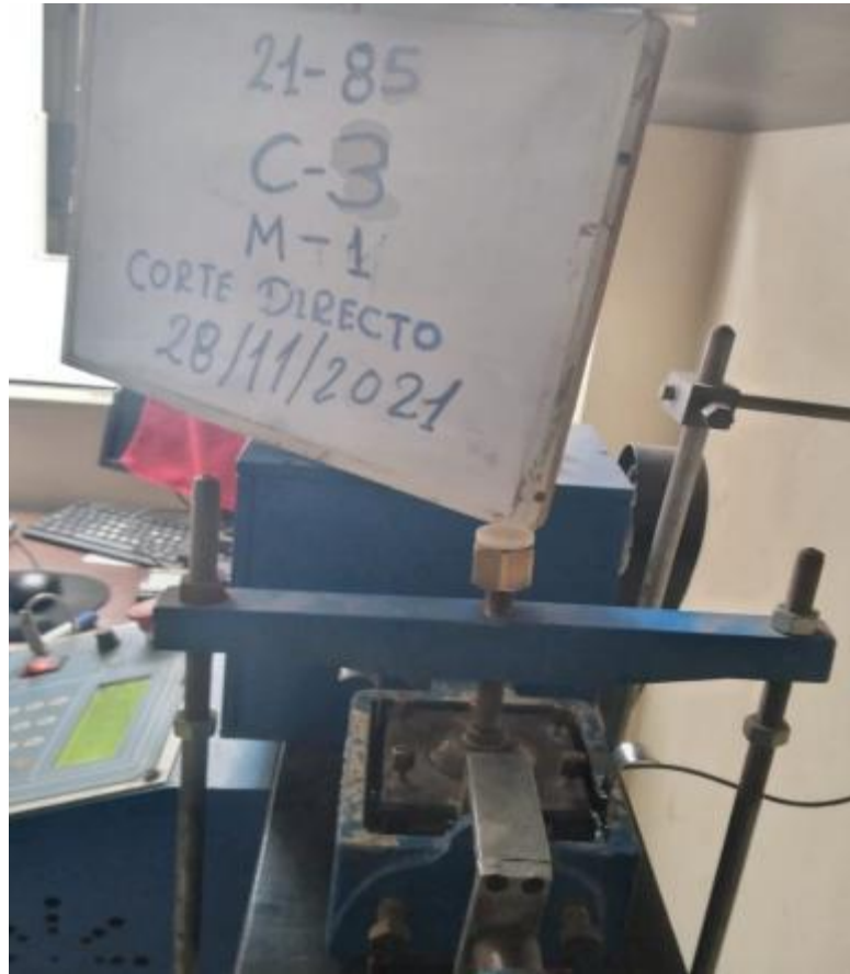
Fotografía 17: Ensayo de corte directo de muestra 1 de C2
