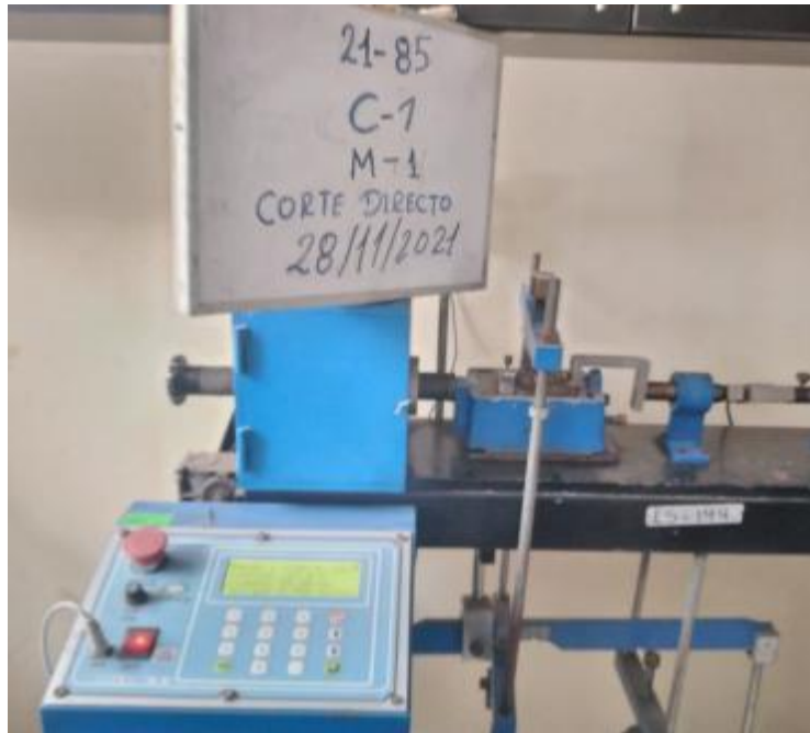
Fotografía 15: Ensayo de corte directo de muestra 1 de C1
