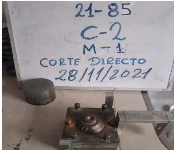
Fotografía 13: Remoldeado de muestra 1 de C2 para ensayo de corte directo
