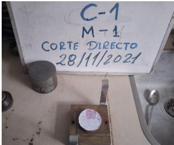
Fotografía 12: Remoldeado de muestra 1 de C1 para ensayo de corte directo
