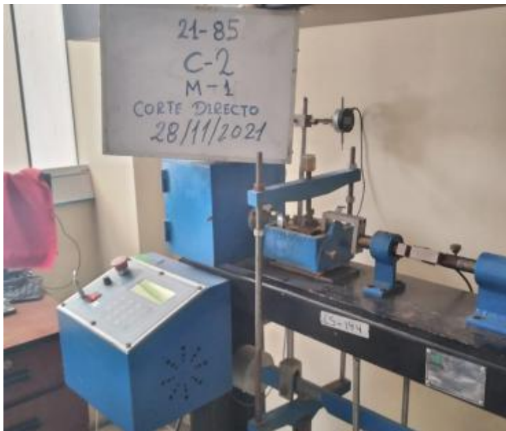
Fotografía 16: Ensayo de corte directo de muestra 1 de C2
