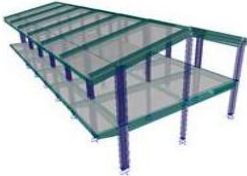
Figura 77 Estructura del puesto de salud de la comunidad nativa de Mazaronquiari en el software ETABS Fuente: Elaboración propia.
