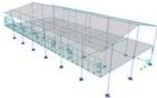
Figura 67 Carga de parapeto en corredor Fuente: Elaboración propia.
