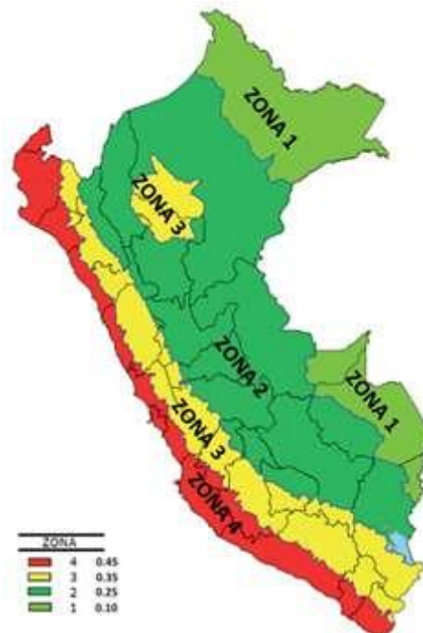
Figura 40 Zonas sísmicas Fuente: Norma E.030 del RNE.
