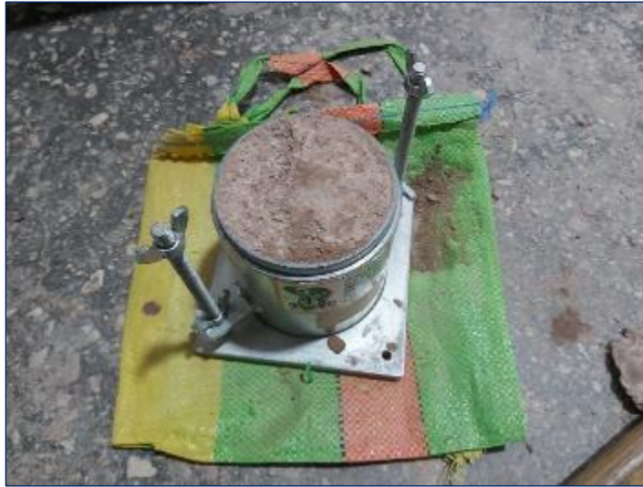
Figura 60. Preparación de la muestra de suelo+ 10% de sulfato de calcio, mediante el ensayo Proctor.
