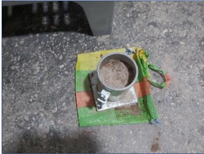
Figura 54. Preparación de la muestra de suelo+ 8% de sulfato de calcio, mediante el ensayo Proctor.
