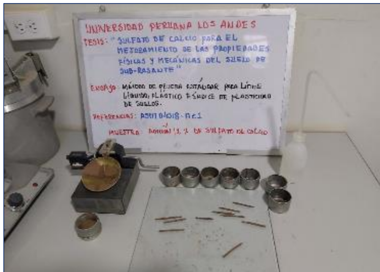
Figura 64. Ensayo de límite líquido y plástico de suelo + 12% de sulfato de calcio.
