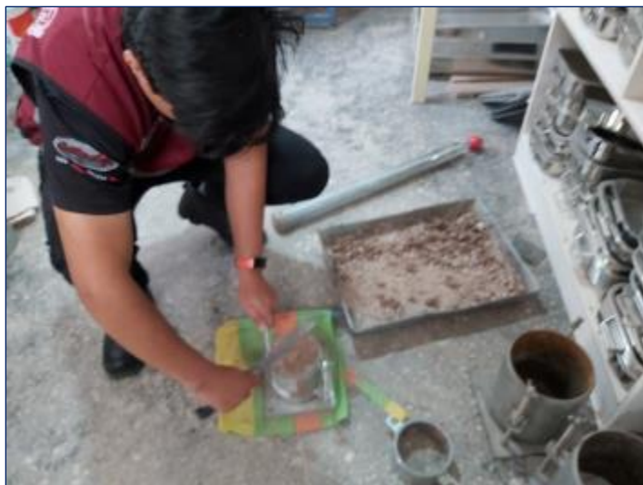
Figura 41. Enrasado después de compactación del suelo patrón.
