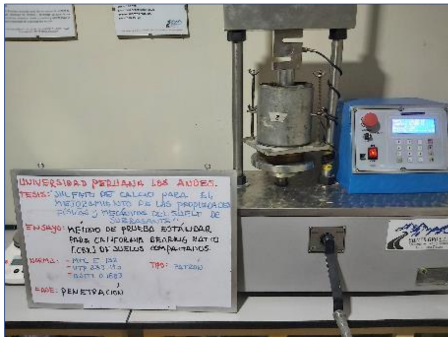
Figura 22. Método de prueba estándar para California Bearing Ratio (CBR) de suelos compactados en laboratorio con normativa ASTM D 1883.
