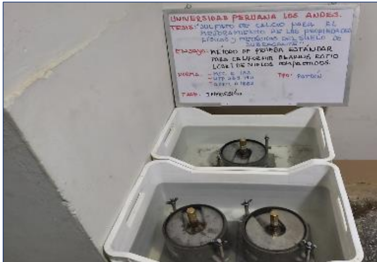
Figura 42. Muestras de suelo patrón sumergidas para su posterior análisis en la máquina de compresión.
