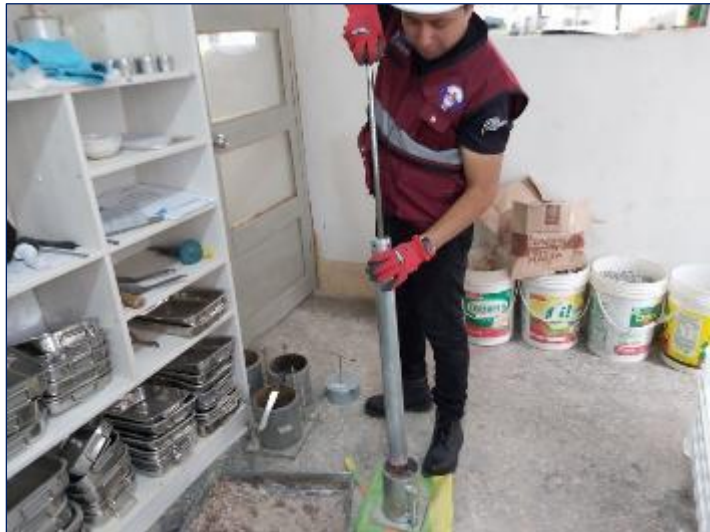
Figura 40. Compactación del suelo para la ejecución del ensayo Proctor.
