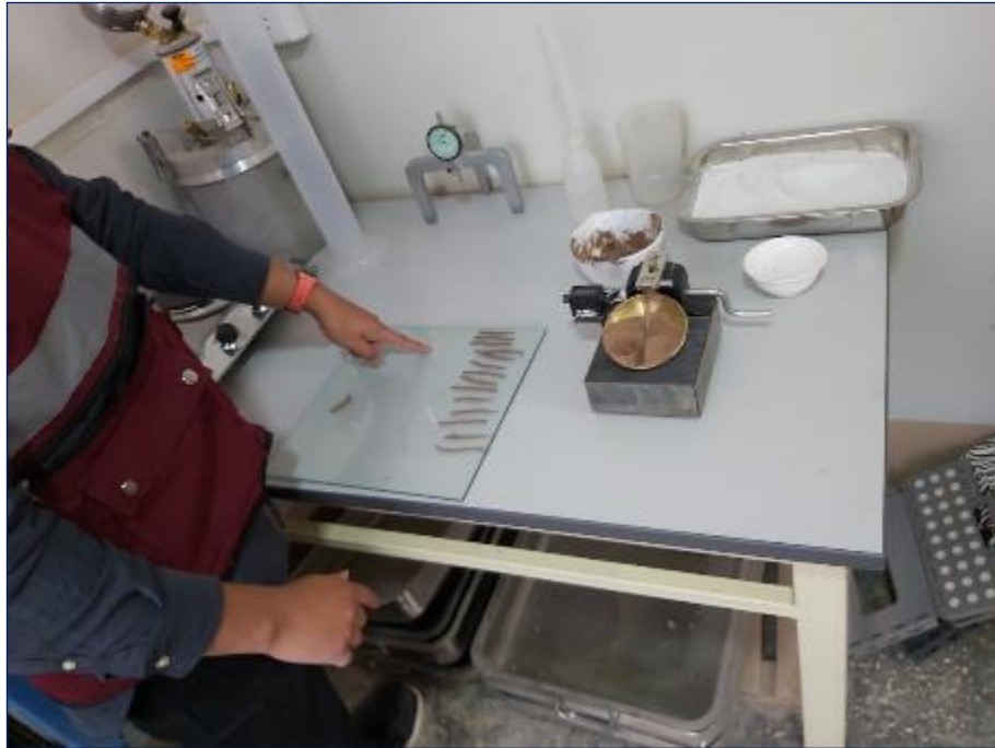
Figura 19. Método de prueba estándar para límite líquido, límite plástico e índice de plasticidad de suelos de acuerdo con la norma NTP 339.129 - ASTM D4318-17e1.
