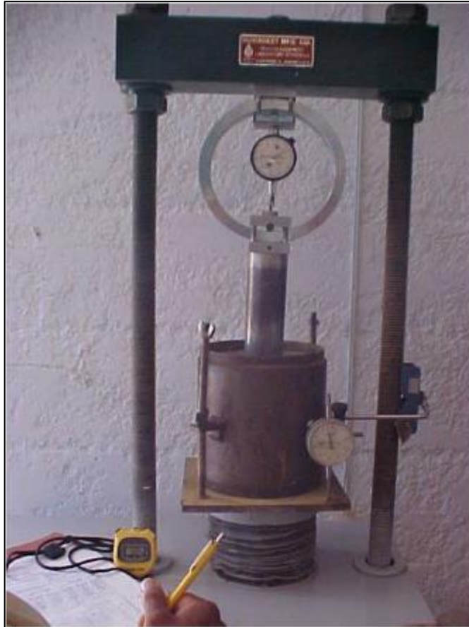
Figura 13. Ensayo de CBR. Fuente: Villar y Oblitas (2020).
