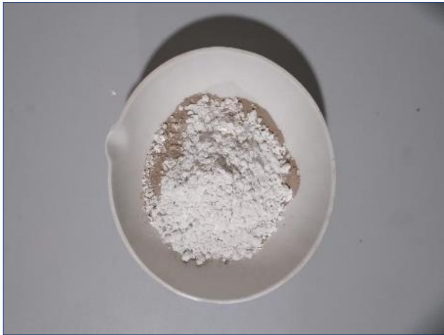
Figura 23. Mezcla del sulfato de calcio con el suelo patrón.
