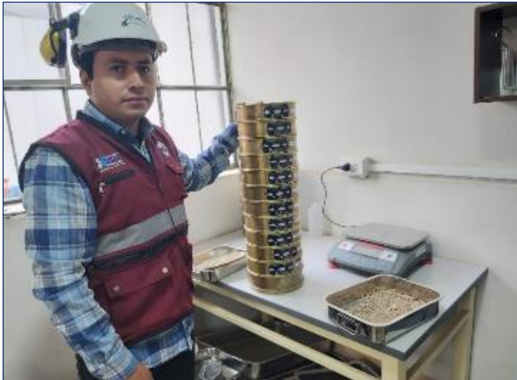
Figura 37. Ensayo de granulometría del suelo.
