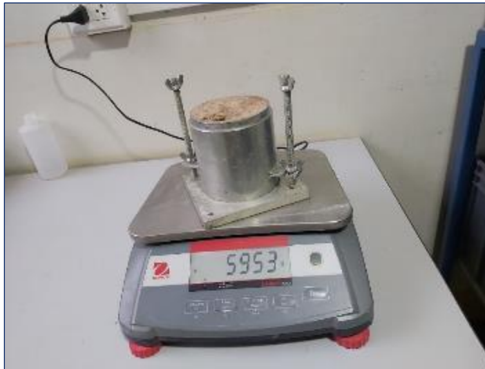
Figura 66. Preparación de la muestra de suelo+ 12 % de sulfato de calcio, mediante el ensayo Proctor.
