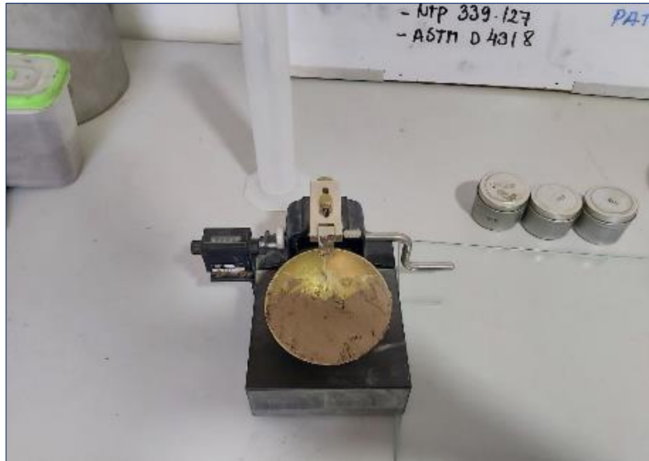
Figura 18. Método de prueba estándar para límite líquido, límite plástico e índice de plasticidad de suelos de acuerdo con la norma NTP 339.129 - ASTM D4318-17e1.
