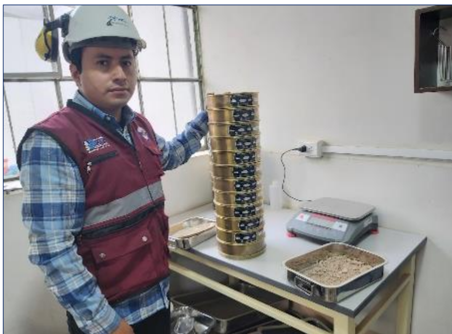
Figura 17. Método de prueba estándar para la distribución del tamaño de partículas (gradación) de suelos usando análisis de tamiz de acuerdo con la norma NTP 339.128.
