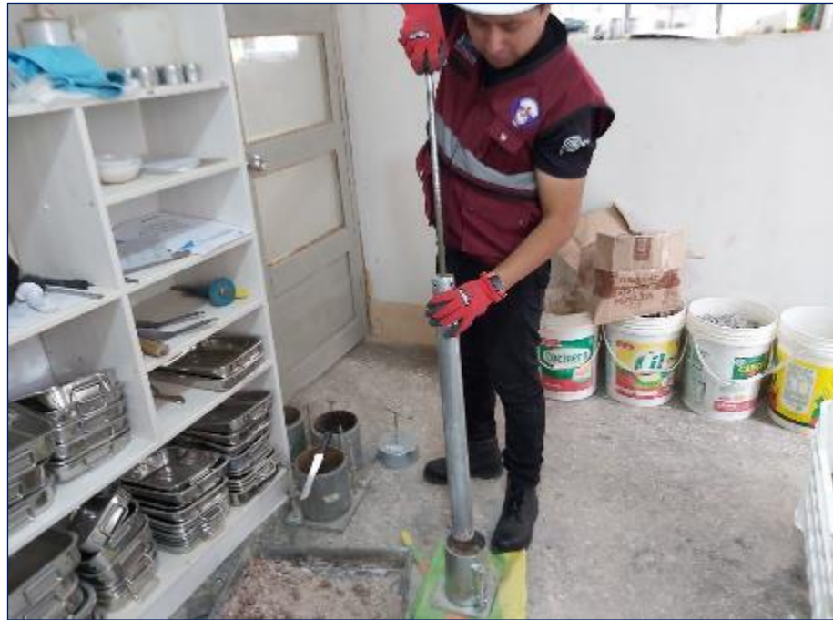
Figura 21. Método de prueba estándar para las características de compactación del suelo en el laboratorio utilizando un esfuerzo modificado según la norma NTP 339.141- ASTM D1557-12e1.
