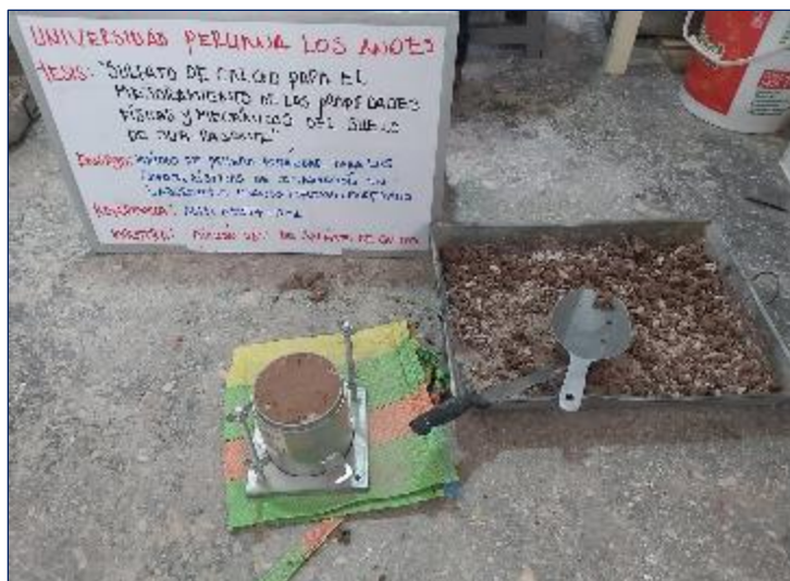
Figura 47. Preparación de la muestra de suelo+ 6% de sulfato de calcio, mediante el ensayo Proctor.
