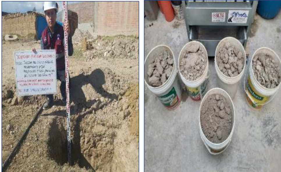
Figura 14. Práctica estándar para conservar y transportar muestras de suelo al Laboratorio según la norma ASTM D4220/D4220M-14.
