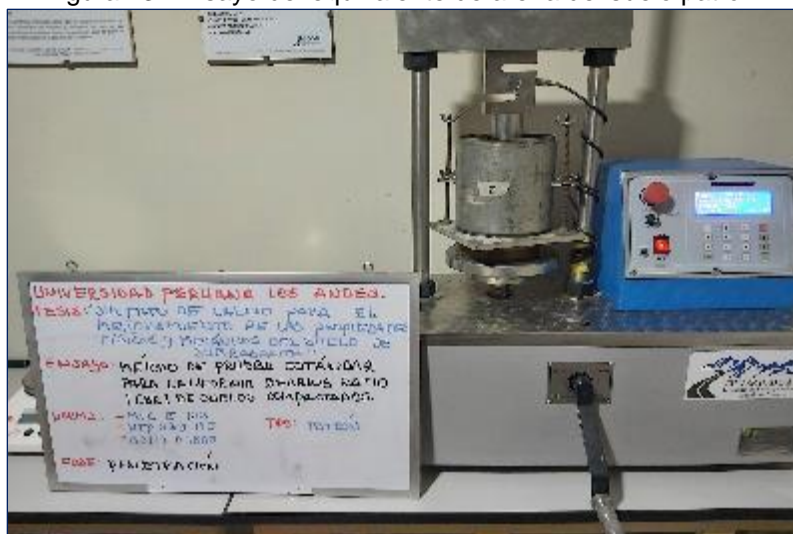
Figura 44. Ensayo de CBR del suelo patrón.
