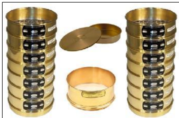
Figura 4. Tamices para el análisis granulométrico. Fuente: Villar y Oblitas (2020).
