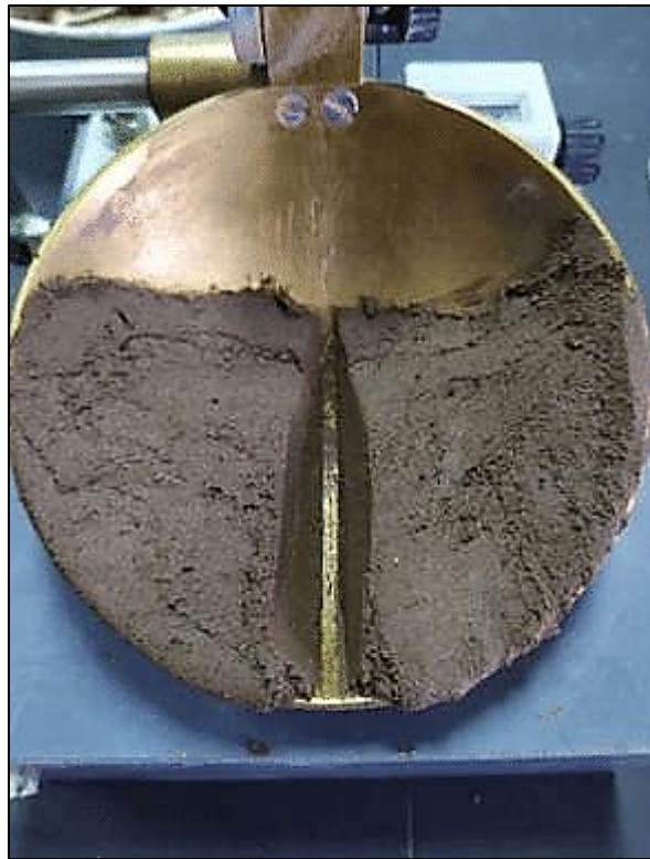
Figura 7. Copa de Casagrande para el análisis del límite líquido. Fuente: Braja (2015).
