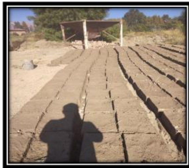
Secado de adobe puesto en el terreno libre y limpio
