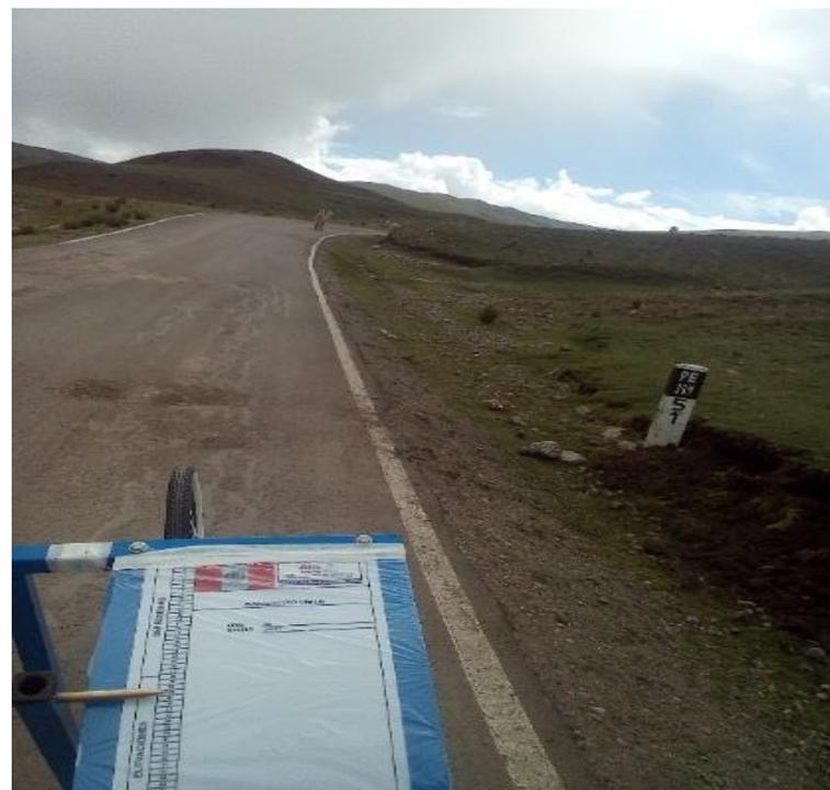
**Foto n° 31:** Vista del evaluador y asistente obteniendo los datos para el cálculo del IRI del tramo Paucará – Patoccocha.
