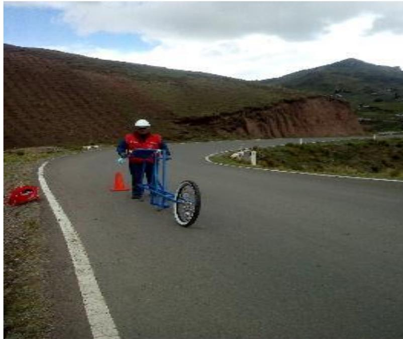
**Foto n° 34:** Evaluación del IRI en el tramo Paucará – Patoccocha utilizando todos los implementos de seguridad.
