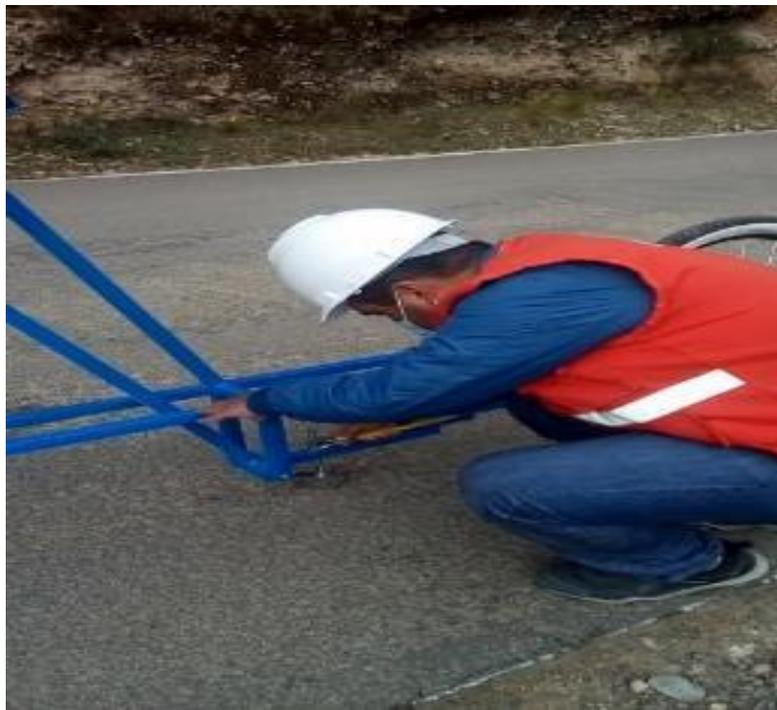
**Foto n° 26:** Tablero de marcación de los valores en el rugosímetro Merlín, marcando 25 para iniciar con la evaluación
