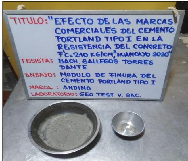
Fotografía 2. Finura del Cemento Portland Tipo I, marca ANDINO por el tamiz de 45 um, de acuerdo a la NTP 334.045
