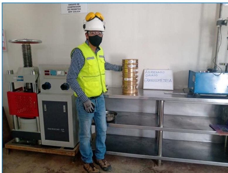
Figura 9: Análisis granulométrico agregado grueso - NTP 400.012
