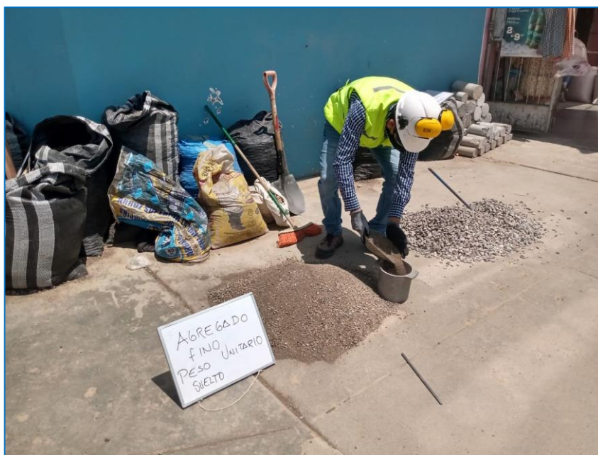
Figura 7: Peso Unitario agregado fino - NTP 400.017
