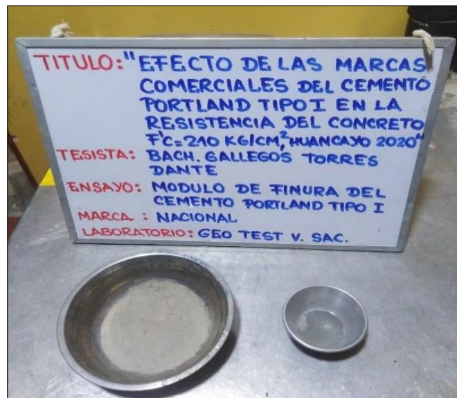
Fotografía 5: Finura del Cemento Portland Tipo I, marca NACIONAL por el tamiz de 45 \mu\text{m} , de acuerdo a la NTP 334.045.
