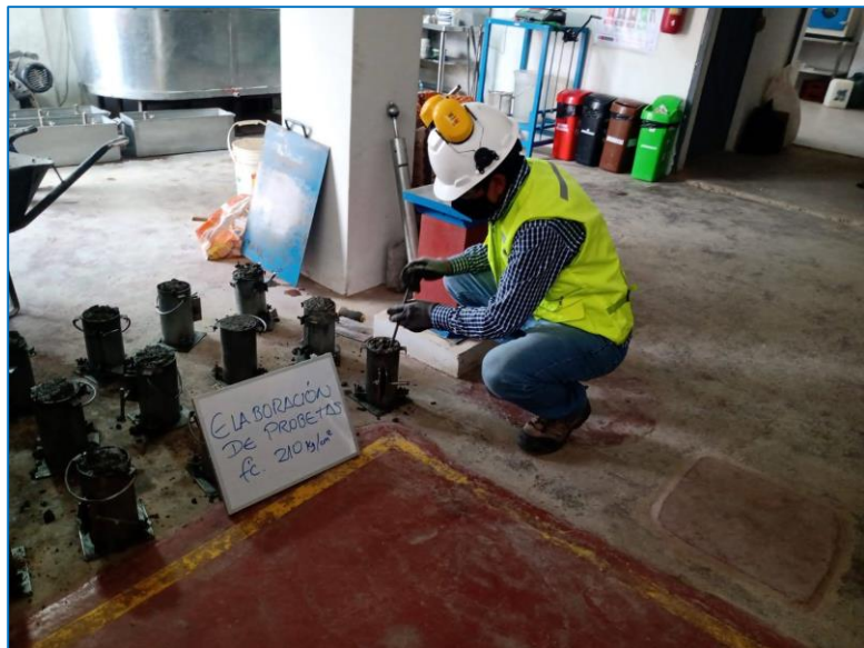
Figura 16: Elaboración de probetas para resistencia a la tracción - NTP 339.084
