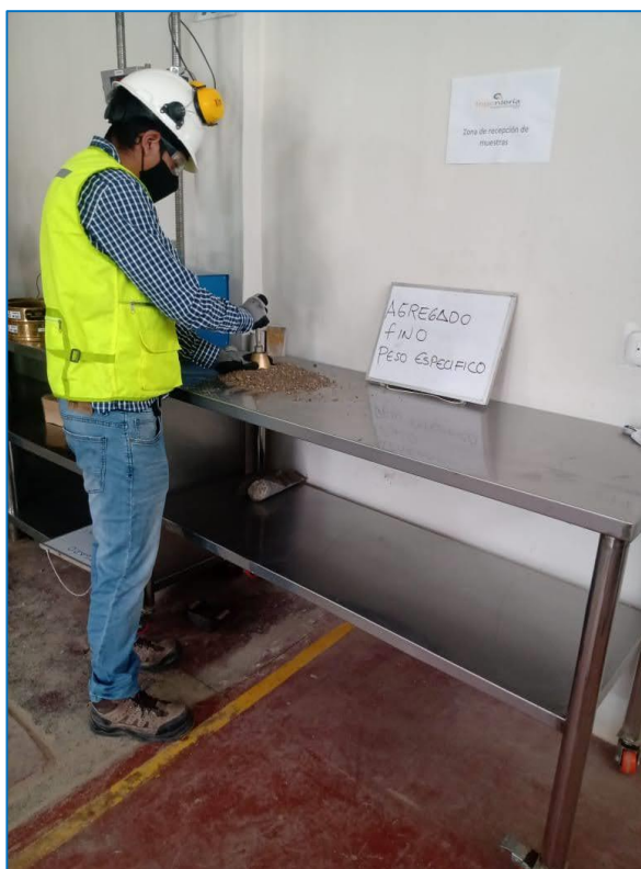
Figura 6: Peso Específico agregado fino - NTP 400.022.
