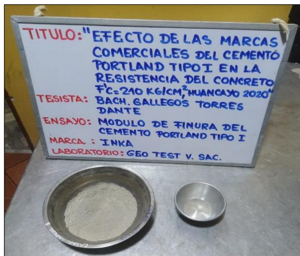
Fotografía 1: Finura del Cemento Portland Tipo I, marca INKA por el tamiz de 45 um, de acuerdo a la NTP 334.045
