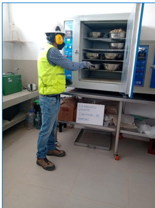
Figura 12: Contenido de Humedad agregado grueso - NTP 339.185.
