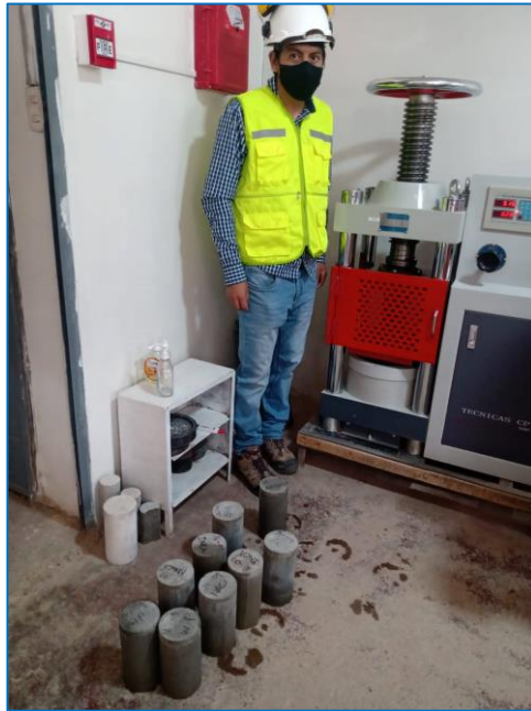
Figura 15: Ensayo de compresión del concreto - NTP 339.034
