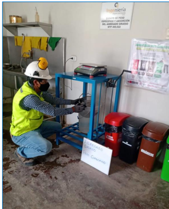
Figura 10: Peso Específico agregado grueso - NTP 400.021
