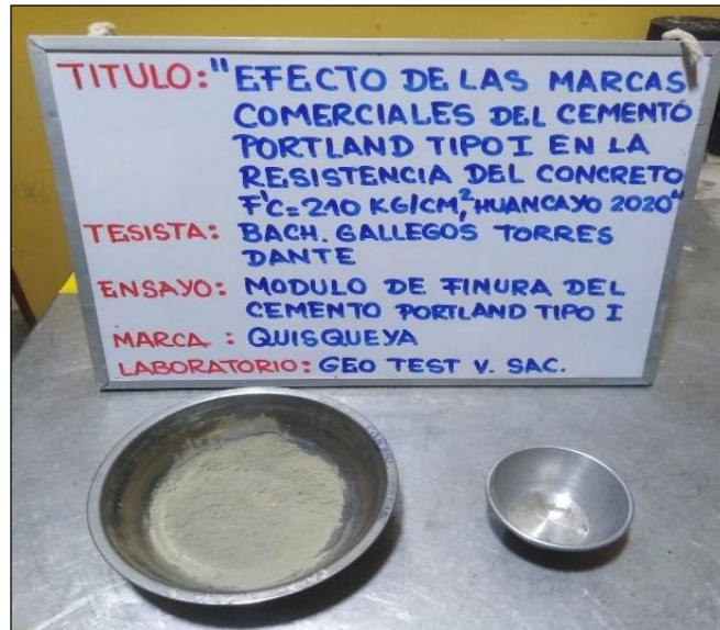
Fotografía 4: Finura del Cemento Portland Tipo I, marca QUISQUEYA por el tamiz de 45 \mu\text{m} , de acuerdo a la NTP 334.045.
