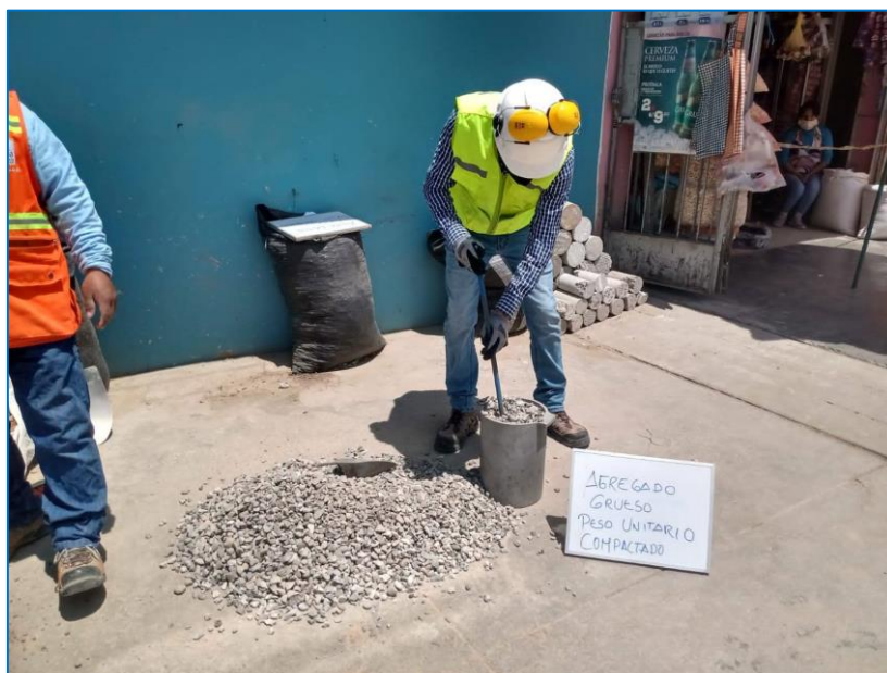
Figura 11: Peso Unitario agregado grueso - NTP 400.017
