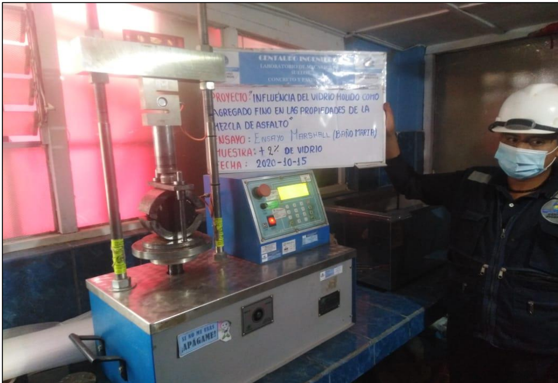
Fotografía 24. Ensayo Marshall de briquetas de MAC con 2 % de vidrio molido.
