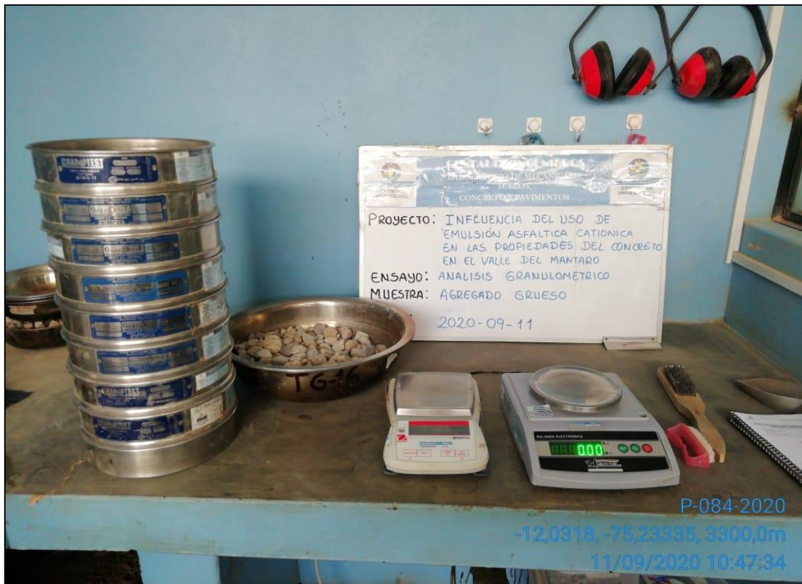
Fotografía 5. Tamizado del agregado grueso.
