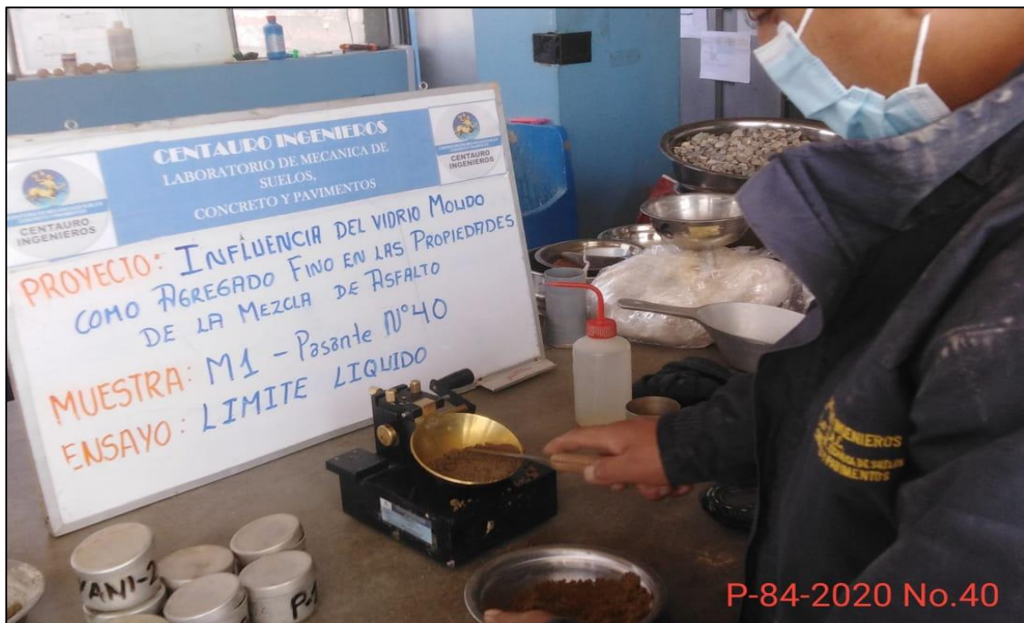
Fotografía 10. Ensayo del límite líquido con lo pasante de la malla N° 4 a N° 200.
