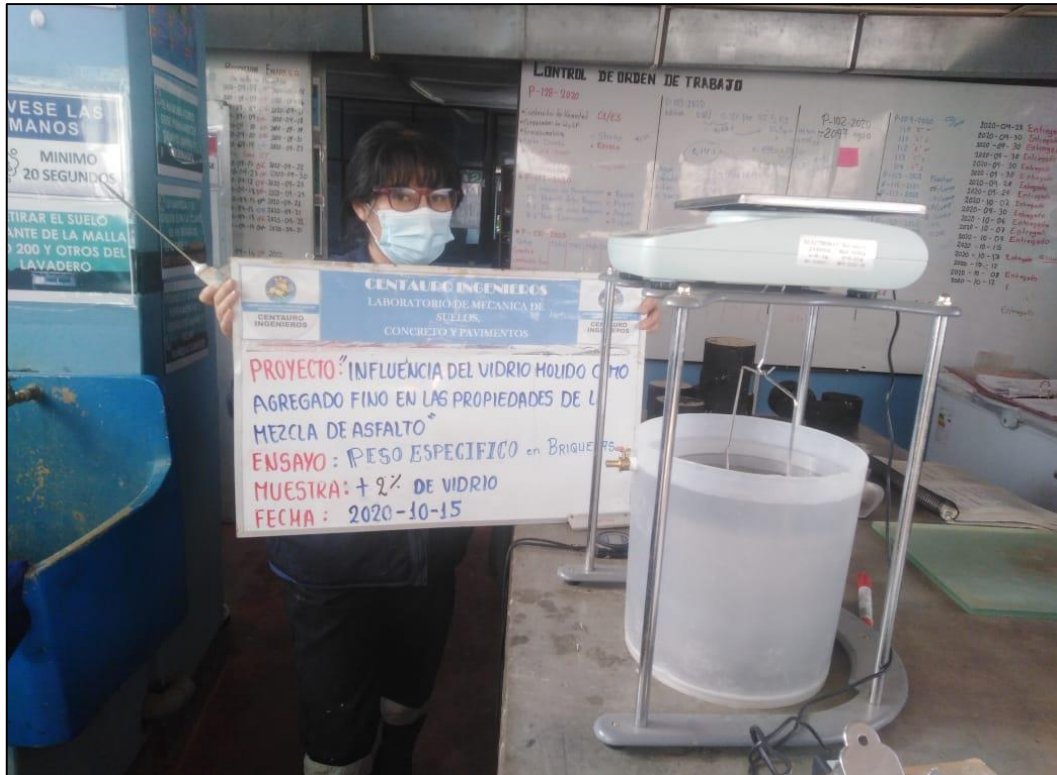
Fotografía 19. Peso específico de briquetas de MAC con 2 % de vidrio molido.
