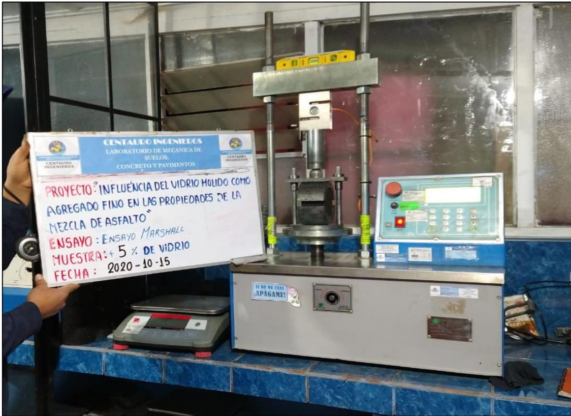
Fotografía 25. Ensayo Marshall de briquetas de MAC con 5 % de vidrio molido.
