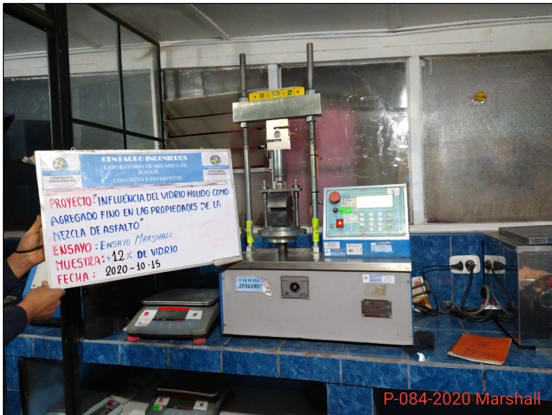
Fotografía 27. Ensayo Marshall de briquetas de MAC con 12 % de vidrio molido.
