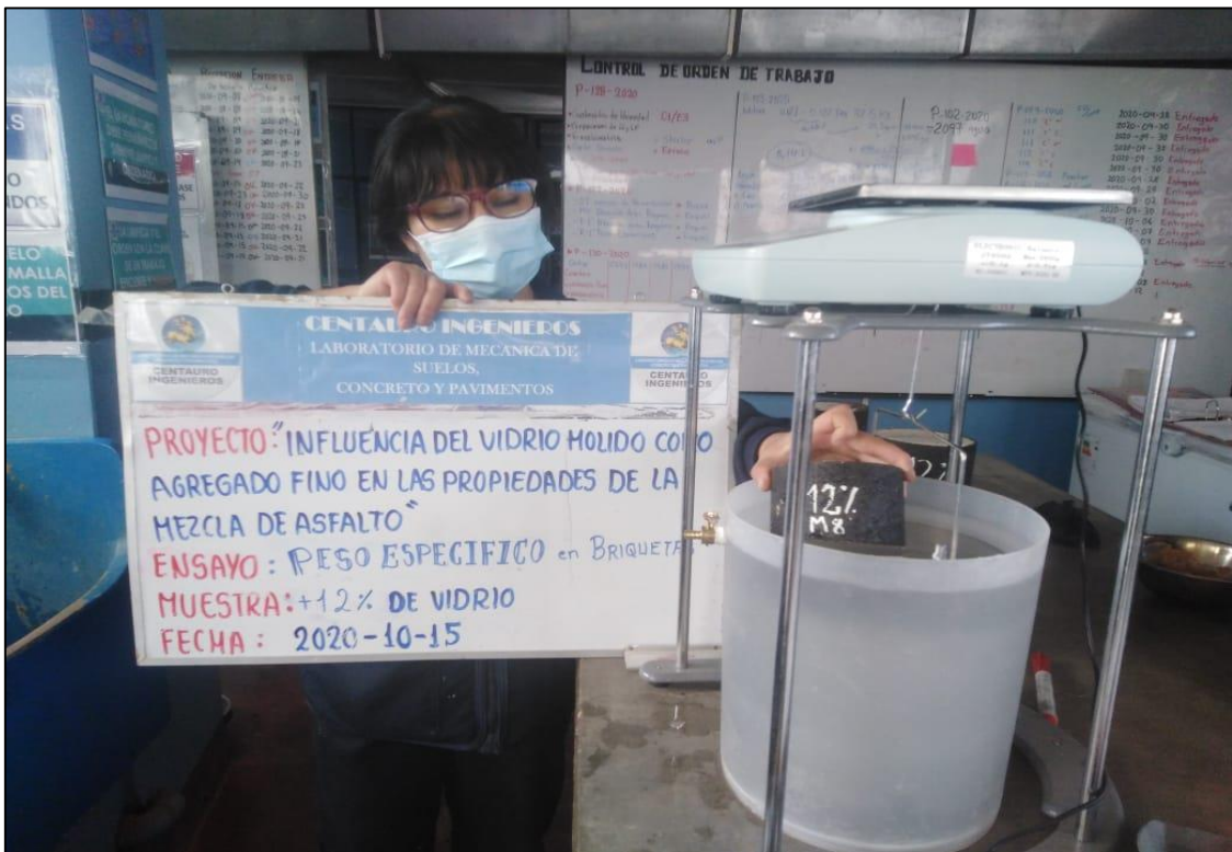
Fotografía 22. Peso específico de briquetas de MAC con 12 % de vidrio molido.
