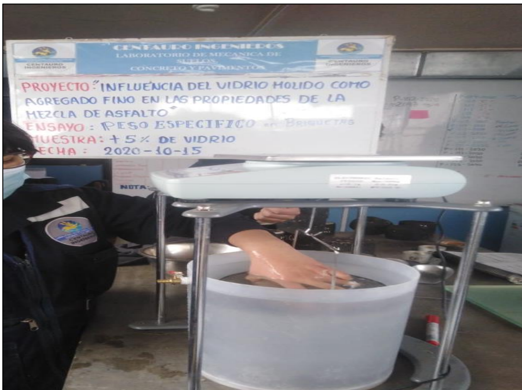
Fotografía 20. Peso específico de briquetas de MAC con 5 % de vidrio molido.
