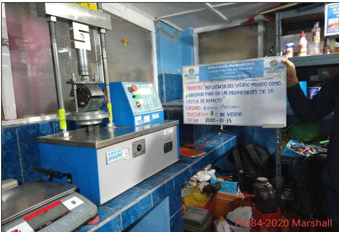
Fotografía 26. Ensayo Marshall de briquetas de MAC con 8 % de vidrio molido.
