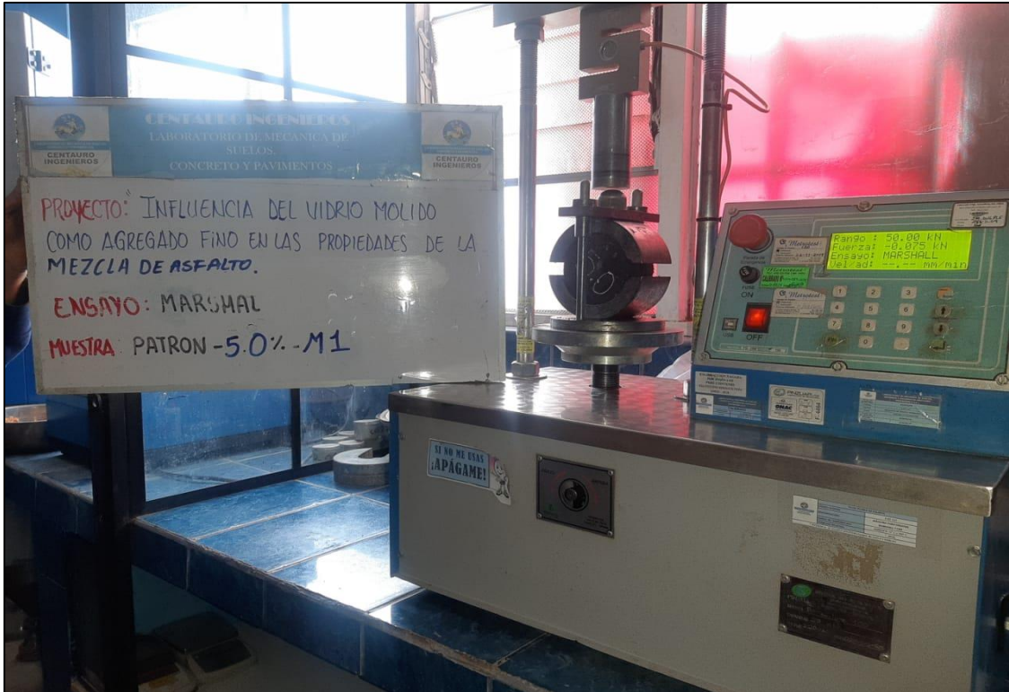
Fotografía 23. Ensayo Marshall de la mezcla asfáltica patrón.
