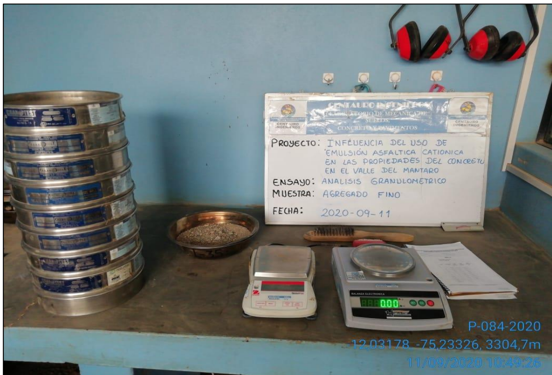
Fotografía 6. Tamizado del agregado fino.
