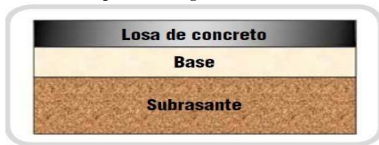
Figura N° 04 Estructura de pavimento rígido
