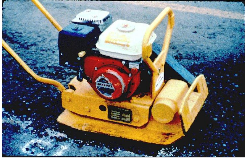
Figura N° 13: Compactado del material en el hueco.
