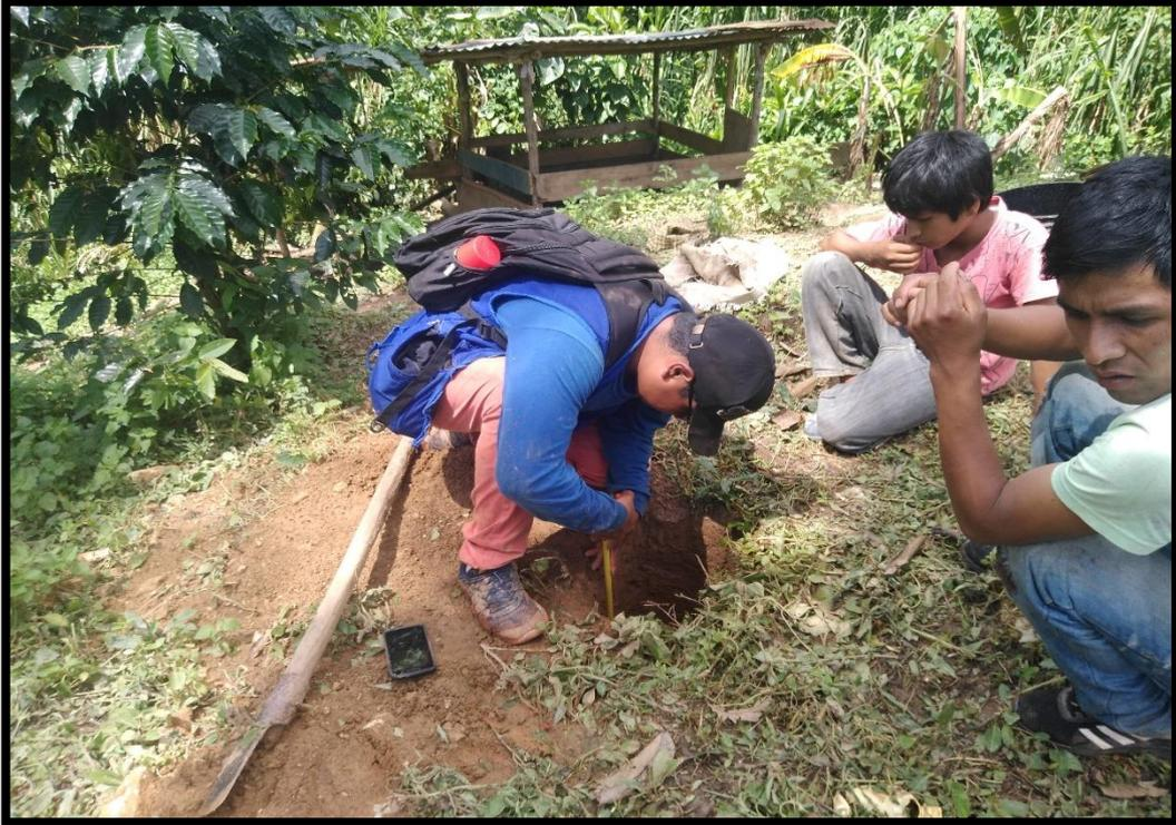
**FOTO 09** – REALIZACION DE PRUEBA DE PERCOLACION PARA LAS ZANJAS DE PERCOLACION
