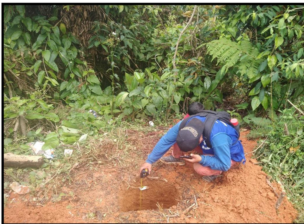
**FOTO 08 – REALIZACION DE PRUEBA DE PERCOLACION PARA LAS ZANJAS DE PERCOLACION**
