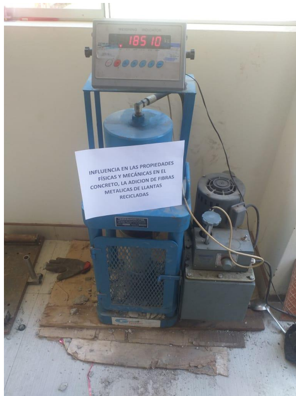
Fotografía 12. Ensayo de testigos para determinar la resistencia a la compresión.
