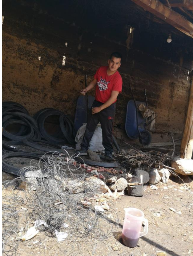
Fotografía 1. Extracción de las fibras metálicas de llantas recicladas.
