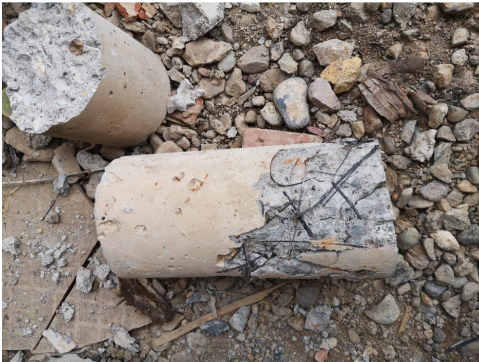
Fotografía 14. Rotura del testigo de concreto con adición al 10 % de FMLR.
