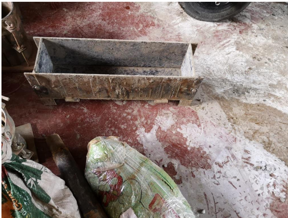
Fotografía 16. Moldes para la elaboración de las viguetas de concreto.
