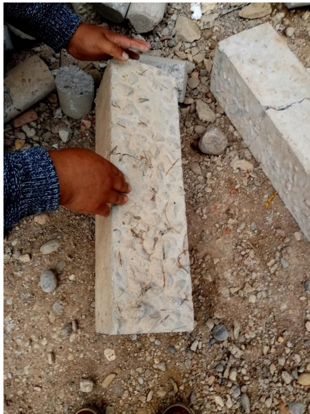
Fotografía 20. Fisura en la vigueta de concreto con 10 % de FMLR.
