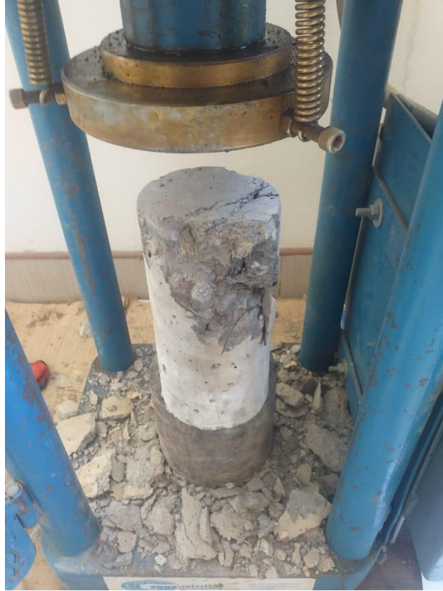
Fotografía 13. Rotura del testigo de concreto con adición al 5 % de FMLR.
