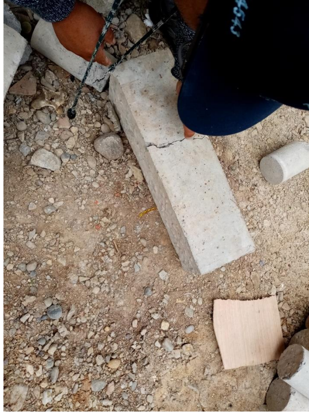
Fotografía 19. Fisura en la vigueta de concreto con 5 % de FMLR.
