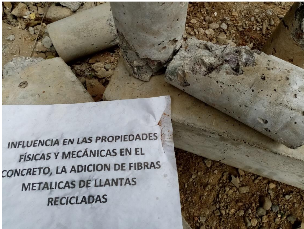
Fotografía 15. Rotura del testigo de concreto con adición al 15 % de FMLR.
