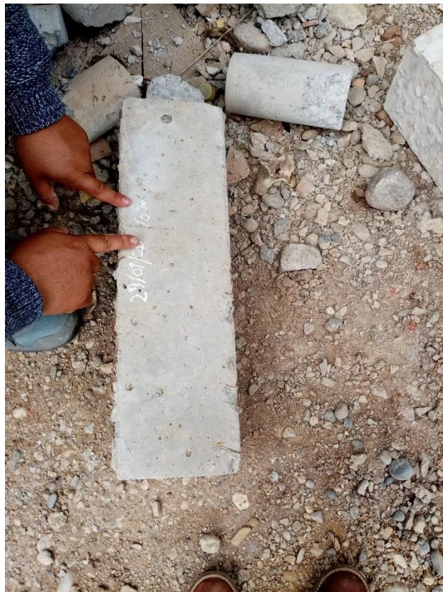
Fotografía 18. Preparación de las viguetas de concreto para el ensayo de rotura.
