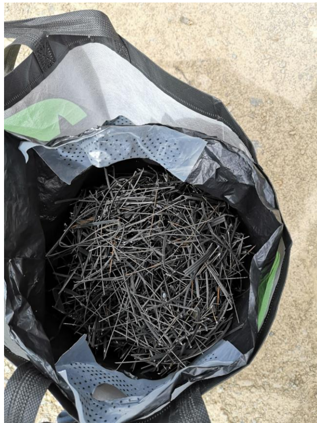
Fotografía 2. Fibras metálicas de llantas recicladas ya procesadas.
