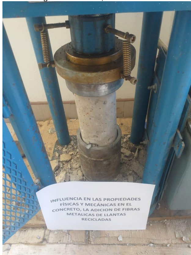
Fotografía 11. Preparación de testigos para el ensayo a compresión.
