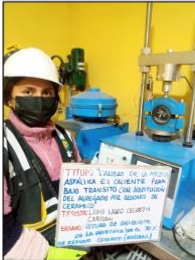
Fotografía 31. Ejecución del ensayo de estabilidad de la mezcla con 20 % de residuos de cerámico.
