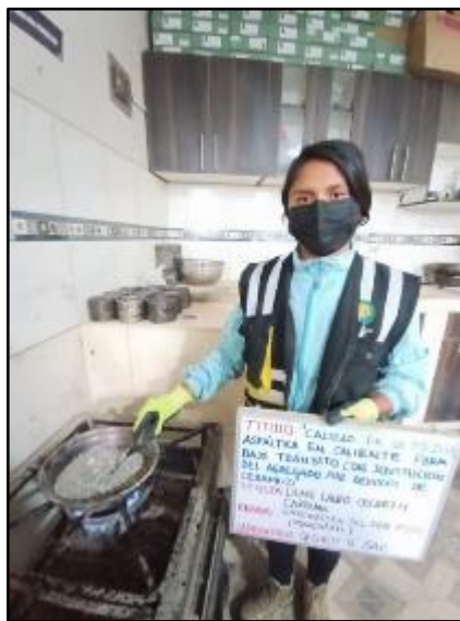
Fotografía 17. Calentamiento del agregado hasta alcanzar una temperatura de 140 °C para la mezcla según la norma ASTM D69276.
