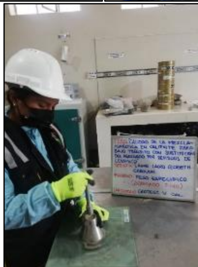
Fotografía 12. Determinación del peso específico saturado en superficie seca mediante el ensayo de peso específico del agregado fino según la norma ASTM C 128.
