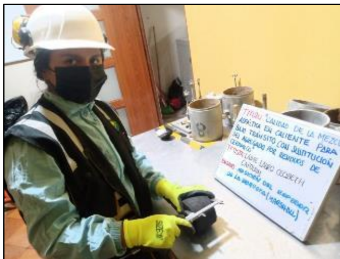
Fotografía 24. Medición del espesor del espécimen con el bernier según la norma MTC E 514.
