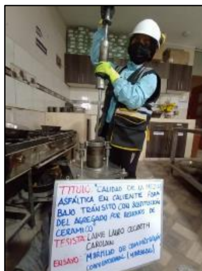
Fotografía 21. Compactación de las mezclas mediante golpes con el martillo Marshall con 35 en ambas caras.
