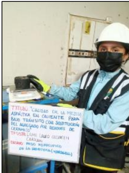
Fotografía 23. Medición del peso específico total según la norma MTC E 514.
