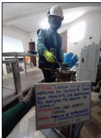
Fotografía 20. Colocación de las mezclas asfálticas en los moldes para continuar con la compactación.
