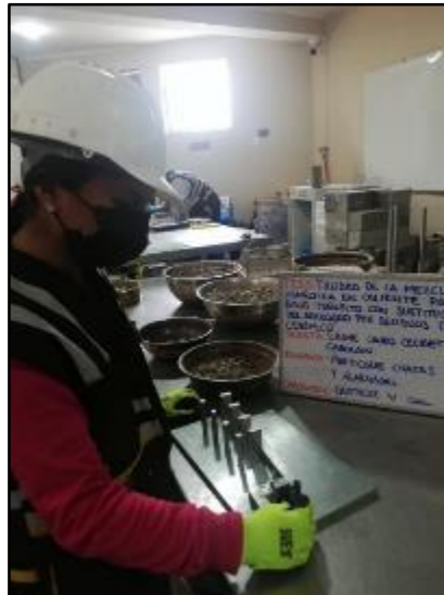
Fotografía 14. Determinación del peso requerido para ensayar cada partícula según la norma ASTM D 4791-10.
