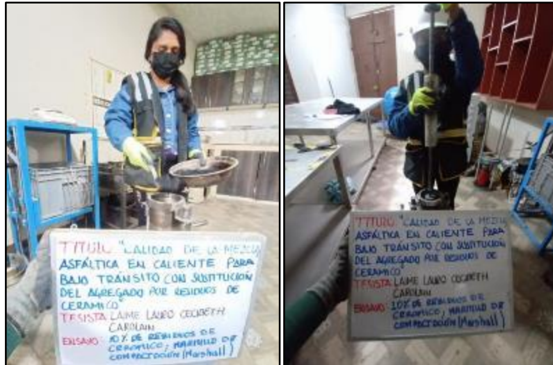
Fotografía 28. Sustitución del 10 % de residuos de cerámico en el agregado grueso para las mezclas asfálticas en calientes, además de su posterior compactación.
