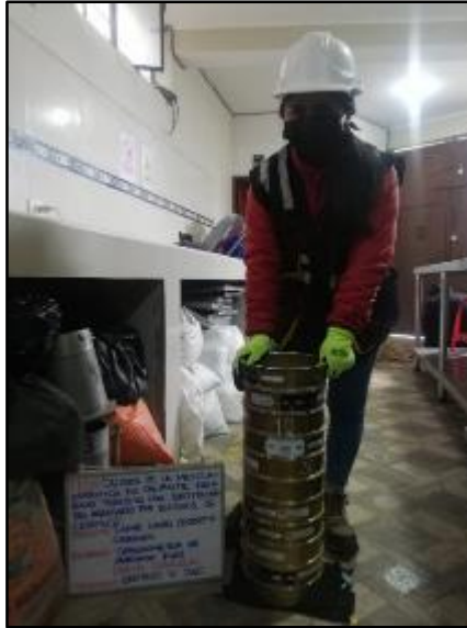
Fotografía 1. Granulometría de la arena chancada según la norma ASTM C 136.
