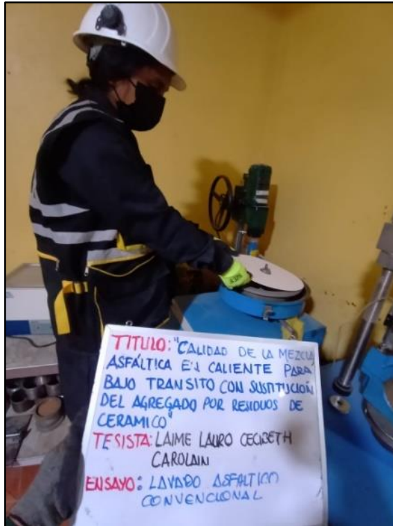
Fotografía 34. Ensayo convencional para determinar cuantitativa del asfalto en la mezcla asfáltica convencional según la norma ASTM D 2172 / ASTM D 2172 M-17e1.
