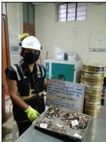
Fotografía 27. Granulometría de los residuos de cerámico para la combinación en la gradación como reemplazo del agregado grueso.
