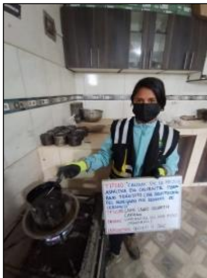
Fotografía 18. Calentamiento del cemento asfáltico hasta alcanzar una viscosidad requerida según la norma ASTM D69276.
