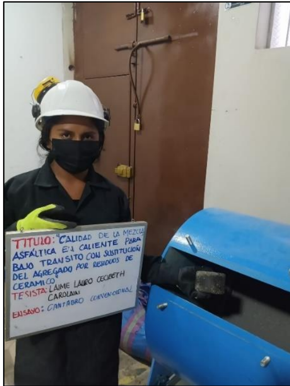
Fotografía 38. Ensayo convencional para determinar la pérdida de cohesión por la acción del agua sobre las mezclas bituminosas compactadas según la norma NLT-362/92.
