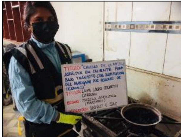
Fotografía 19. Mezclado del agregado y el cemento asfáltico hasta logra que las partículas del agregado estén revestidas.
