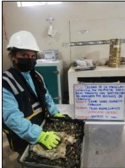
Fotografía 11. Determinación del peso específico aparente y la absorción del agregado grueso mediante el ensayo del peso específico según la norma ASTM C 127.
