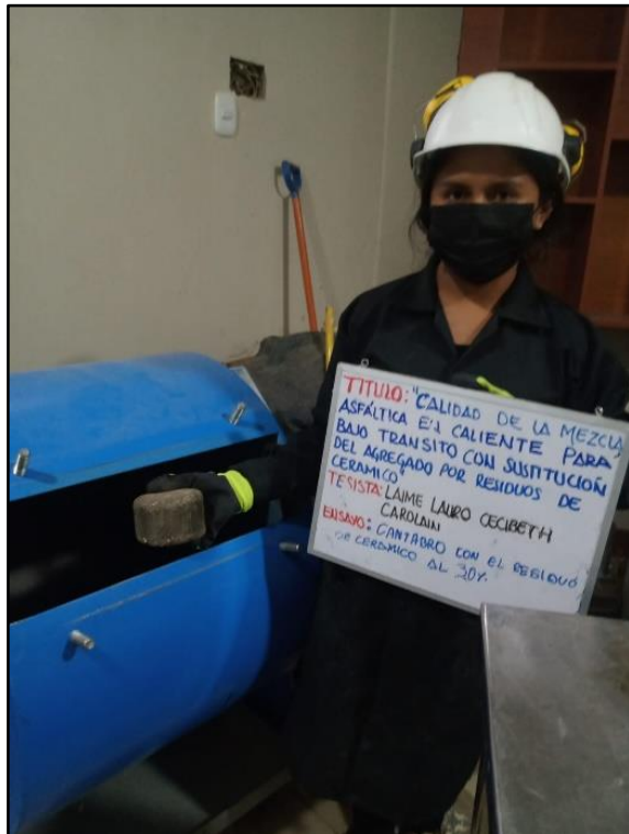
Fotografía 41. Ensayo sustituyendo el 30 % de residuos de cerámico para determinar la pérdida de cohesión por acción del agua sobre la mezcla bituminosa compactada, norma NLT-362/92.
