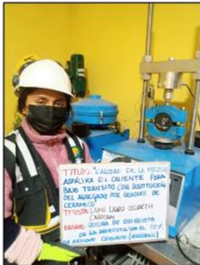
Fotografía 26. Ejecución del ensayo de estabilidad.
