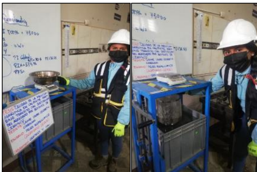
Fotografía 10. Determinación de la densidad de la masa mediante el ensayo del peso específico seco del agregado grueso según la norma ASTM C 127.
