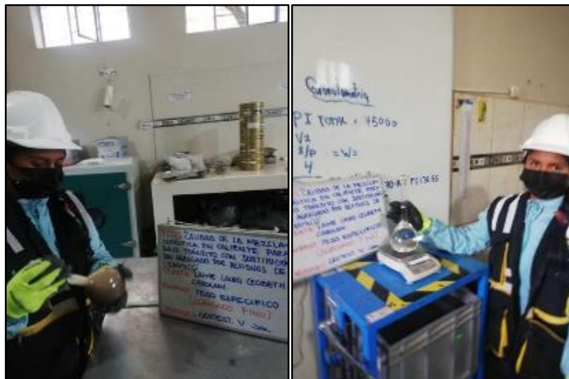
Fotografía 11. Determinación del peso específico aparente y la absorción del agregado grueso mediante el ensayo del peso específico según la norma ASTM C 127.
