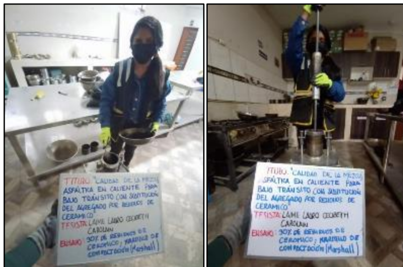
Fotografía 32. Sustitución del 30 % de residuos de cerámico en el agregado grueso para las mezclas asfálticas en calientes, además de su posterior compactación.
