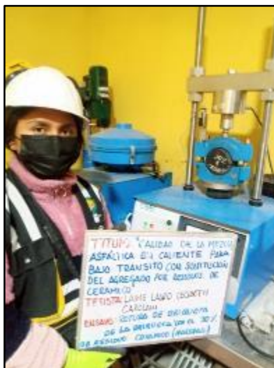
Fotografía 33. Ejecución del ensayo de estabilidad de la mezcla con 30 % de residuos de cerámico.
