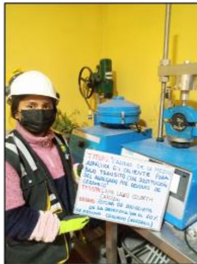
Fotografía 29. Ejecución del ensayo de estabilidad de la mezcla con 10 % de residuos de cerámico.
