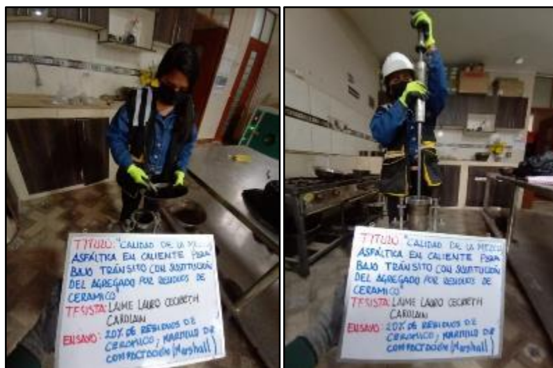
Fotografía 30. Sustitución del 20 % de residuos de cerámico en el agregado grueso para las mezclas asfálticas en calientes, además de su posterior compactación.
