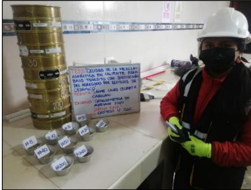
Fotografía 4. Muestreo del material por el tamizado, para la granulometría de la arena fina según la norma ASTM C 136 – AASHTO T 88.
