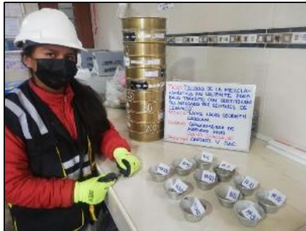
Fotografía 2. Muestreo del material por el tamizado, para la granulometría de la arena chancada según la norma ASTM C 136 – AASHTO T 88.
