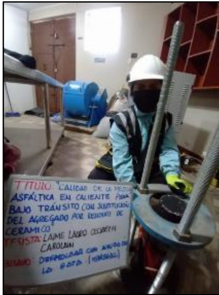
Fotografía 22. Enfriado y extracción de moldes después de la compactación.
