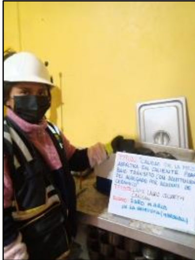
Fotografía 25. Acondicionamiento en agua los especímenes del Marshall ( 60 \pm 1 \text{ }^\circ\text{C} ) por 30 a 40 min, para su posterior remoción, secado y colocado rápidamente en el equipo Marshall.
