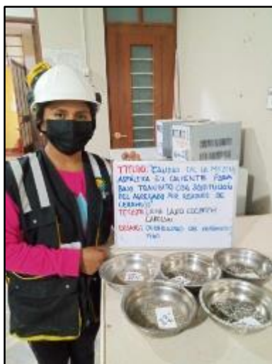
Fotografía 8. Ensayo de durabilidad al sulfato de sodio y sulfato de magnesio del agregado fino según la norma (ASTM C 88M-18 – AASHTO T 104).
