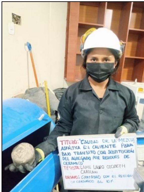
Fotografía 39. Ensayo sustituyendo el 10 % de residuos de cerámico para determinar la pérdida de cohesión por acción del agua sobre la mezcla bituminosa compactada, norma NLT-362/92.
