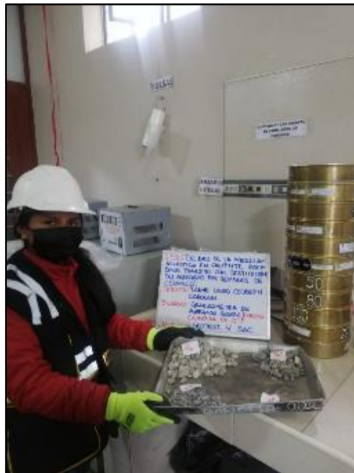
Fotografía 5. Granulometría de la grava 1/2" según la norma ASTM C 136 – AASHTO T 88.
