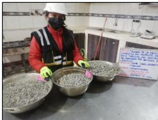
Fotografía 15. Diseño de mezcla asfáltica con la combinación de agregados según la norma ASTM D 1559.
