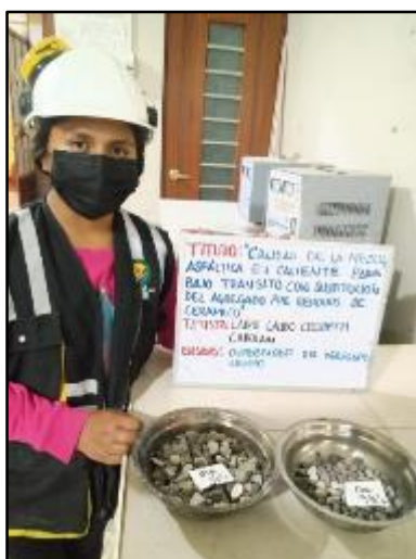
Fotografía 7. Ensayo de durabilidad al sulfato de sodio y sulfato de magnesio del agregado grueso según la norma ASTM C 88M-18 – AASHTO T 104.
