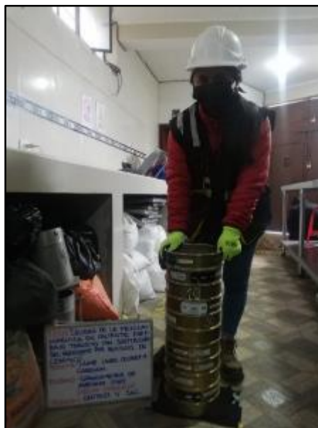
Fotografía 3. Granulometría de la arena fina según la norma ASTM C 136 – AASHTO T 88.
