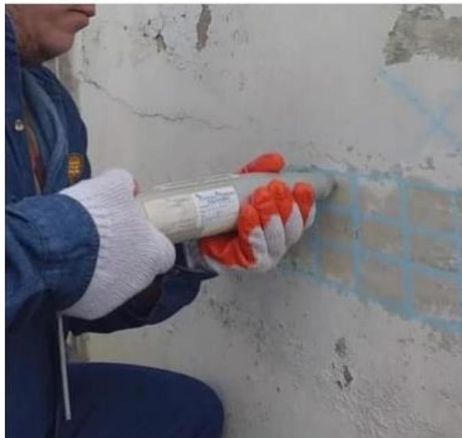
**Fotografía 12.** *Ensayo con esclerómetro en Viga y losa.*
