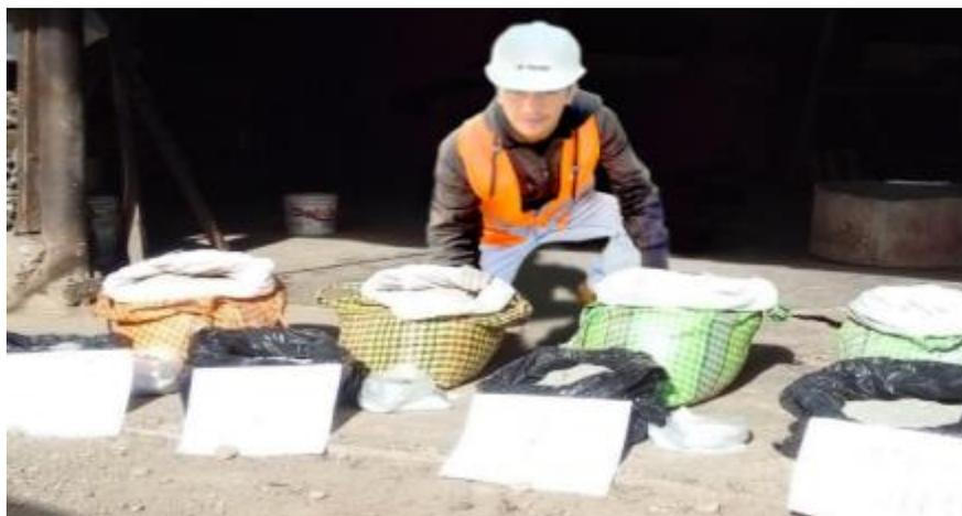
**Figura 23:** “Incorporación de polietileno tereftalato y otros materiales en la mezcla”
