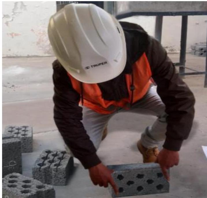
**Fotografía N° 23:** “Medición de la longitud, ancho y alto de las 4 muestras (patrón,3%, 5%, 10% PET) de las unidades Fuente: elaboración propia”.
