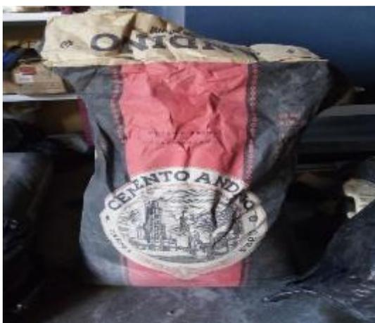
**Fotografía N° 03:** “Cemento andino tipo I para la elaboración de las unidades dealbañilería”
