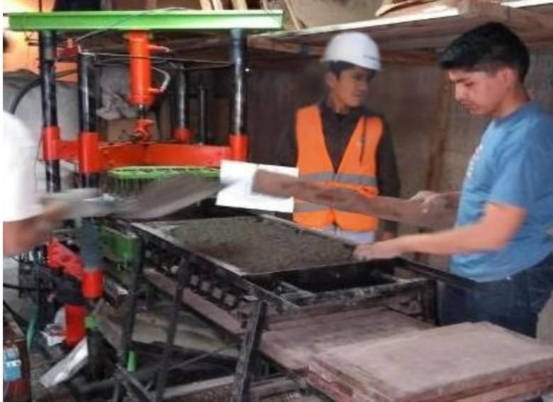
**Fotografía N° 18:** “Colocación de la mezcla en la máquina para el vibrado y fabricación de las unidades Fuente: elaboración propia”
