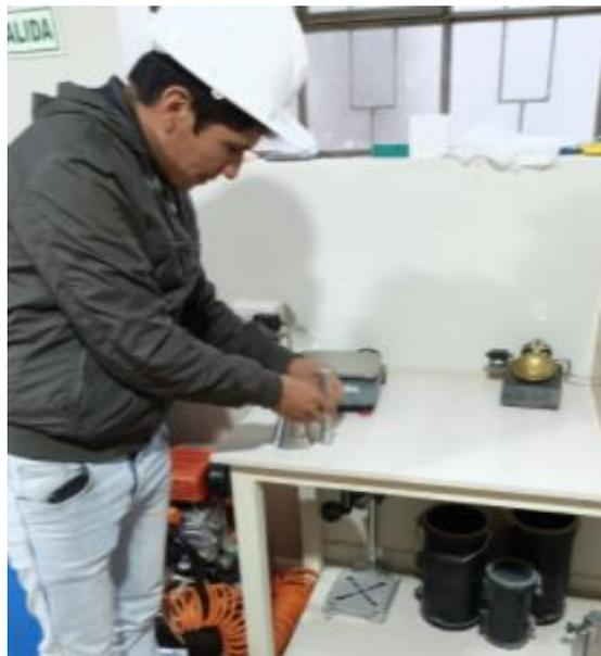
**Fotografía N° 09:** “Compactación del material en el molde cónico”
