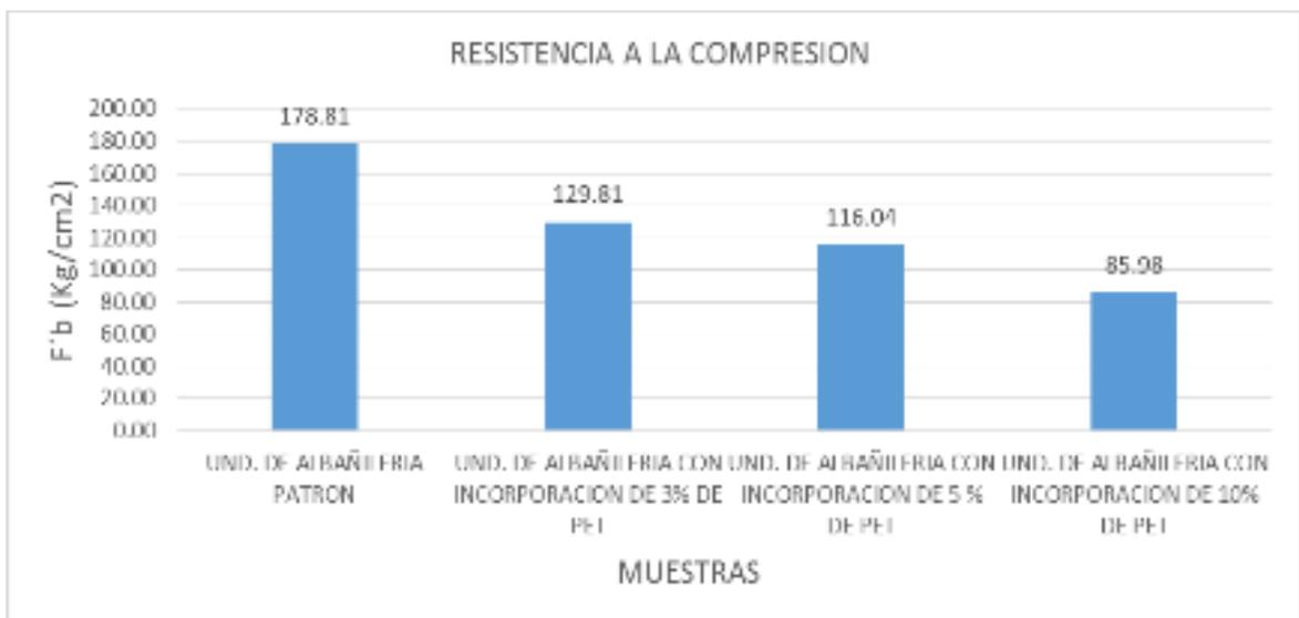
**Figura 45:** “Resultado: unidad de albañilería patrón ( $F_b=178.81 \text{ Kg/cm}^2$ ), con incorporación de 3% de PET ( $F_b=129.81 \text{ Kg/cm}^2$ ), con incorporación de 5% de PET ( $F_b=116.04 \text{ Kg/cm}^2$ ), con incorporación de 10% de PET un ( $F_b=85.98 \text{ Kg/cm}^2$ ), observando que a medida que se aumenta la incorporación de PET, la resistencia va disminuyendo”.
