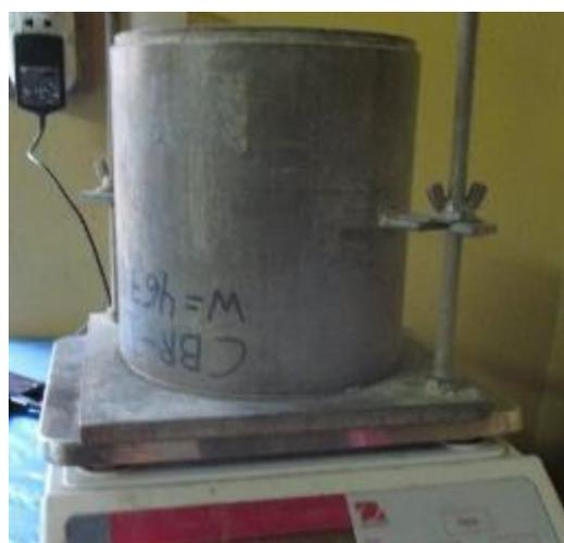
**Fotografía N° 07:** “Ensayo de peso unitario seco compactado del agregado fino(peso del recipiente que contiene el agregado)”.
