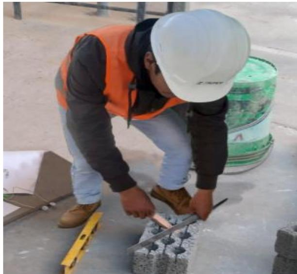
**Fotografía N° 24:** “Medición de concavidad (cara superior)) de las 4 muestras (patrón, 3%, 5%, 10% PET) de las unidades Fuente: elaboración propia”.
