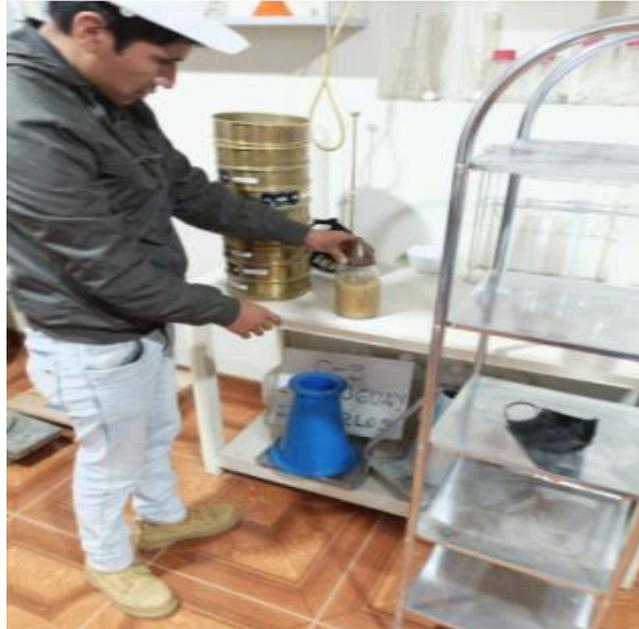
**Fotografía N° 08:** “Colocación de la muestra en el picnómetro”
