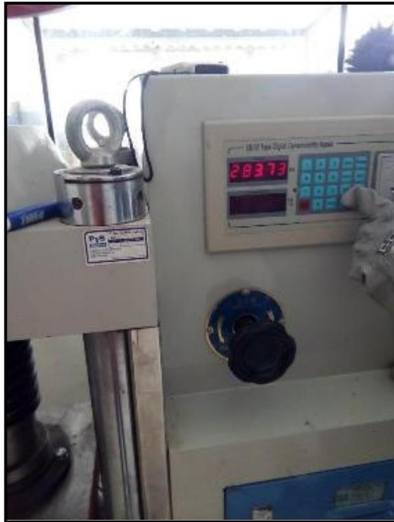
**Fotografía N° 30:** “Resultado de la unidad de albañilería con incorporación de 5 % PET Fuente: elaboración propia.”
