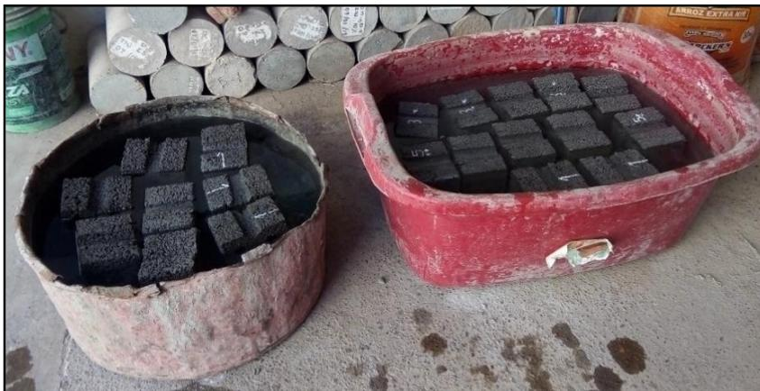
“Ensayos a las unidades de albañilería Ensayo de variación dimensional”
