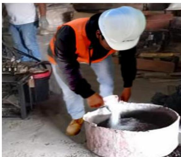
**Figura 24:** “Verificación del asentamiento (consistencia seca de la mezcla), poco trabajable”
