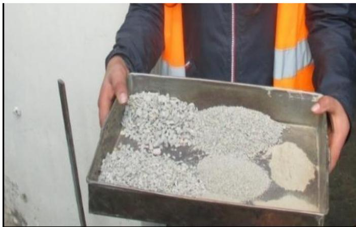
✓ **Contenido de humedad total de agregado fino (NTP 339.185, 2013).**
