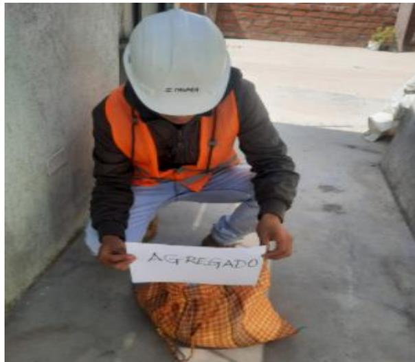
**Fotografía N° 02:** “Secado del agregado fino para realizar los ensayos Fuente: elaboración propia”.
