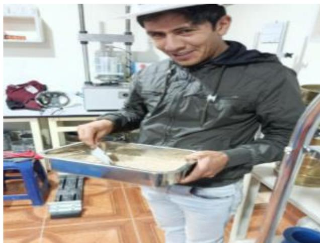
**Fotografía N° 04:** “Material retenido en los tamices (ensayo granulométrico del agregado fino)”
