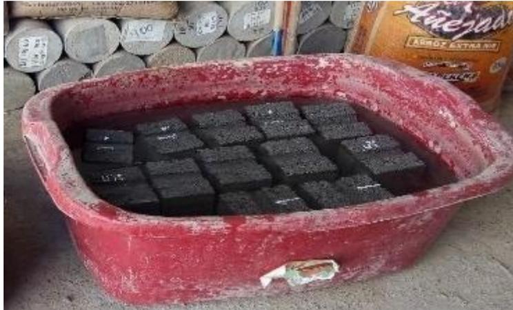
**Fotografía N° 27:** “Unidades sumergidas por 24 horas, 4 muestras (patrón, 3%, 5%, 10% PET) Fuente: elaboración propia”.
