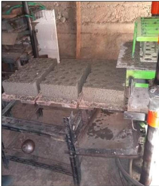
**Figura 27:** “Ladrillo de concreto con incorporación de polietileno”
