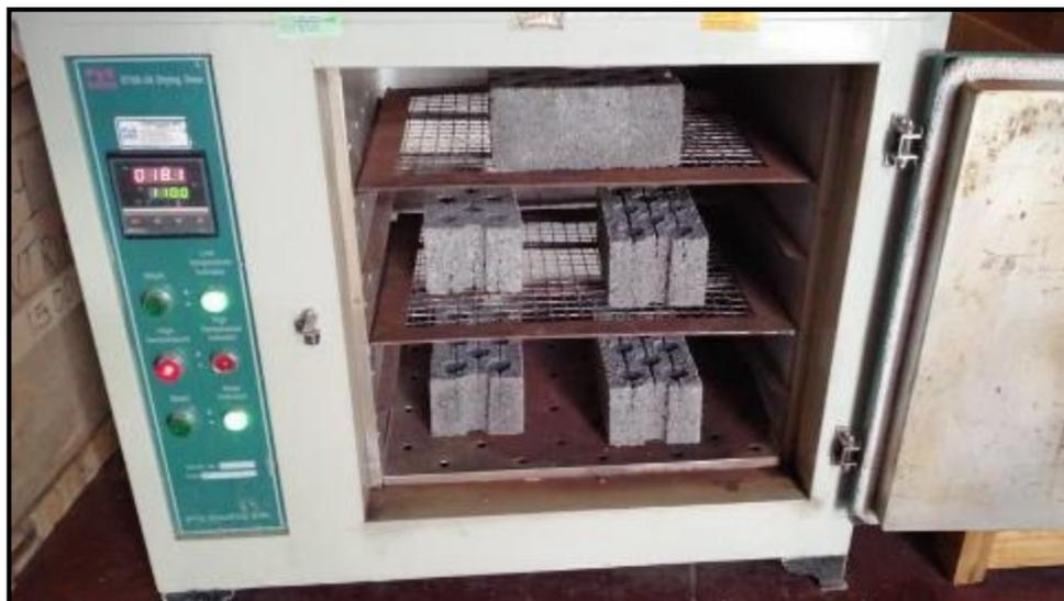
**Fotografía N° 26:** “Secado al horno por 24 horas de las 4 muestras (patrón, 3%, 5%, 10% PET) de las unidades Fuente: elaboración propia”.
