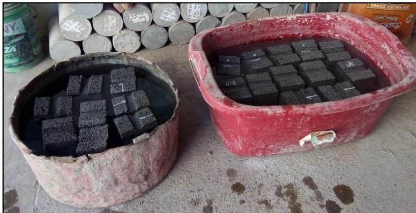
*Figura 37: “Peso del ladrillo sumergido 24 horas”*
