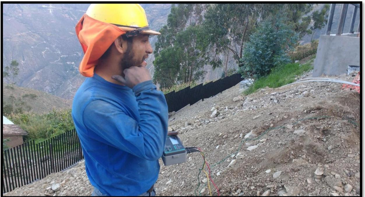
**SE OBSERVA EN LA IMAGEN NRO. 12 LAS PRUEBAS ELECTRICAS PARA POZO A TIERRA, LECTURA DE CONTUCTIVIDAD CON EL TELUOMETRO.**
