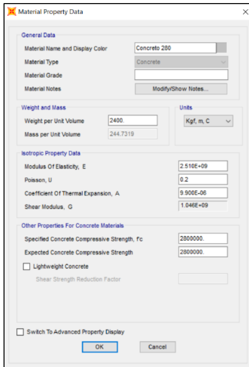
Figura 63. Creación del material concreto 280 kg/cm 2
