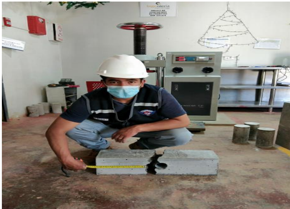
Medida de rotura central de la probeta prismática de 2"
