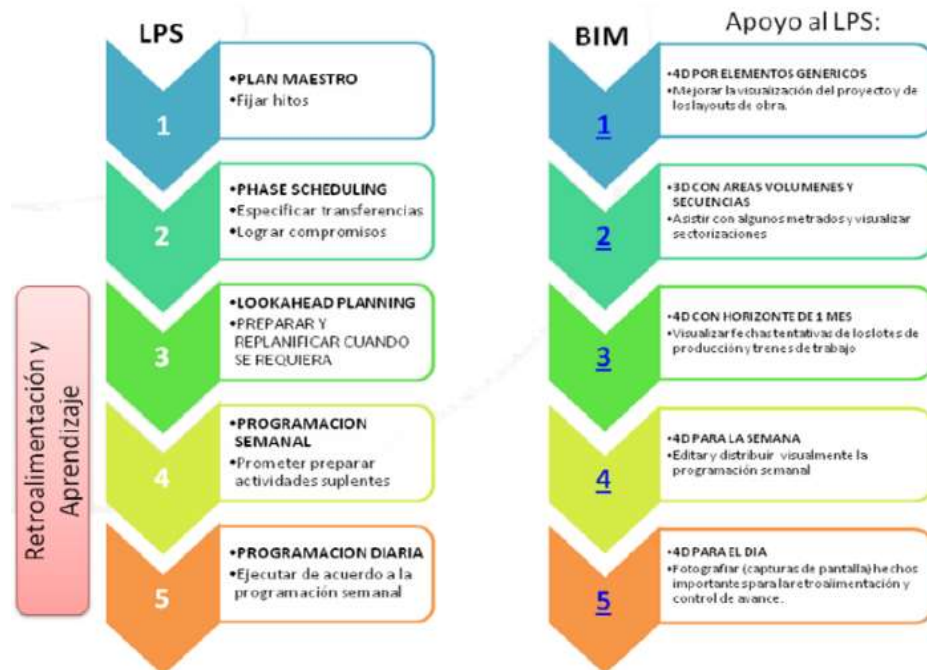
Figura 20: Aplicación LPS y BIM
