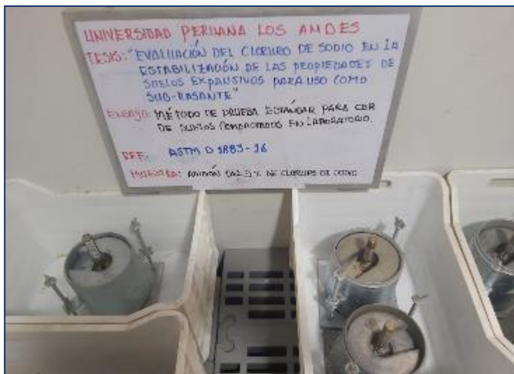
Fotografía 26. Ensayo para CBR de suelo con 5 % de cloruro de sodio.
