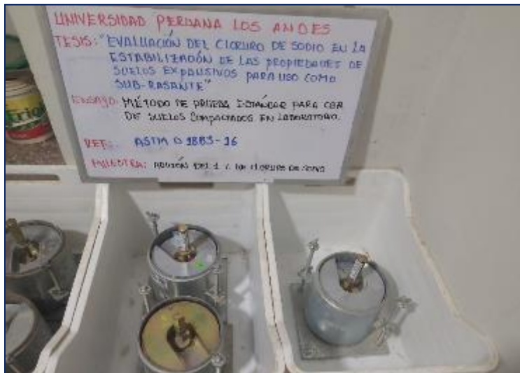
Fotografía 25. Ensayo para CBR de suelo con 1 % de cloruro de sodio.
