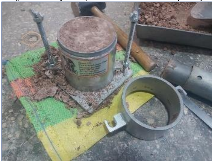
Fotografía 8. Ensayo de compactación para el suelo patrón.
