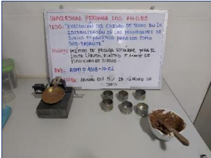
Fotografía 19. Ensayo de límite líquido y límite plástico del suelo con 5 % de cloruro de sodio.
