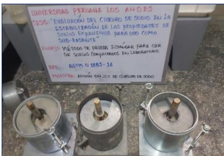
Fotografía 27. Ensayo para CBR de suelo con 10 % de cloruro de sodio.
