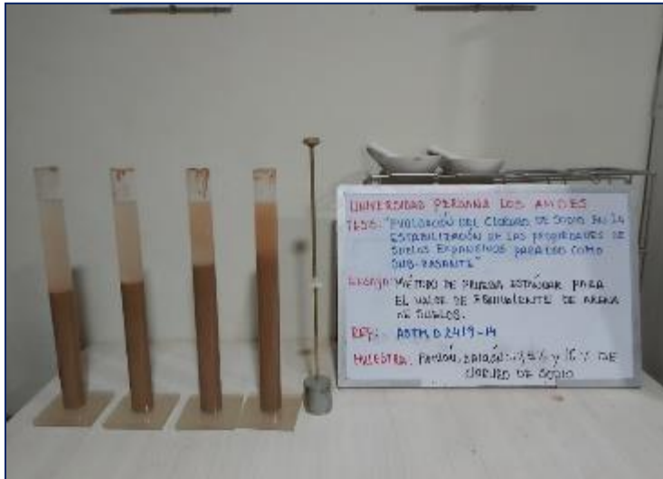
Fotografía 7. Ensayo de equivalente de arena del suelo patrón y suelos con 1 %, 5 % y 10 % de NaCl.
