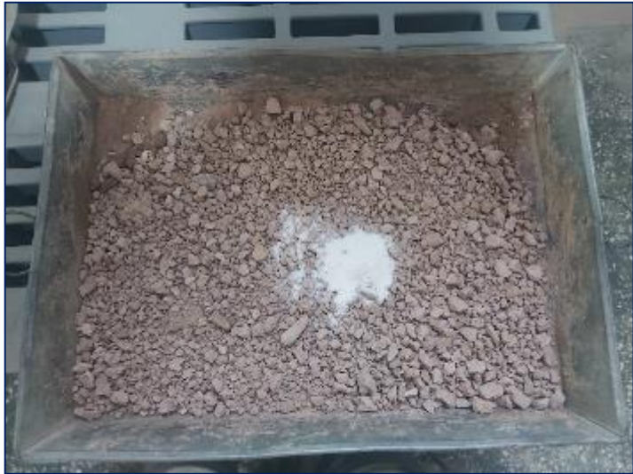
Fotografía 21. Combinación del suelo con 1 % de cloruro de sodio para el ensayo de Proctor modificado.
