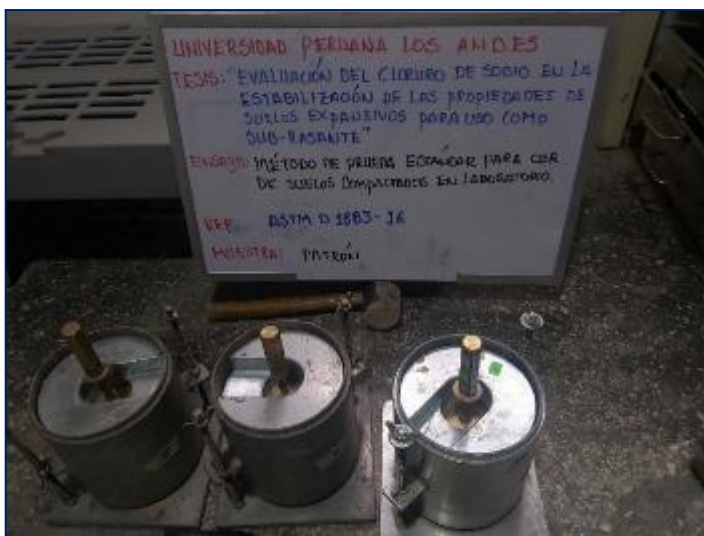
Fotografía 9. Ensayo para CBR del suelo patrón.
