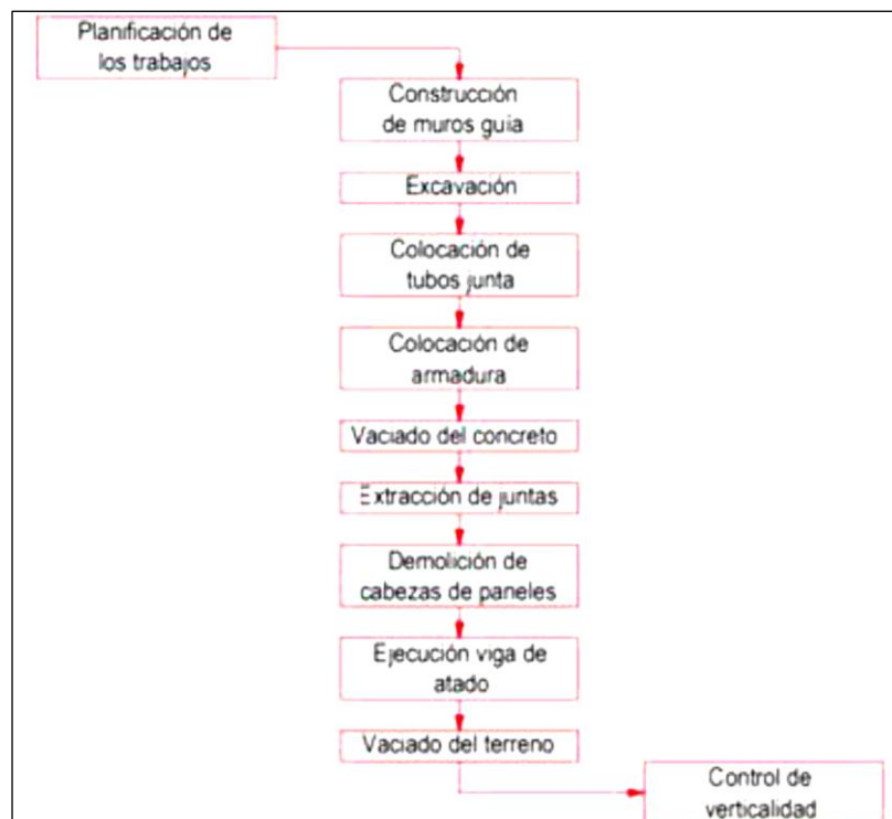
Ilustración 10. Fases de la construcción.
