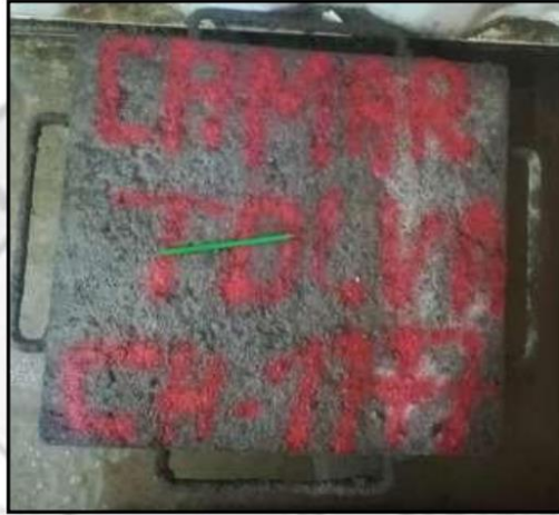
Figura 21: Muestra de SH tomada durante el lanzamiento de la misma en la cámara para tolva - CH 1777 – Túnel integración.
