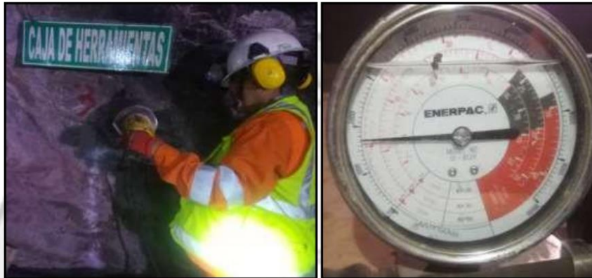
Figura 17: En el hastial derecho se colocó PH de sólo 3 pies (Mecha en el Collarín) con 2 resina. A los 10 minutos se realizó la prueba de arranque. El resultado obtenido fue de 7 Tn realizado por CASTEM en compañía del geomecánico y jefe de guardia de SEPROCAL.
