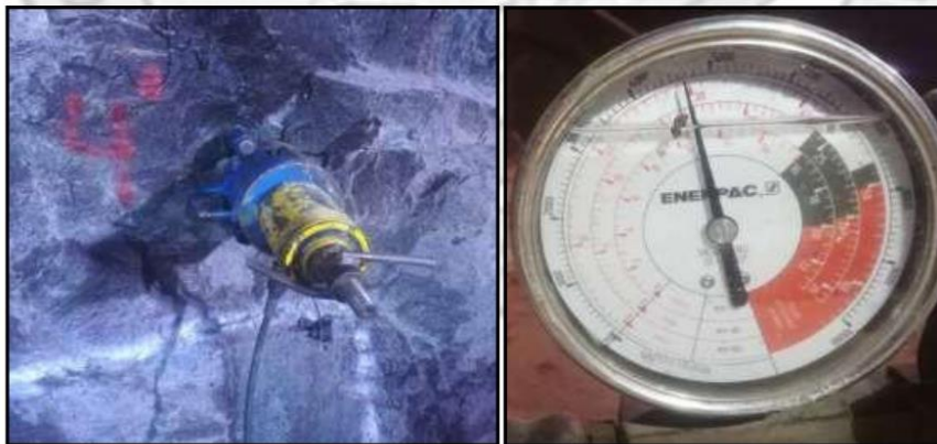
Figura 18: En el hastial derecho se colocó PH de sólo 4 pies (Mecha en el Collarín) con 2 resina. A los 10 minutos se realizó la prueba de arranque. El resultado obtenido fue de 15 Tn realizado por CASTEM en compañía de geomecánico y jefe de guardia de SEPROCAL.
