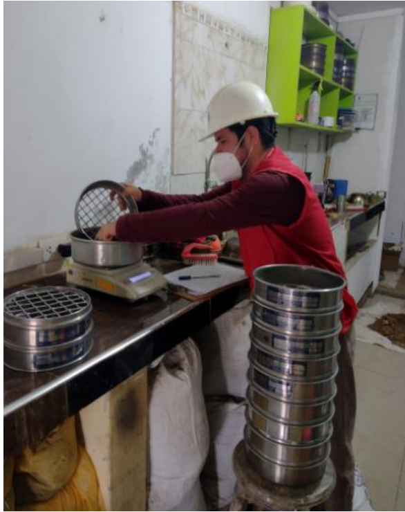
Figura 6: Muestra de tamizado
