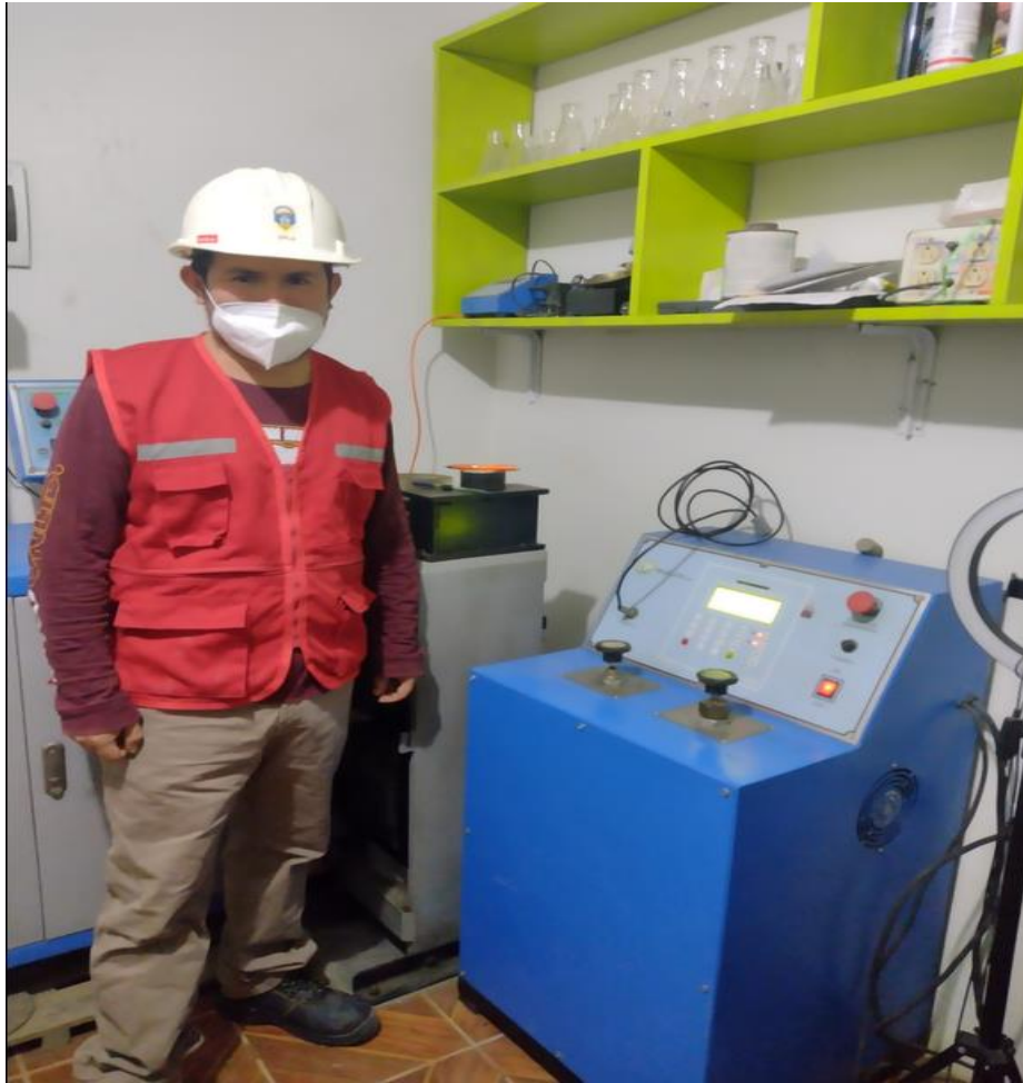
Figura 12: Equipo para medición de la compresión de las muestras de concreto.
