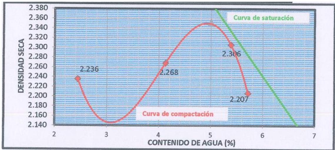
Después de haber determinado el contenido de agua y densidad seca, mediante el ensayo de CBR (California Bearing Ratio) se determinó la resistencia al corte de la muestra con una dosificación de aceite sulfonado al +0.5%. El ensayo de CBR para la muestra con una dosificación de aceite sulfonado al +0.5% se realizó en las condiciones controladas de humedad y densidad establecidas en la tabla 44.
