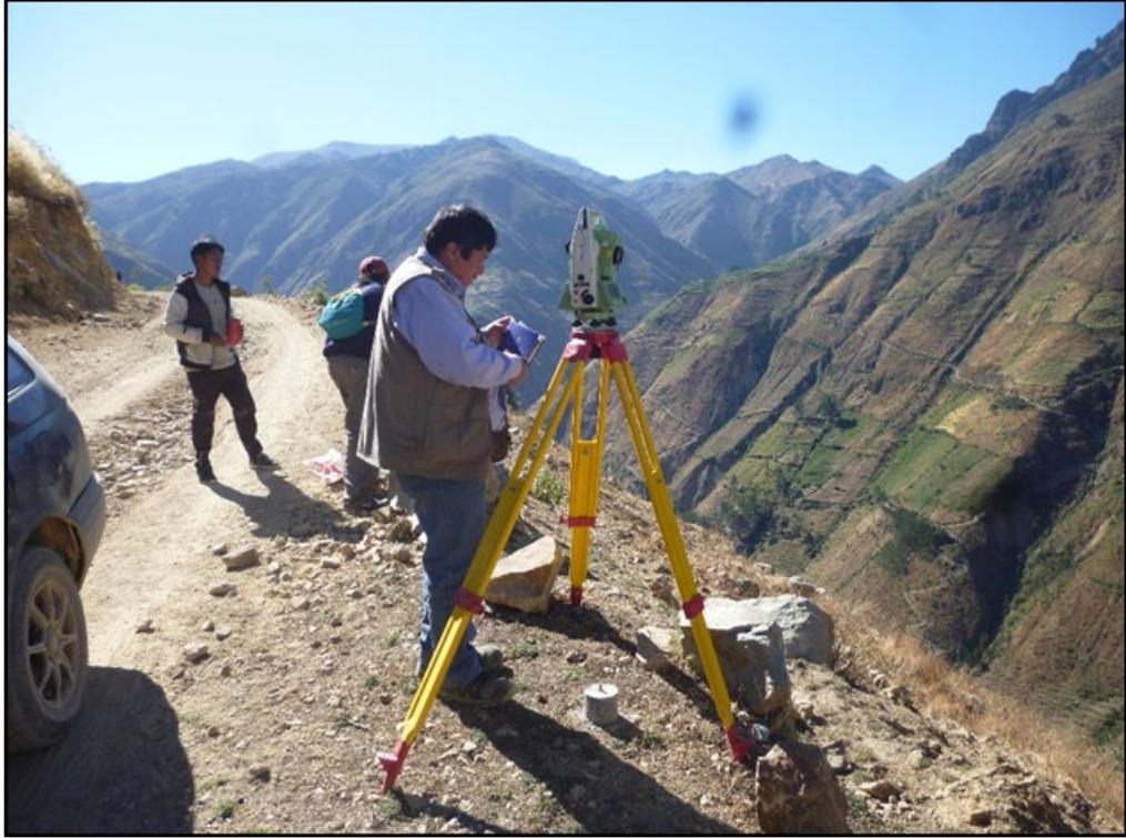
Fotografía 1. Instalación del equipo topográfico para el inicio de levantamiento topográfico.
