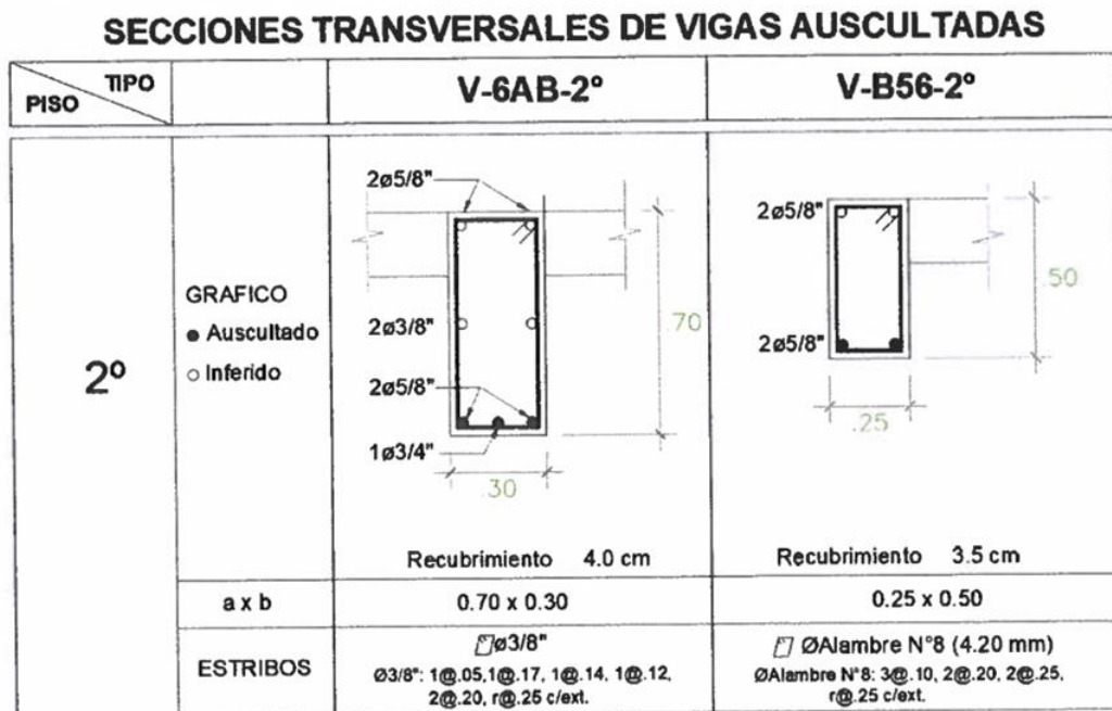
Figura 20 – Secciones transversales de vigas auscultadas – bloque 2, piso 2°.
