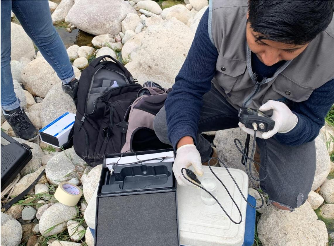
Fotografía 3. Toma de muestra ensayo de conductividad del río Achamayo.
