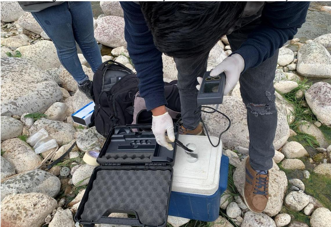
Fotografía 4. Toma de muestra ensayo de demanda bioquímica de oxígeno del río Achamayo.
