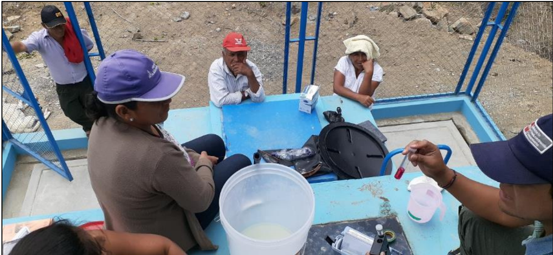
Fotografía 6. Medición de la concentración de cloro residual en reservorio del caserío Landa.
