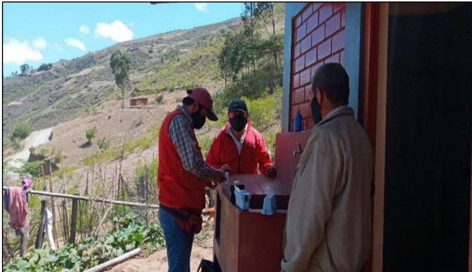
Fotografía 12. Medición de la concentración de cloro residual en la vivienda intermedia del sistema de abastecimiento del caserío Yahuangate.
