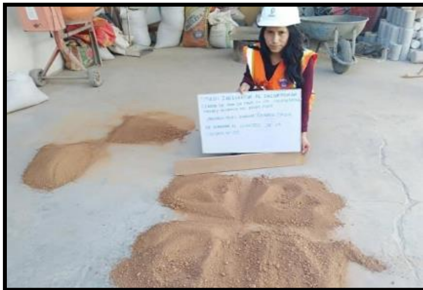
Figura 38 : Cuarteo de la muestra seleccionada para la clasificación del suelo
