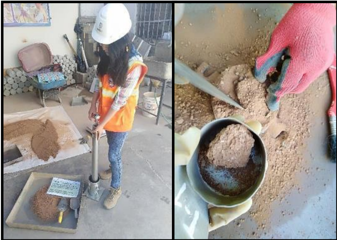
Figura 48 :Elaboración del próctor modificado calculo máxima densidad seca y contenido de humedad óptima.
