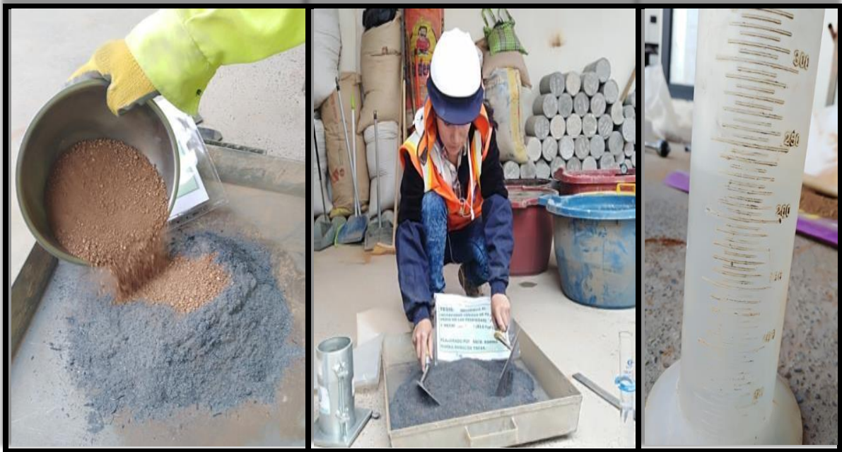
Figura 47 :Elaboración del próctor modificado con la puzolana de ceniza de paja de trigo
