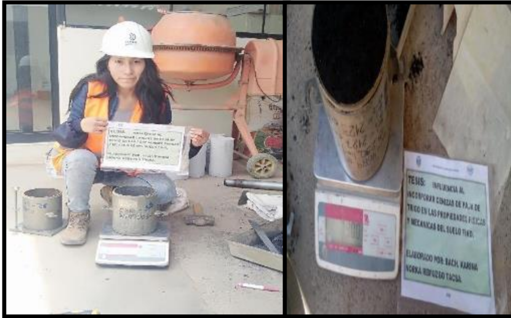
Figura 49 :Elaboración de CBR de la muestra mas porcentaje depuzolana de ceniza de paja de trigo
