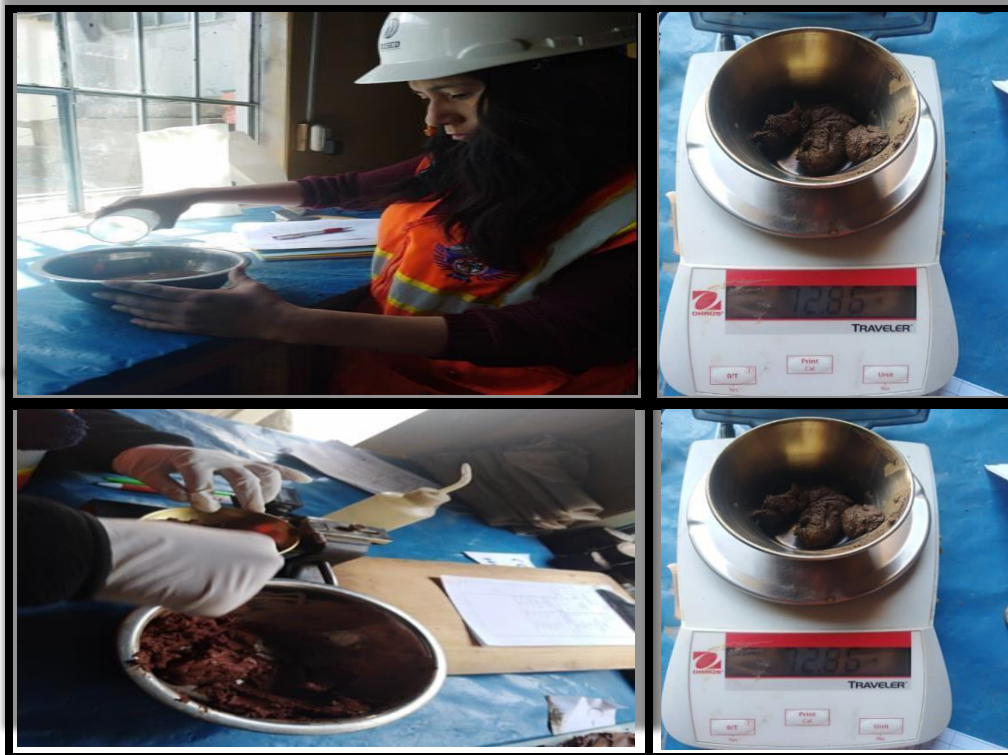
Figura 44 :Elaboración de limite liquido de la muestra más porcentajes de puzolana de ceniza de paja de trigo
