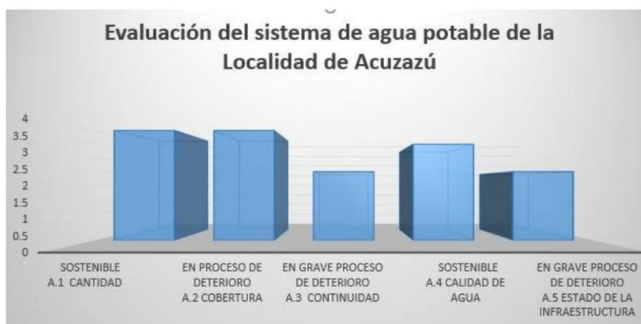
En la figura muestra que entre los aspectos más críticos de la evaluación se encuentra en continuidad con un puntaje de 2.5 que se ubica en el rango en grave proceso de deterioro y en el aspecto del estado de la infraestructura en el rango de grave proceso de deterioro.
