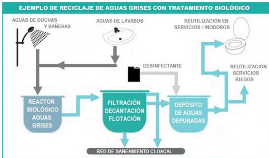
Figura 8. Tratamiento de aguas grises con proceso biológico. Fuente: Eriksson et al. (2002).
