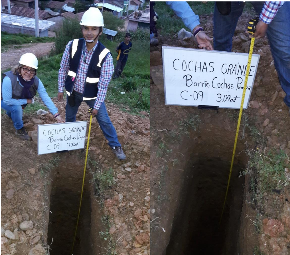
Figura 98. Vista de estratos en la calicata 09.
