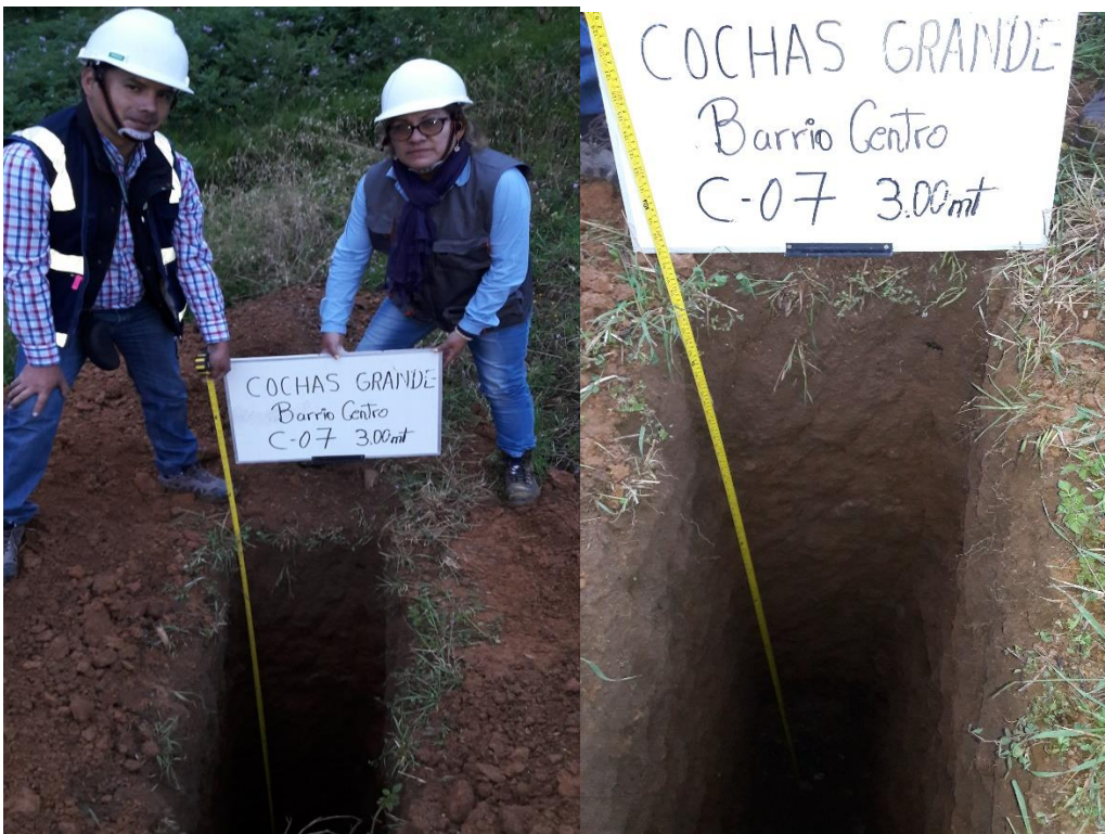
Figura 95. Vista de los estratos de la calicata 07.
