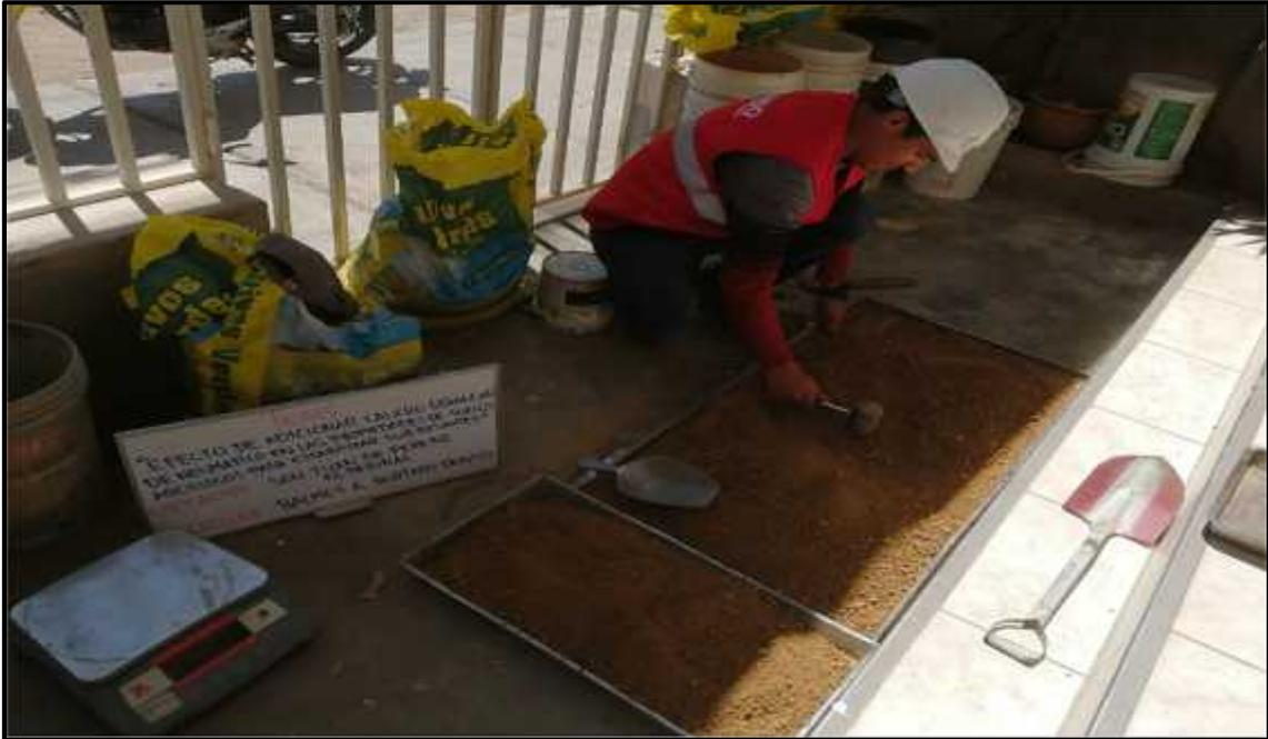
Se observa la preparación del material para el ensayo de CBR.
