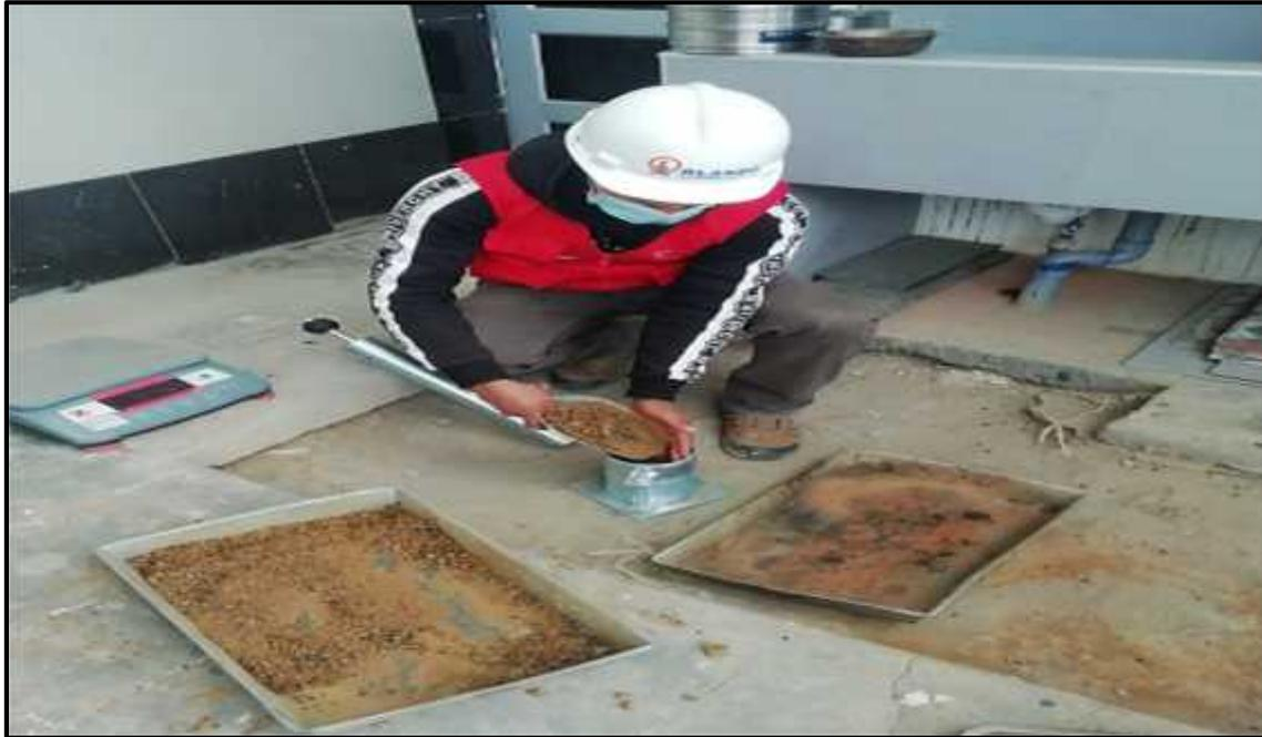
Ensayo de Proctor modificado con la adición de caucho granular de neumático.
