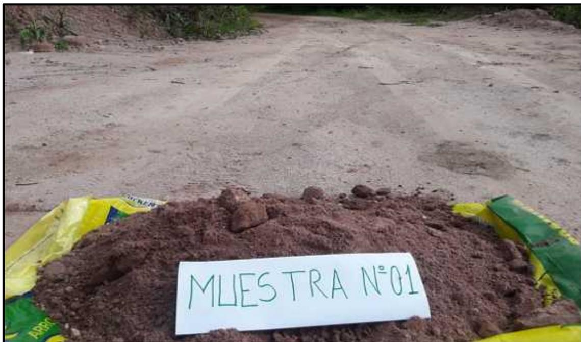
Se visualiza la muestra extraída de la calicata N° 01, se puede observar a simple vista que carece de material gravoso y la abundancia de material arenoso y arcilloso.
