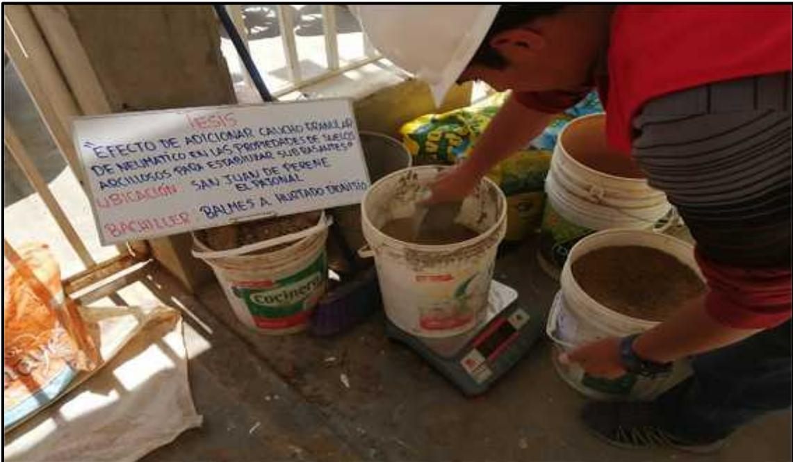
Pesaje de material para el ensayo de CBR.
