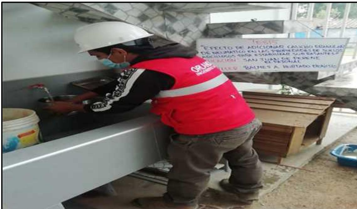
Se observa el lavado de material por la malla N° 200 para el análisis granulométrico.
