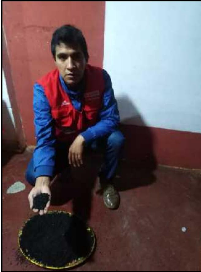
En la foto se observa el caucho granular de neumático utilizado en los ensayos de mecánica de suelos, de dimensiones desde 7 mm a menos incluyendo polvo de caucho.
