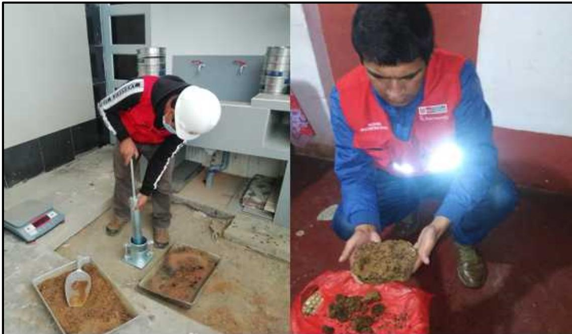
Derecha; Ensayo de Proctor modificado con la adición de caucho granular de neumático.
