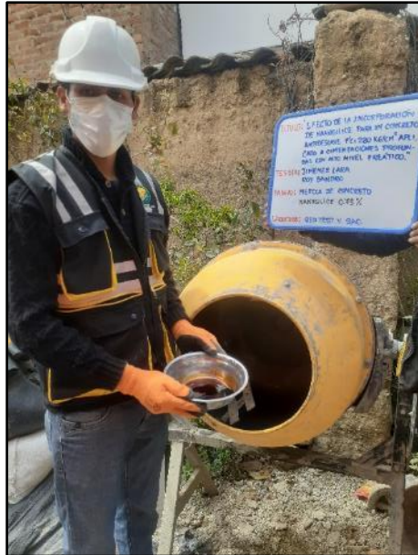
Fotografía N° 33: Vista de materiales tales como el 0.75% de nanosilice para la elaboración del concreto. Según NTP 339.183.
