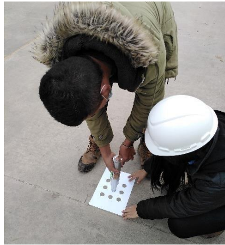
Imagen N° 10. Disparo con esclerometro
