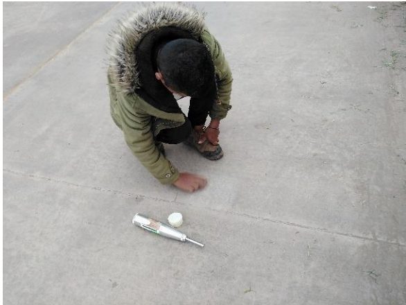
Imagen N° 09. Pulimiento de imperfecciones
