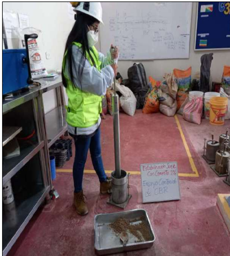
FOTOGRAFIA 32: Ensayo de contenido de CBR
