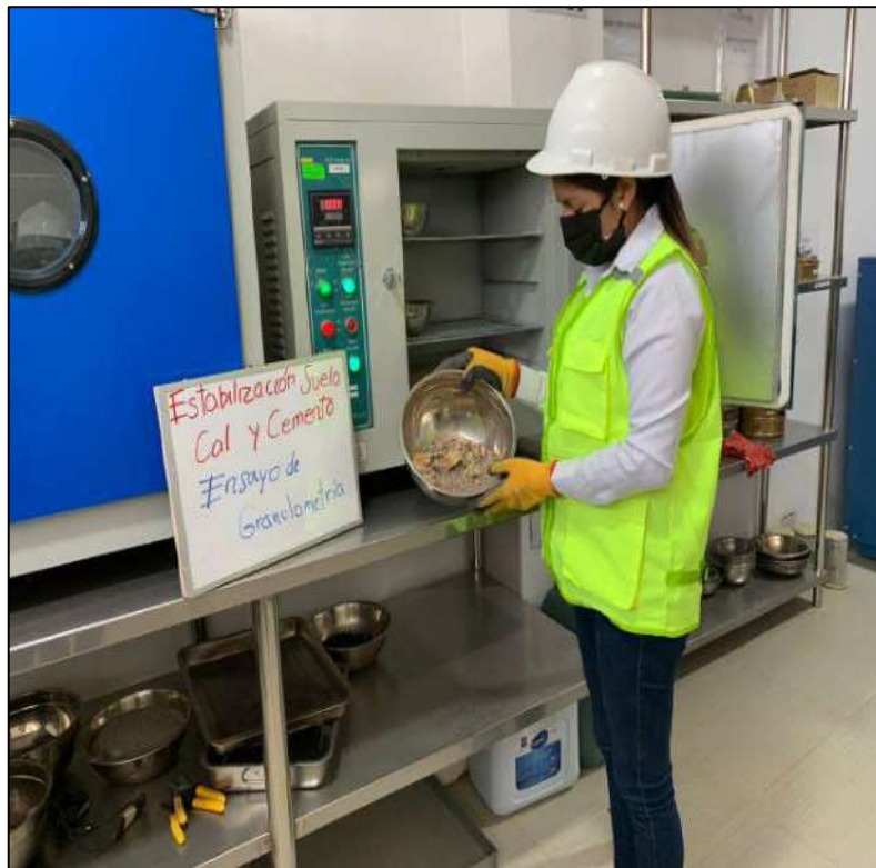
FOTOGRAFIA 12: Procedemos a secar la muestra en el horno.
