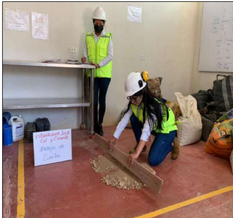
FOTOGRAFIA 1: Se inicia con los trabajos del cuarteo de la muestra.
