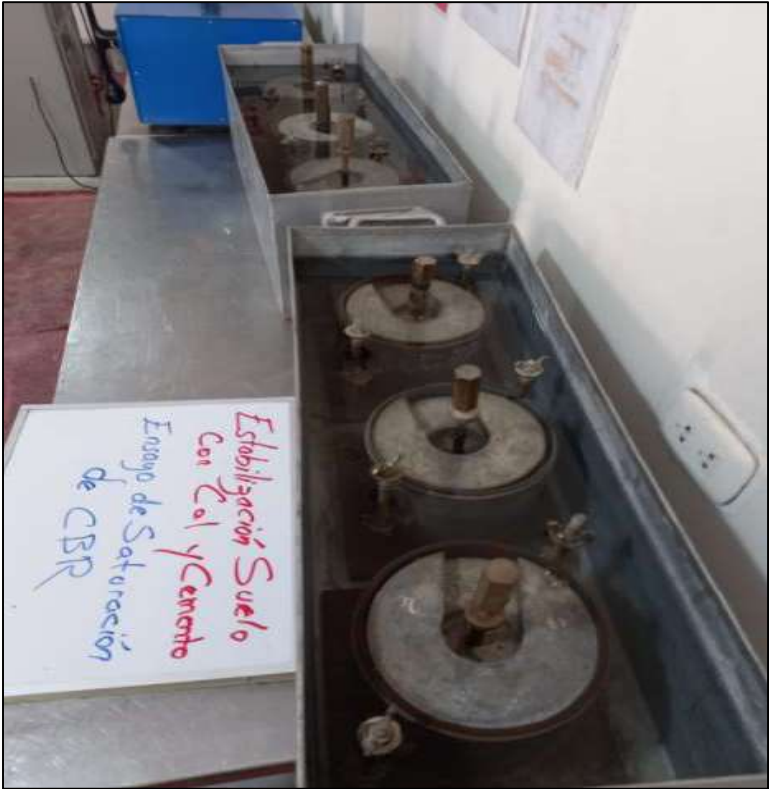
FOTOGRAFIA 33: Se realiza ensayo de saturación de los moldes para determinar el CBR.
