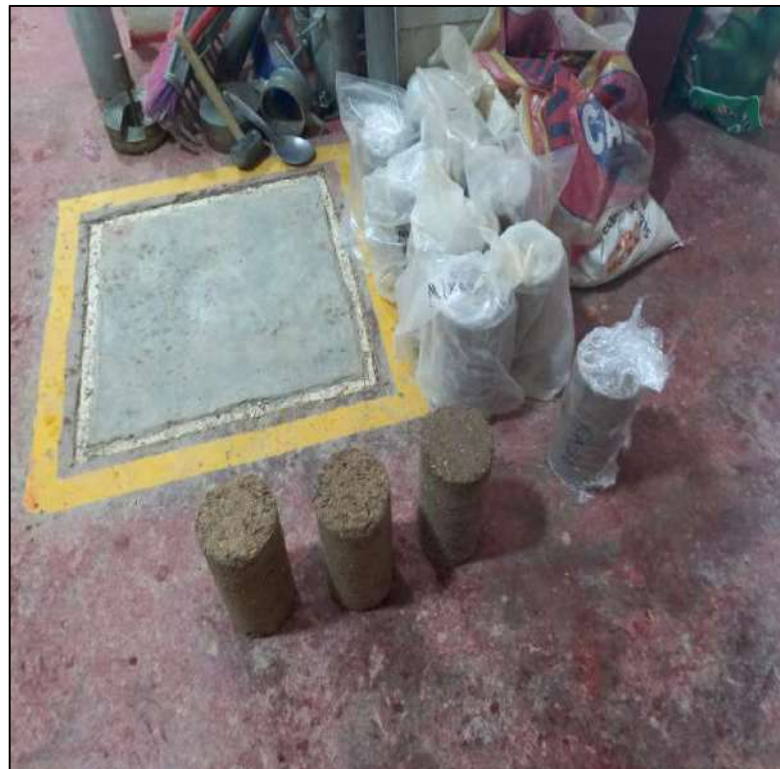
FOTOGRAFIA 46: Culminación del ensayo de Estabilización de suelo con Cal, curado a los 3 y 7 días.
