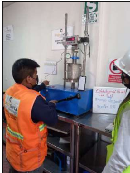
Figura 23. Ensayo de penetración CBR
