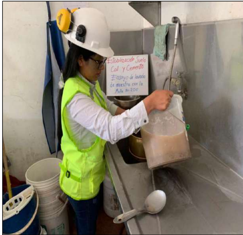
FOTOGRAFIA 9: Lavamos bien la muestra hasta que ésta ya no obtenga residuos orgánicos o similares.
