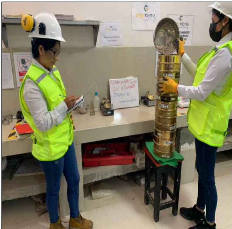
FOTOGRAFIA 14: La muestra seca se deposita en los tamices para realizar el ensayo granulométrico.
