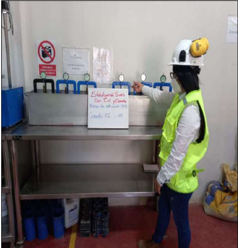
FOTOGRAFIA 34: Sumergimos los moldes con las muestras para el ensayo de saturación de CBR.
