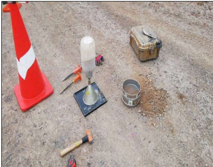
FOTOGRAFIA 60: Vaciado de la arena calibrada en la progresiva 131+750
