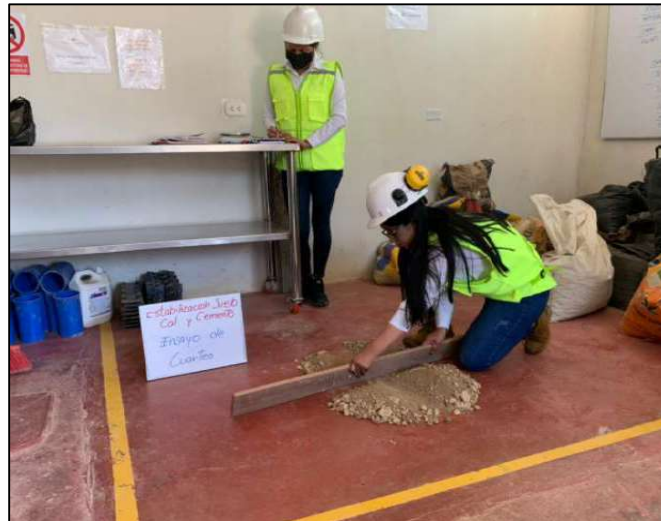
Figura 15. Cuarteo para determinar la granulometría del suelo
