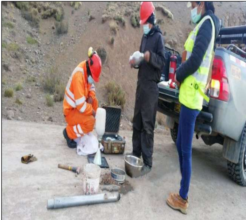
FOTOGRAFIA 49: Determinación de la humedad con el equipo de Speedy en la progresiva 128+500
