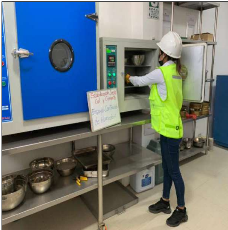
FOTOGRAFIA 6: Se realiza el ensayo de contenido de humedad, la muestra obtenida es ingresada en el horno para el secado correspondiente.
