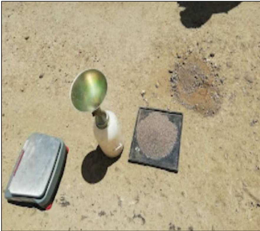
FOTOGRAFIA 63: Vaciado de la arena calibrada en la progresiva 132+500.
