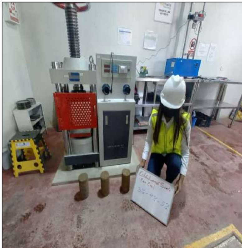
FOTOGRAFIA 44: Estabilización de suelo con Cal al 3% - 4% y 5%.
