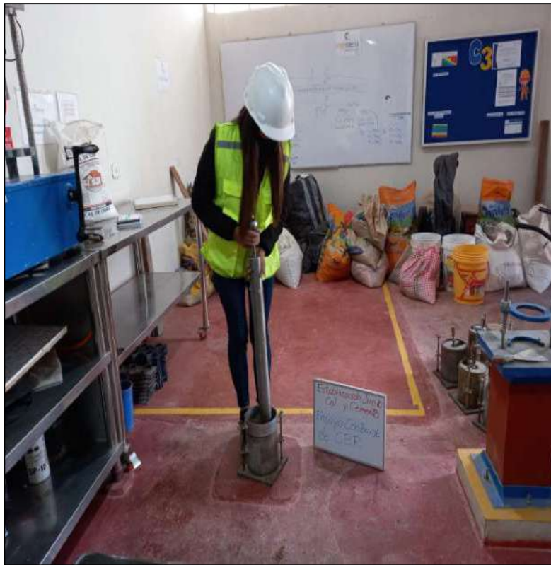
FOTOGRAFIA 29: Compactamos la muestra en el siguiente molde, (Ensayo Proctor).
