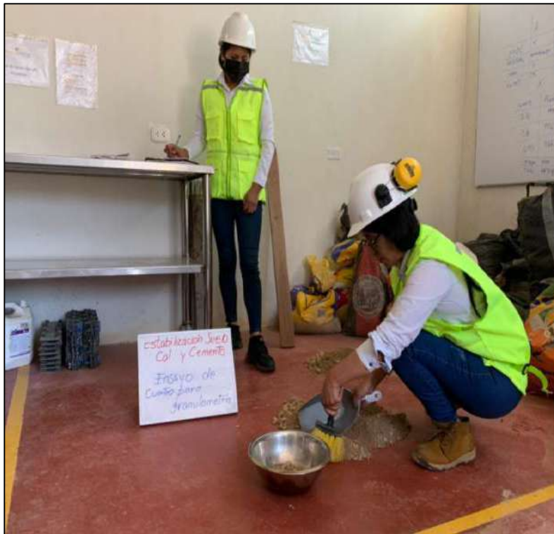
FOTOGRAFIA 3: Se realiza el recojo de la muestra seleccionada inmediatamente después del cuarteo.
