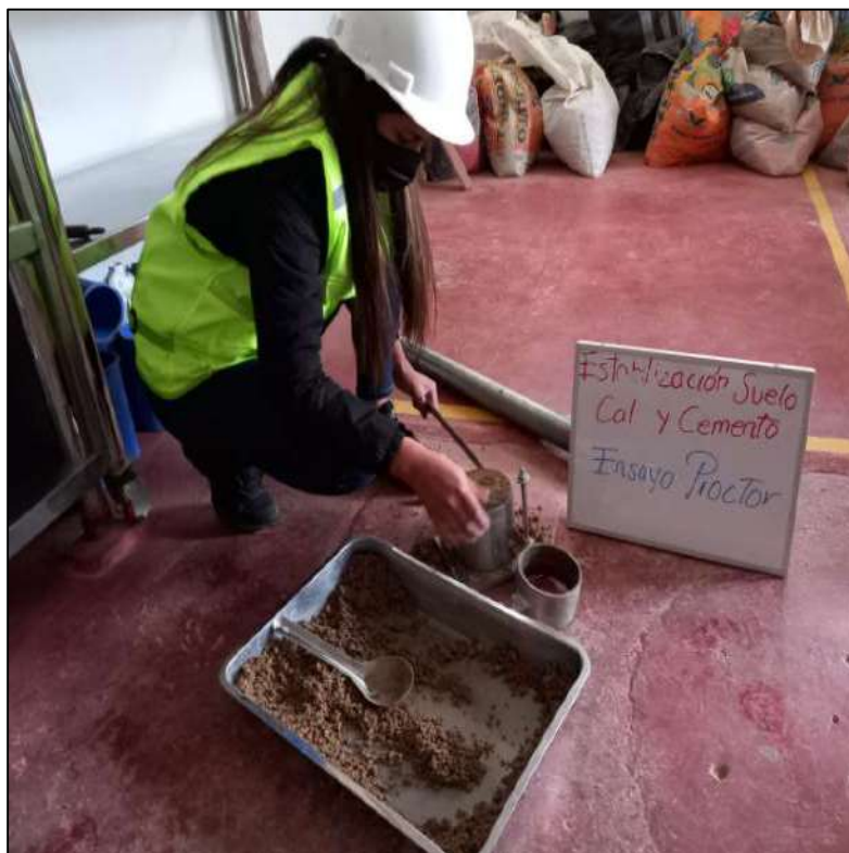
FOTOGRAFIA 28: Abrimos el molde para sacar la muestra.
