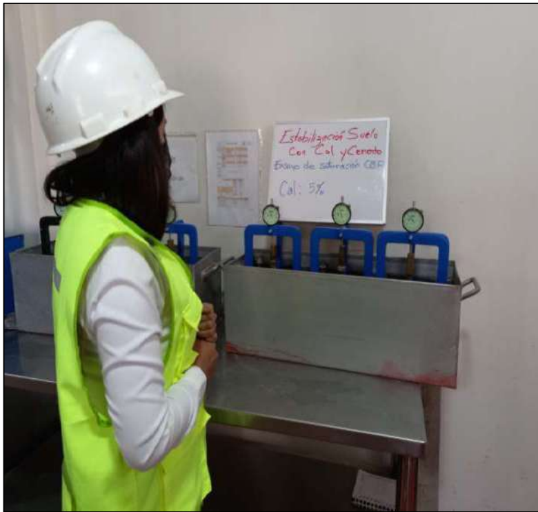
FOTOGRAFIA 35: Ensayo de saturación con Cemento al 2 – 3%.
