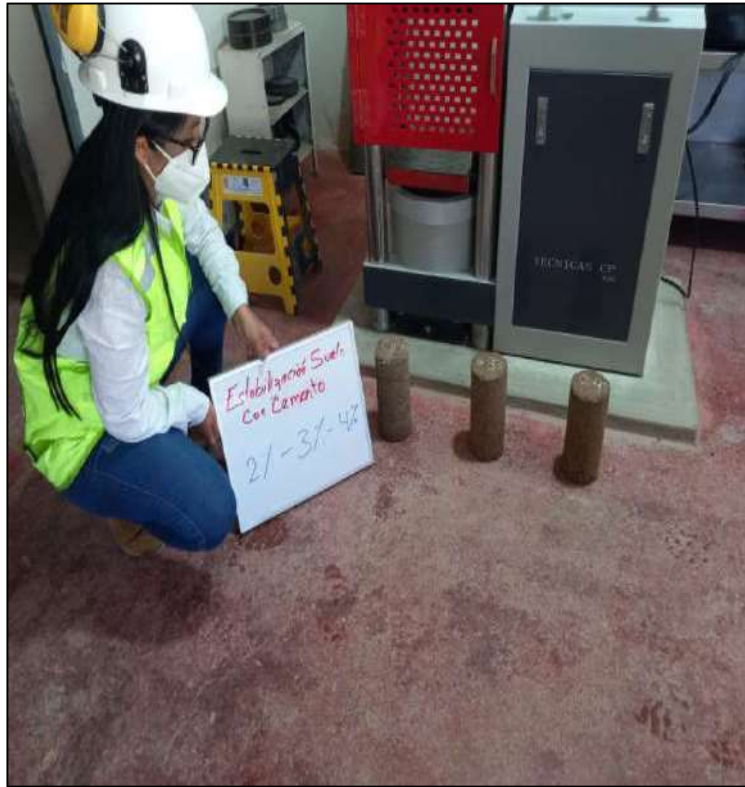
FOTOGRAFIA 45: Estabilización de suelo con Cal al 2% - 3% y 4%.
