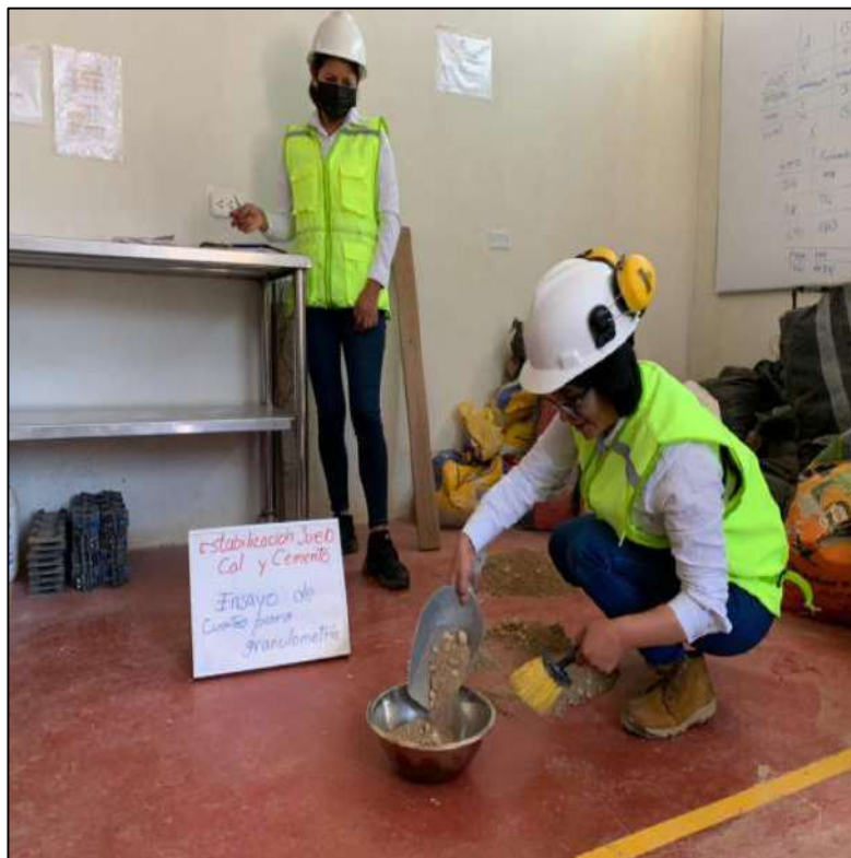
FOTOGRAFIA 4: La muestra seleccionada se agrega a la tara designada.
