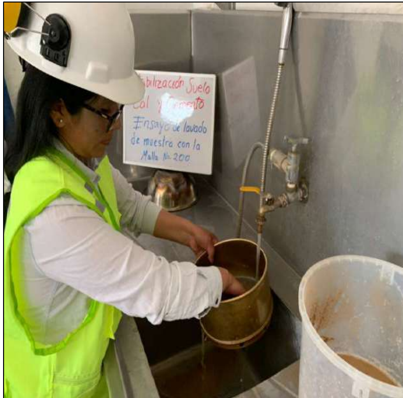
FOTOGRAFIA 11: Lavamos con cuidado y pasamos la muestra por el tamiz de malla N°200.
