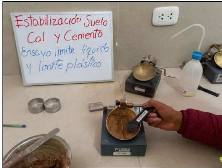
Figura 18. Ensayo de limite liquido
