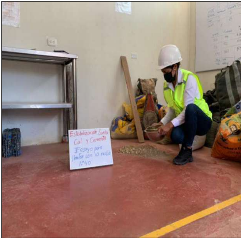
FOTOGRAFIA 5: Se inicia a tamizar la muestra por la malla N°40 para así realizar después, el ensayo de límites.
