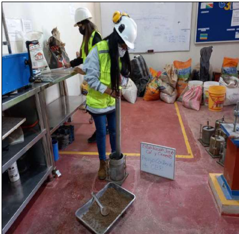
FOTOGRAFIA 31: Compactación para ensayo de CBR.
