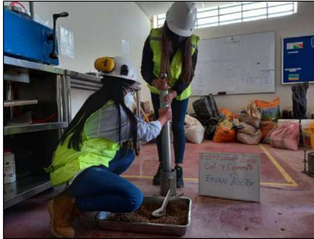
Figura 20. Ensayo de Proctor Modificado
