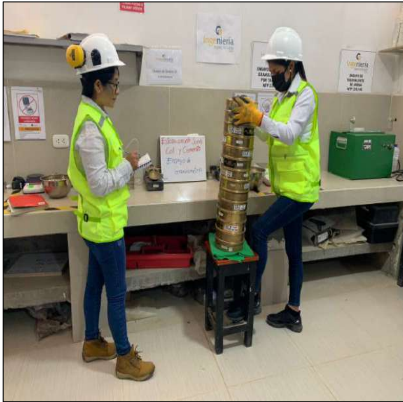
FOTOGRAFIA 15: Se realiza el tamizado de la muestra.
