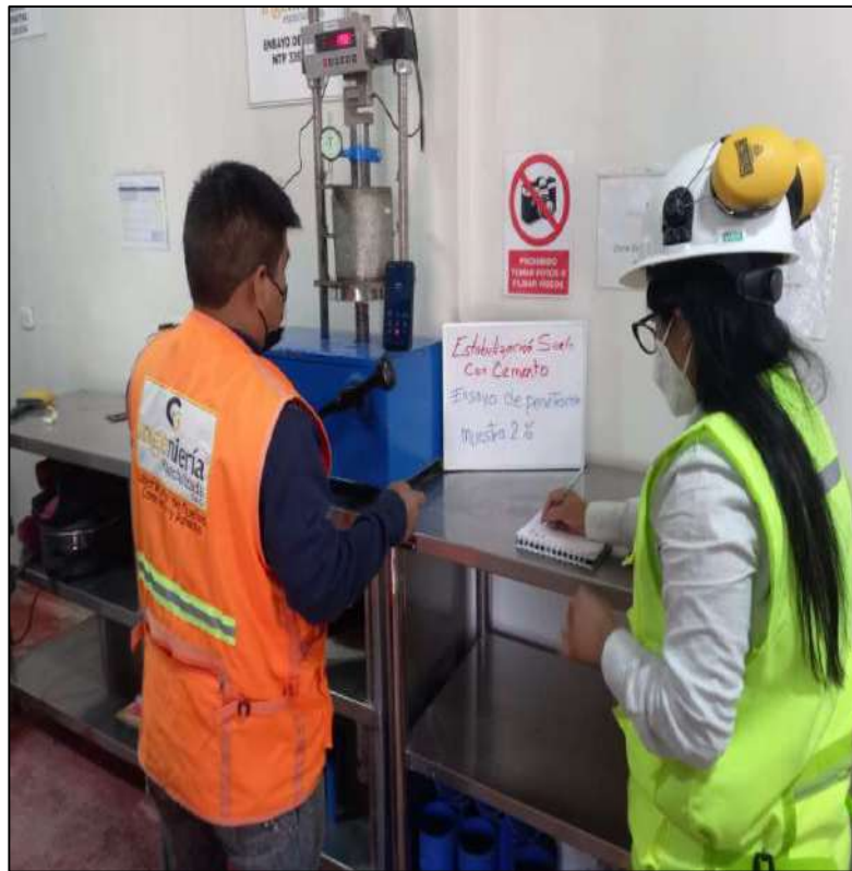
FOTOGRAFIA 41: Ensayo de penetración de la muestra al 2% de cemento.
