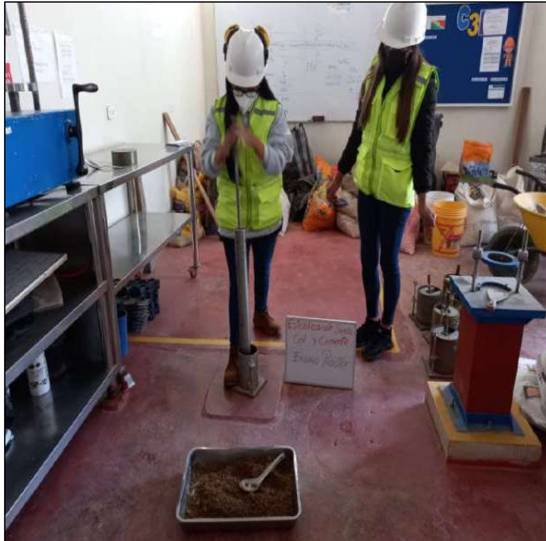
FOTOGRAFIA 25: Se realiza la compactación de la muestra.
