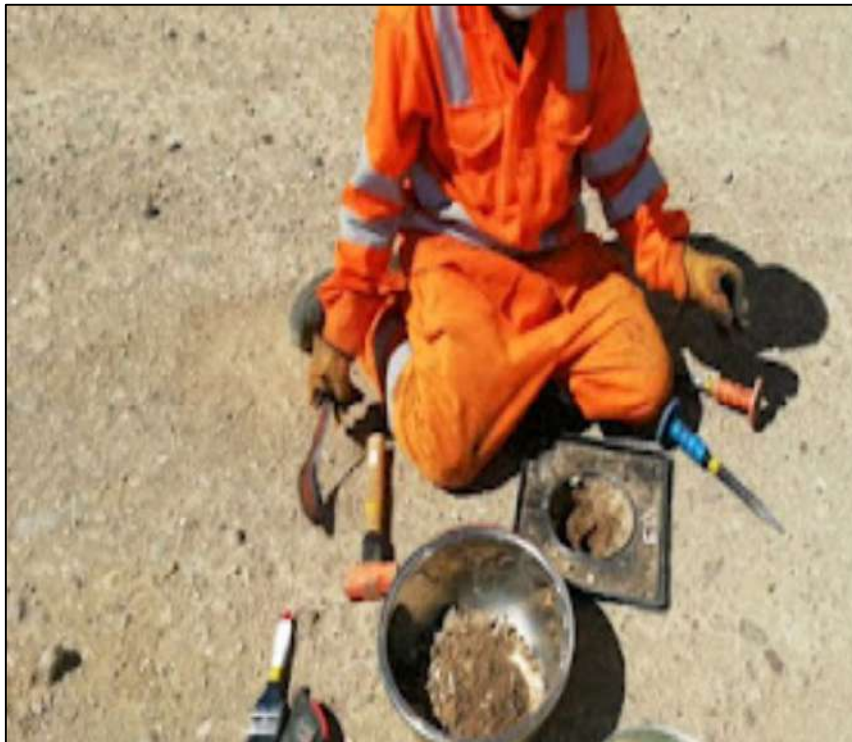
FOTOGRAFIA 68: Extracción del suelo en la progresiva 133+750
