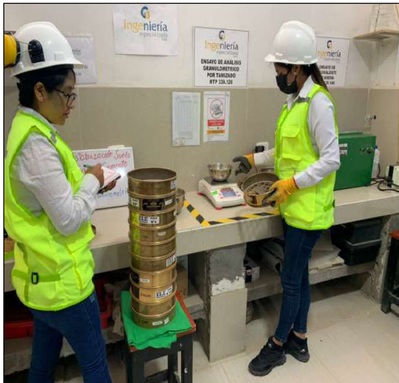
FOTOGRAFIA 17: Pesamos el material retenido por cada malla.
