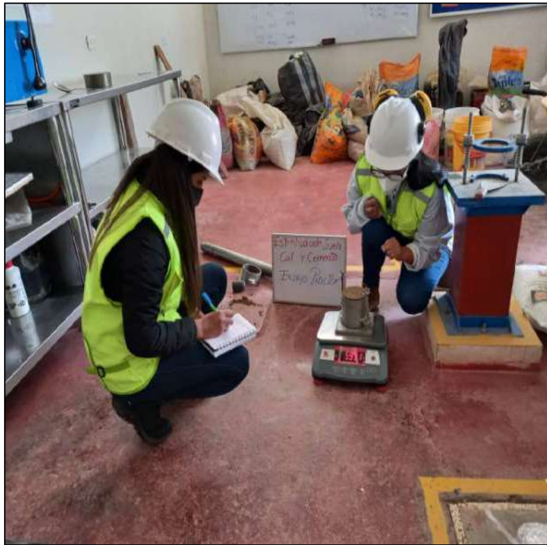
FOTOGRAFIA 27: Pesamos la muestra compactada con todo y el molde.
