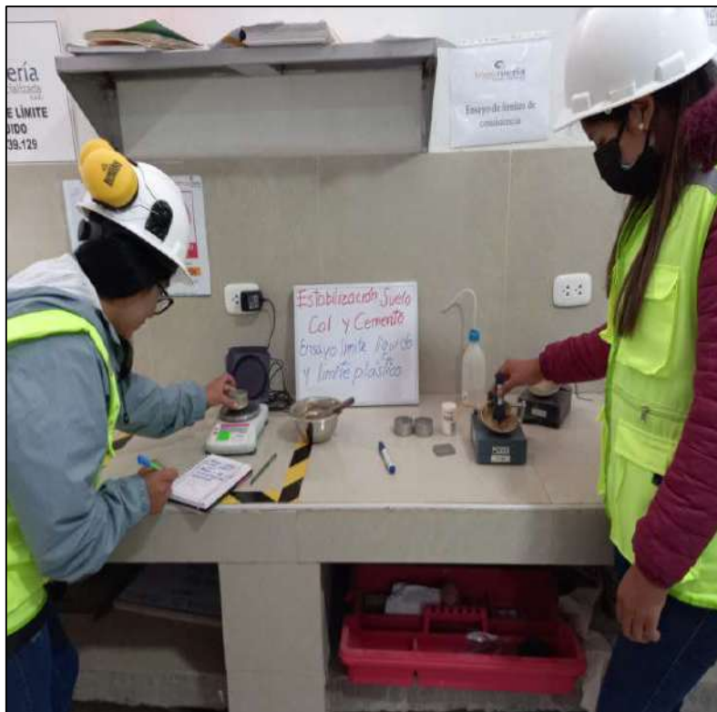
FOTOGRAFIA 20: Usamos la copa de Casagrande para el ensayo de límite líquido.
