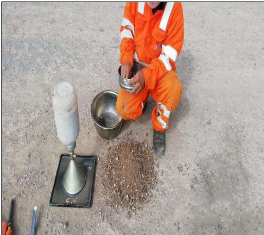
FOTOGRAFIA 50: Tamizado del suelo extraído por la malla \frac{3}{4} en la progresiva 128+750
