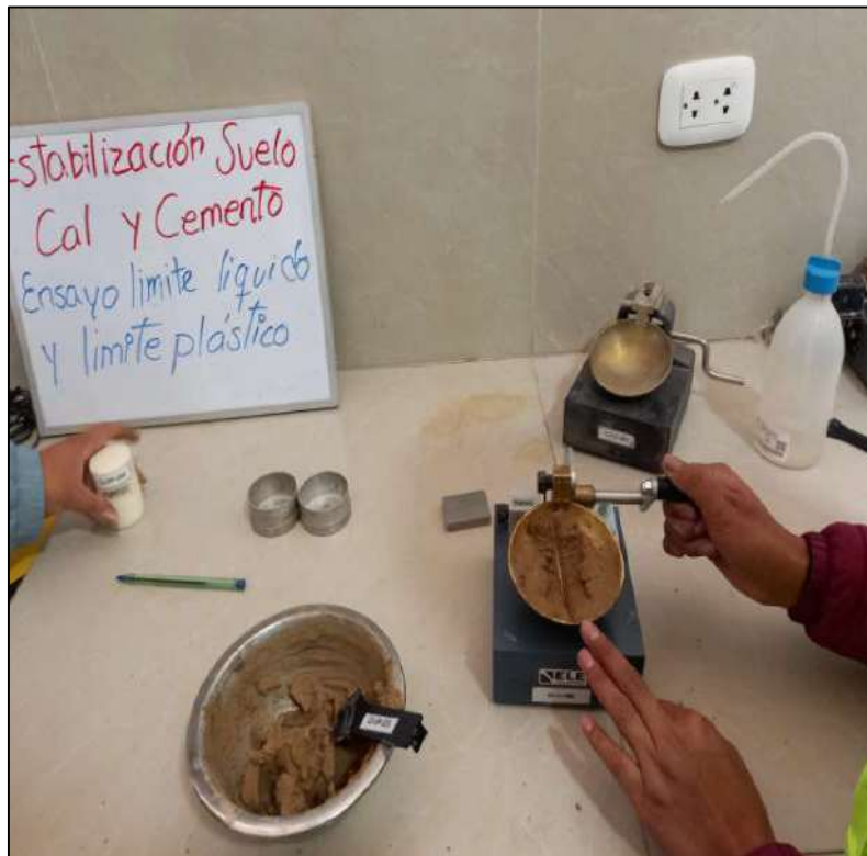
FOTOGRAFIA 22: Cortamos y sacamos la muestra en las pequeñas taras para llevar al horno y secar.
