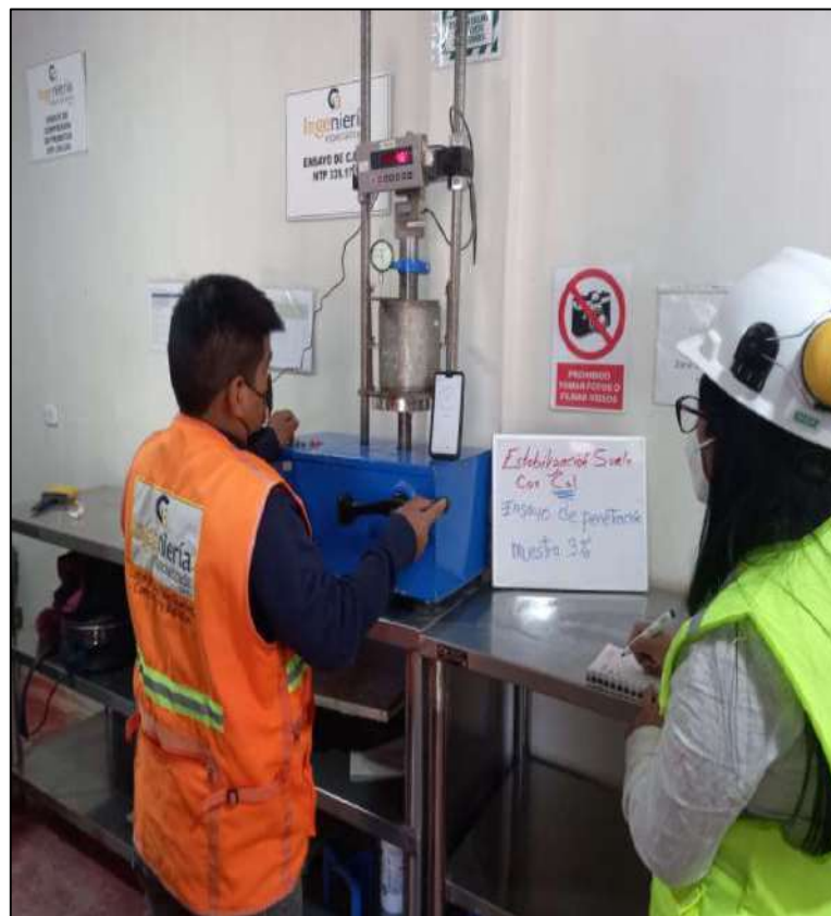
FOTOGRAFIA 38: Ensayo de penetración de la muestra al 3% de cal
