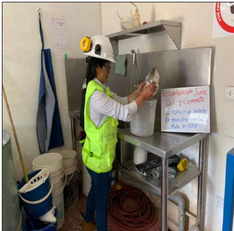
FOTOGRAFIA 8: Se realiza el lavado de la muestra obtenida para el ensayo.
