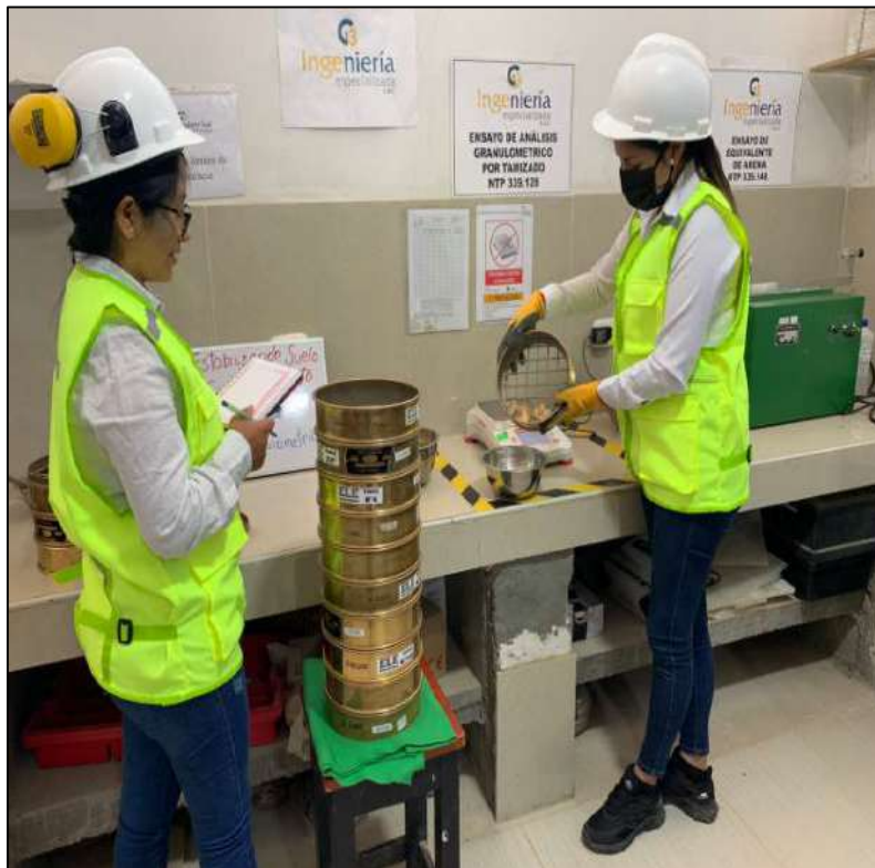
FOTOGRAFIA 16: Sacamos las muestras retenidas por las mallas.
