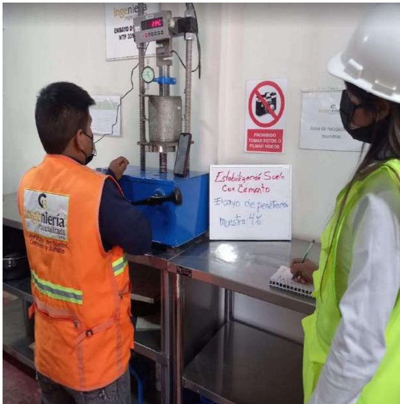
FOTOGRAFIA 43: Ensayo de penetración de la muestra al 4% de cemento.
