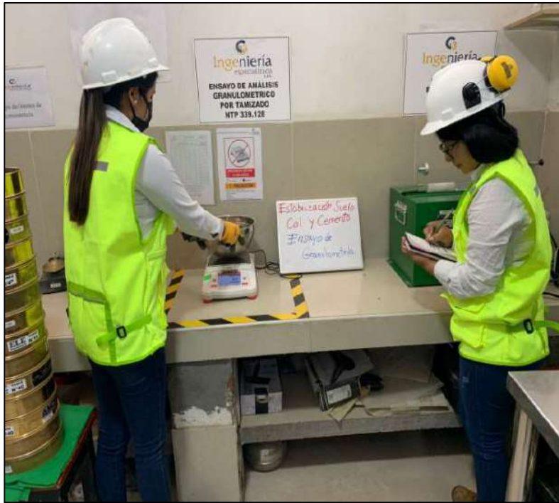
FOTOGRAFIA 13: Dejamos enfriar la muestra y pasamos a pesar.
