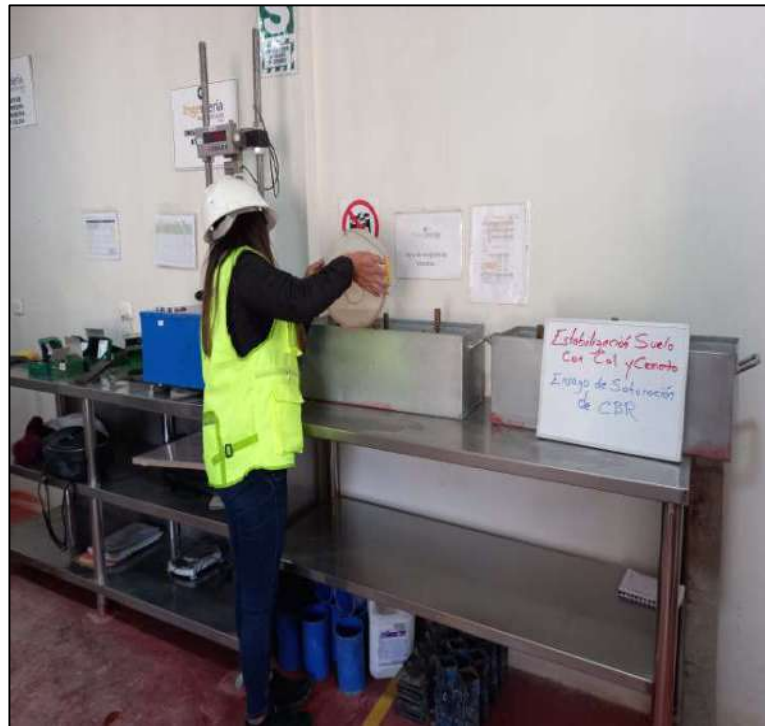
FOTOGRAFIA 37: Ensayo de saturación – Cal 5%
