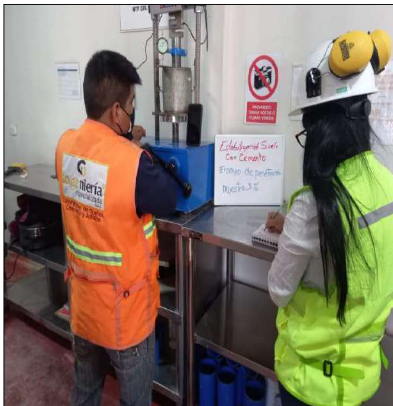
FOTOGRAFIA 42: Ensayo de penetración de la muestra al 3% de cemento.
