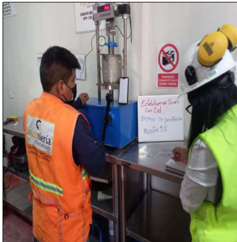
FOTOGRAFIA 40: Ensayo de penetración de la muestra al 5% de cal
