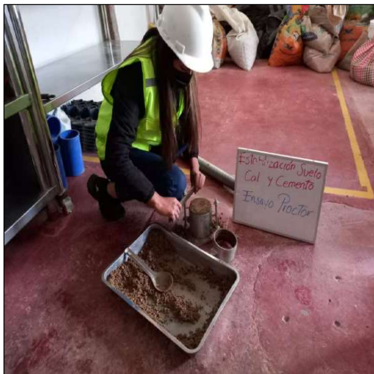
FOTOGRAFIA 26: Con una regla sacamos el material sobrante del molde
