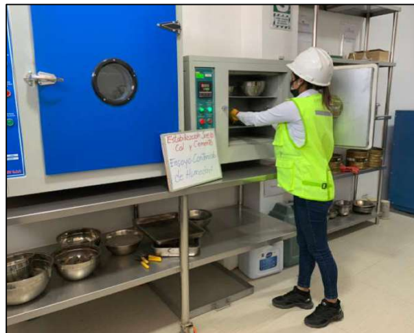
Figura 14. Secado de la muestra a temperatura de 110^{\circ}\text{C}
