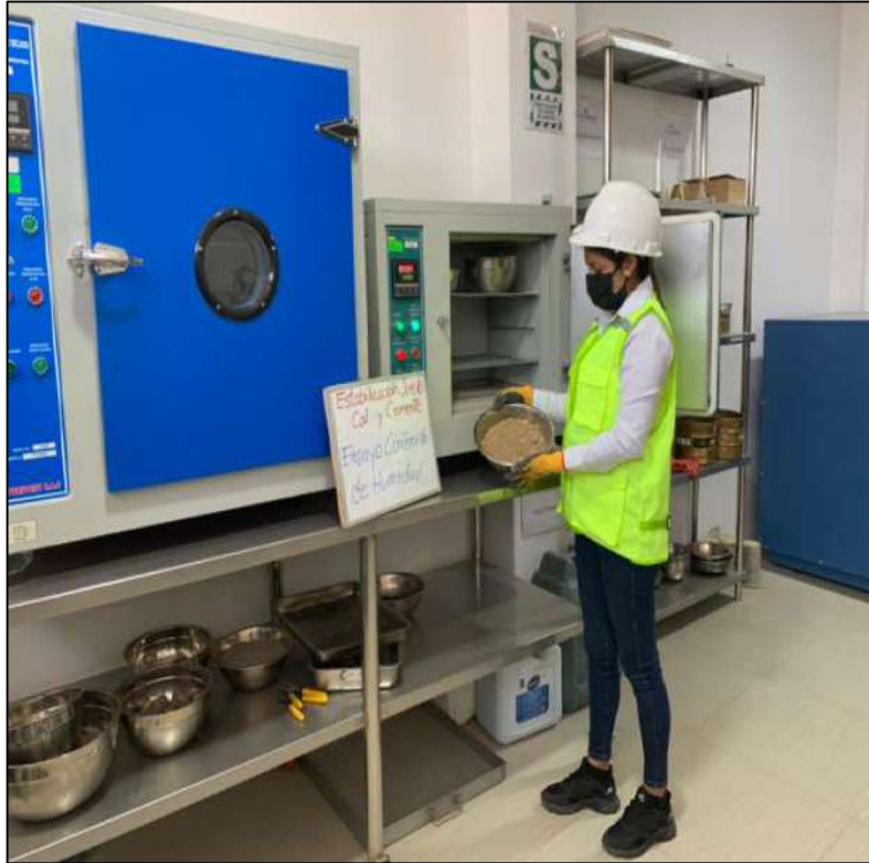
FOTOGRAFIA 7: Luego retiramos la muestra del horno utilizando los guantes de protección.
