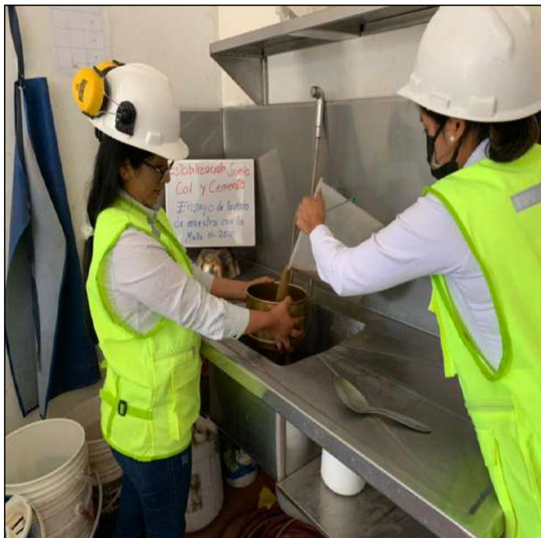
FOTOGRAFIA 10: Se realiza el lavado la muestra y colocando en el tamiz para poder seleccionar el material.
