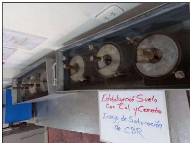
Figura 22. Ensayo de saturación CBR
