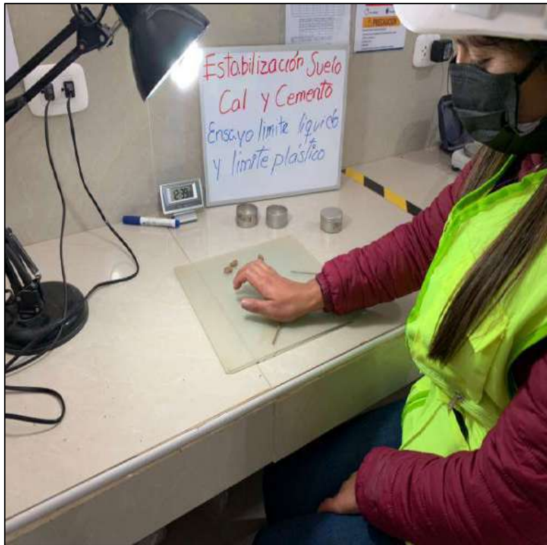
FOTOGRAFIA 19: Se realiza el ensayo de límite plástico.
