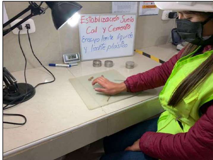
Figura 19. Ensayo de limite plástico
