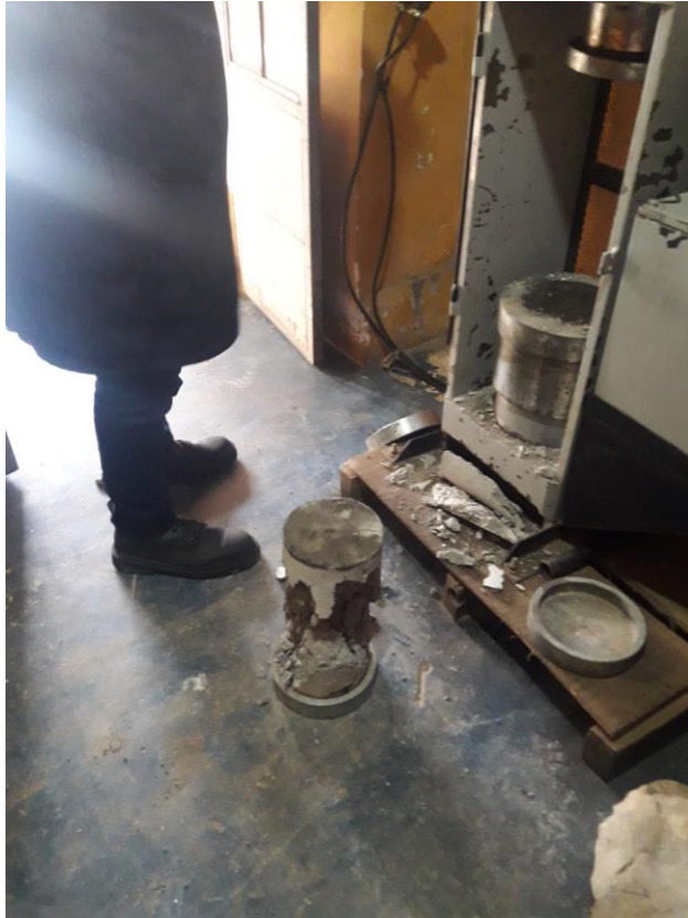
Fotografía 26. Vista del concreto patrón roturado a los 7 días.
