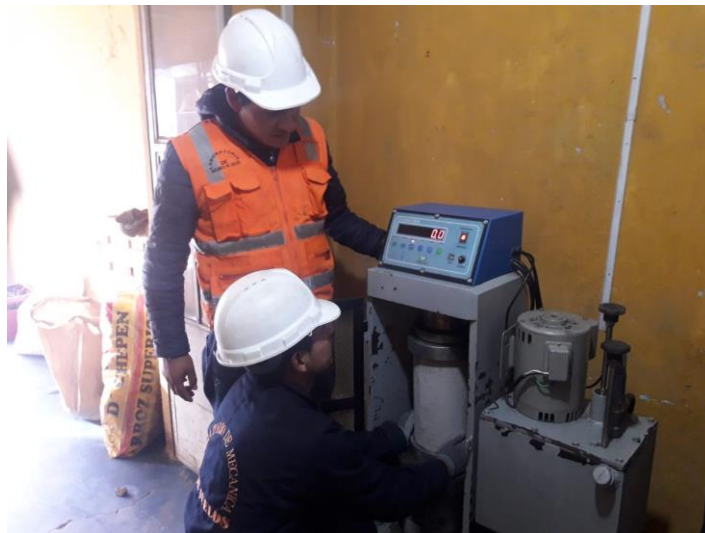
Fotografía 14. Colocación de las probetas con sikatop y aguas ácidas a los 7 días para su rotura.
