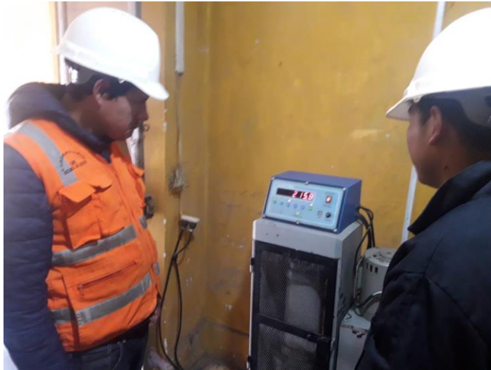
Fotografía 4. Vista de la rotura del concreto patrón a los 14 días.
