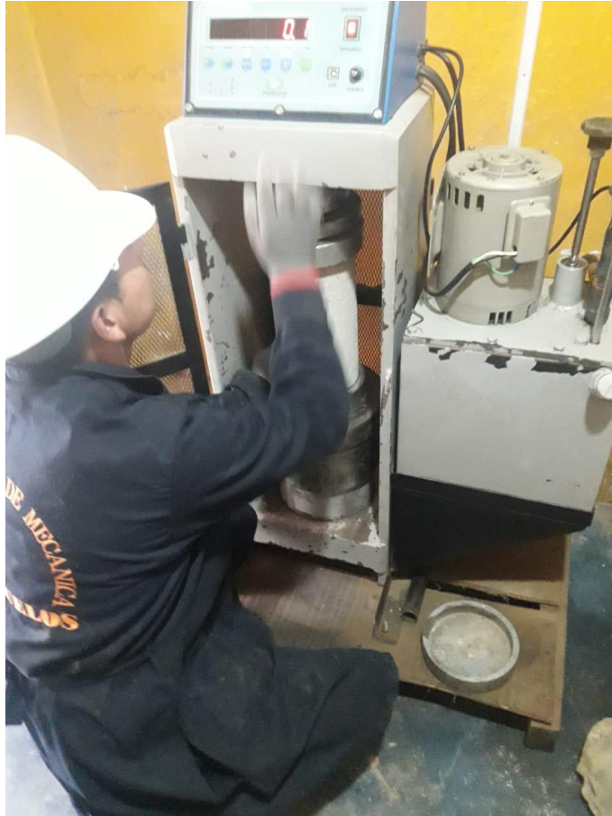
Fotografía 19. Control del concreto patrón a los 21 días.
