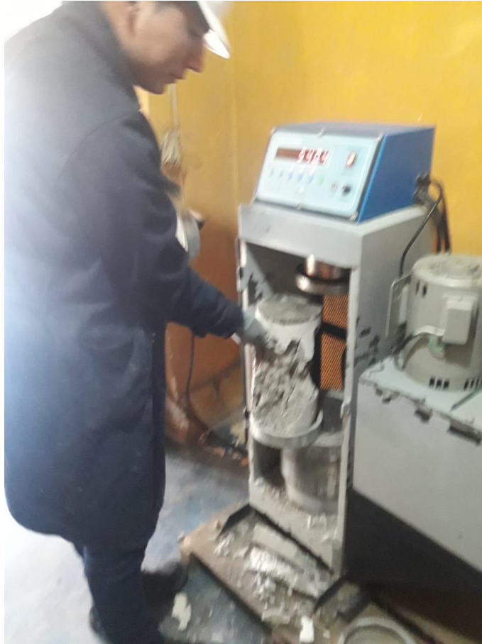
Fotografía 30. Probeta de concreto sin sikatop y aguas ácidas roturada a los 14 días.
