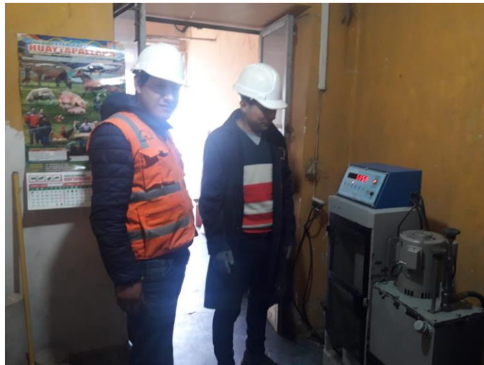
Fotografía 20. Control del ensayo de rotura del concreto con sikatop y aguas ácidas a los 21 días.
