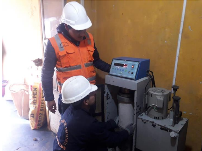
Fotografía 13. Colocación de las probetas patrón a los 7 días antes del ensayo.
