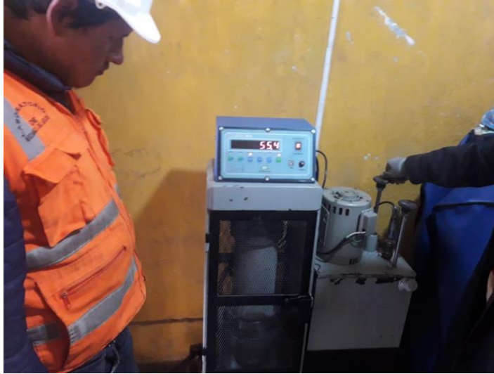
Fotografía 16. Control de la rotura de concreto patrón a los 14 días.
