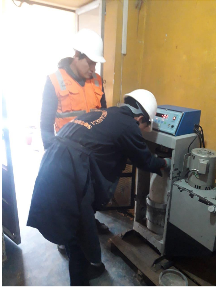
Fotografía 8. Vista de la rotura del concreto con sikatop y aguas ácidas a los 21 días.
