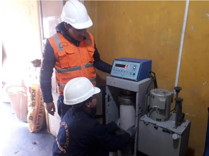
Fotografía 10. Vista de la rotura del concreto patrón a los 28 días.
