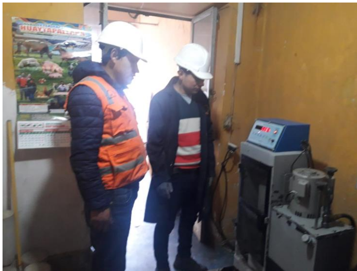
Fotografía 17. Control de la rotura de concreto con sikatop y aguas ácidas a los 14 días
