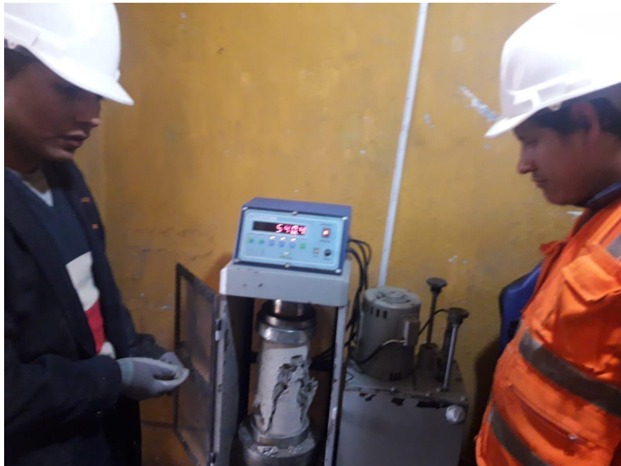
Fotografía 31. Vista de la forma de rotura de la probeta del concreto patrón.
