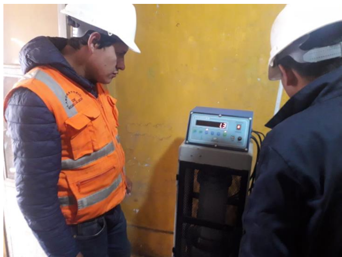
Fotografía 15. Control del ensayo de rotura de las probetas de concreto sin sikatop y aguas ácidas a los 7 días.
