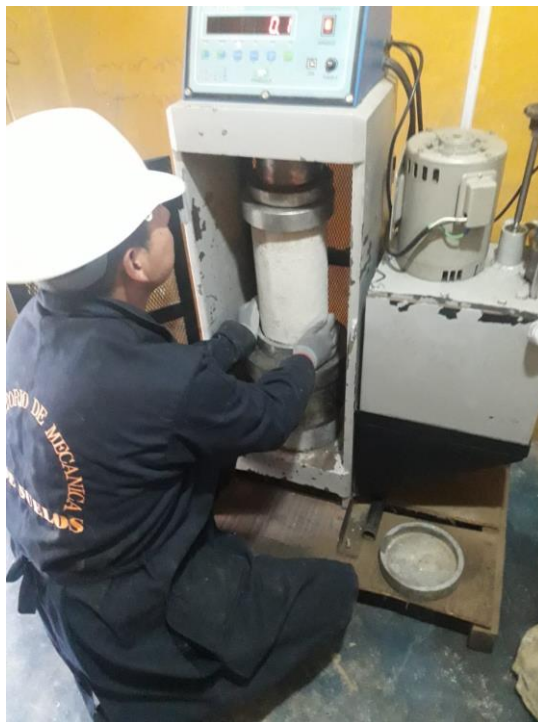
Fotografía 29. Vista de probeta de concreto con sikatop y agua ácidas antes de ser roturadas a los 14 días.
