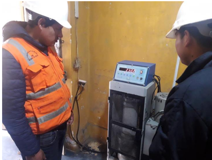
Fotografía 11. Rotura de la probeta del concreto con sikatop y aguas ácidas a los 28 días.
