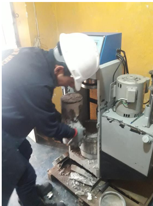
Fotografía 27. Rotura del concreto con sikatop y aguas ácidas a los 7 días.
