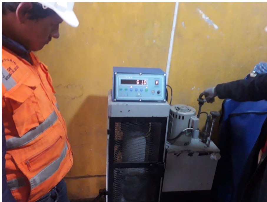
Fotografía 2. Vista del concreto con sikatop y aguas acidas a los 7 días.
