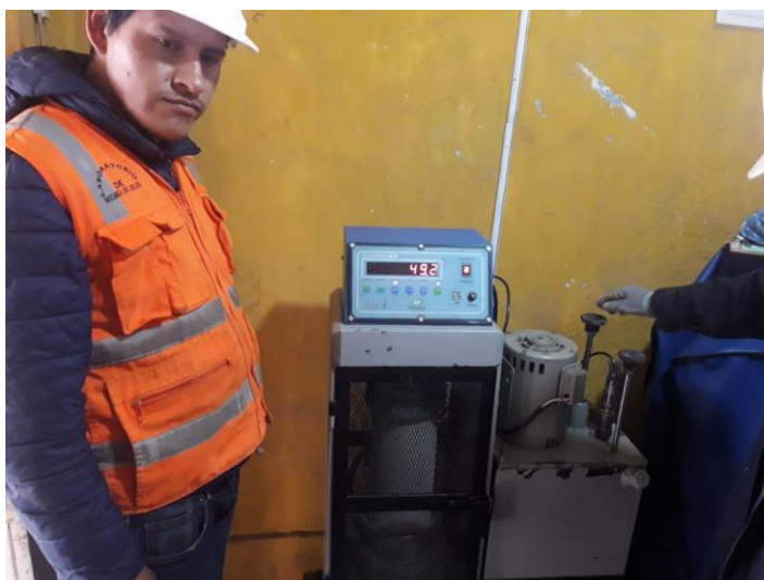
Fotografía 5. Vista de rotura del concreto con sikatop y aguas ácidas a los 14 días.
