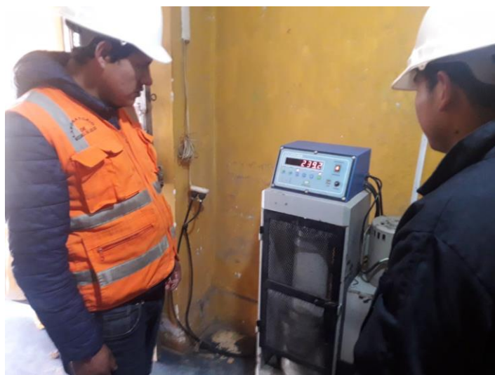
Fotografía 12. Vista de la rotura del concreto a los sin sikatop y aguas ácidas a los 28 días.
