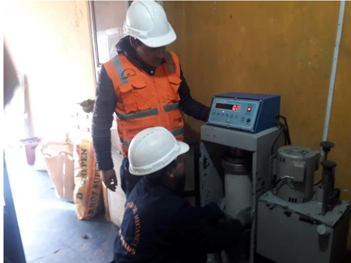
Fotografía 21. Control del ensayo de rotura de concreto sin sikatop y aguas ácidas a los 21 días.
