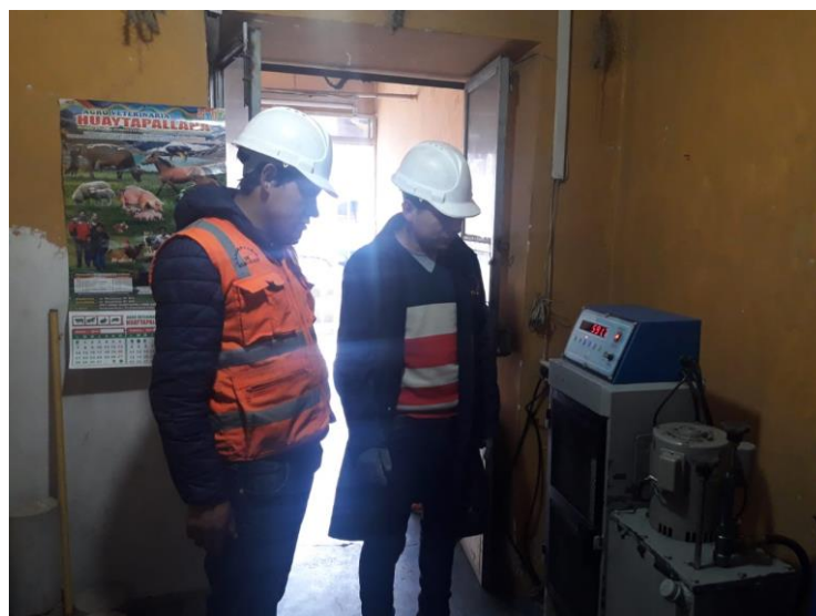
Fotografía 23. Control del ensayo de rotura del concreto con sikatop y aguas ácidas a los 28 días.
