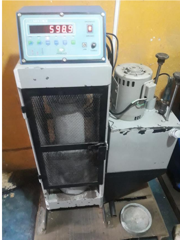
Fotografía 24. Control de rotura del concreto sin sikatop y aguas ácidas a los 28 días.
