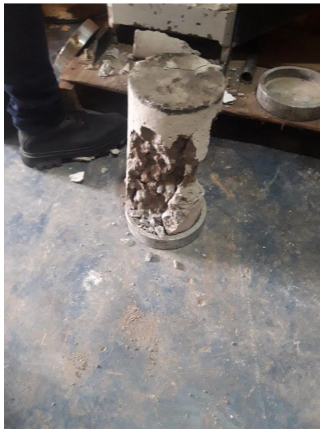
Fotografía 25. Vista de la probeta roturada de concreto sin sikatop y aguas ácidas a los 7 días.
