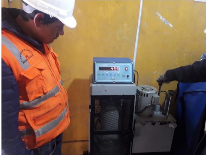
Fotografía 3. Vista del ensayo de rotura de la probeta sin sikatop con aguas acidas a los 7 días.
