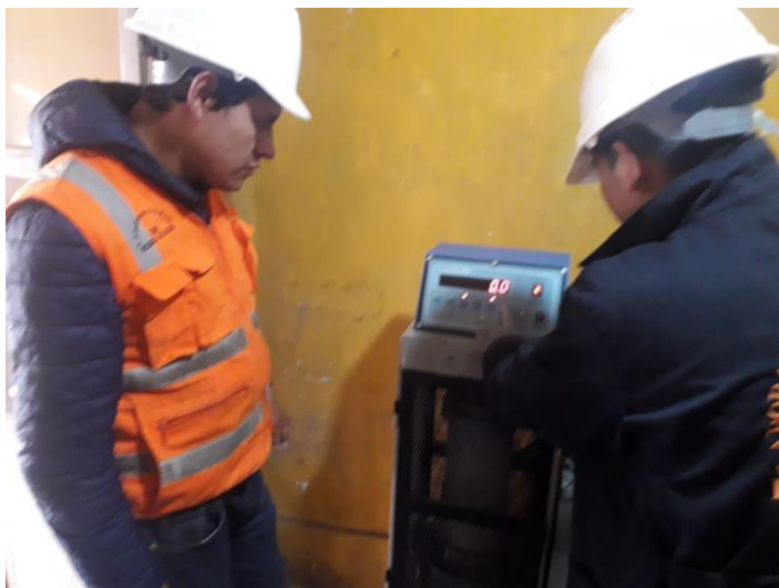
Fotografía 18. Control de la rotura de concreto sin sikatop y aguas ácidas a los 14 días.
