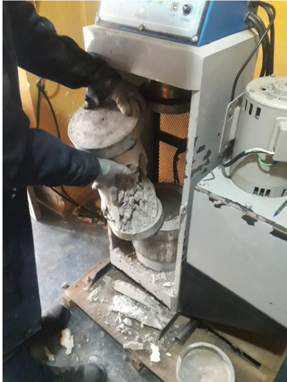
Fotografía 32. Vista de la rotura de probetas del concreto sin sikatop y aguas ácidas a los 28 días.
