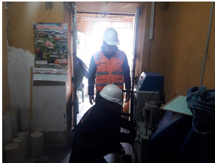
Fotografía 22. Control del ensayo de rotura del concreto patrón a los 28 días.
