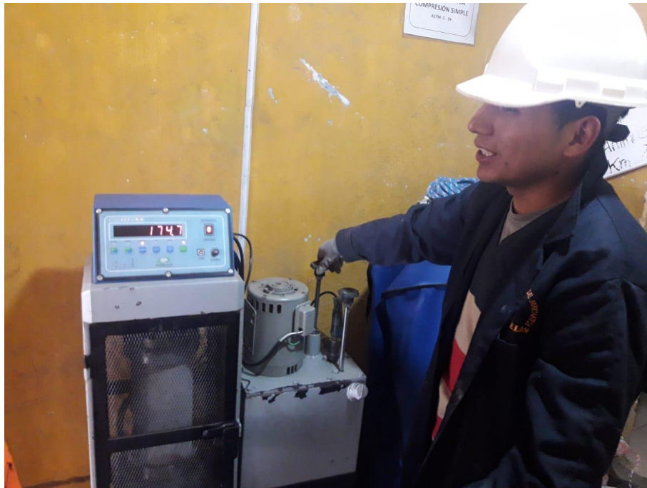
Fotografía 1 Vista de la rotura de concreto patrón a los 7 días
